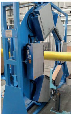
3-achsiges ODAC® 550 Messsystem für Ø bis zu 500 mm
