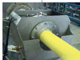
UMAC® Scanner mit 8 Messpunkten für Ø bis zu 690 mm (größer auf Anfrage)
