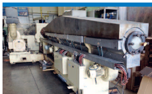
150 mm Extruder mit Seitenbeschickung Optional: Wasserring-Granulierung, etc.
