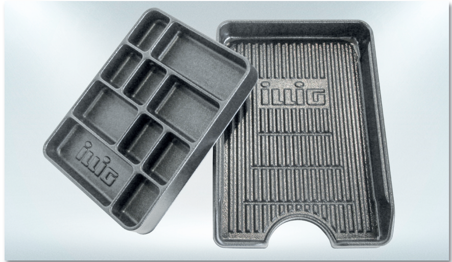
Thermogeformte Anwendungen aus TPUIABS: Schrauben-Sortierkästchen links und stapelfähiges Ablagefach rechts. Zuvor auf einer Plattenformmaschine UA 100g geformt und anschließend randlos auf einer Brückenstanze HNRHT ausgestanzt (Bild: ILLIG)
