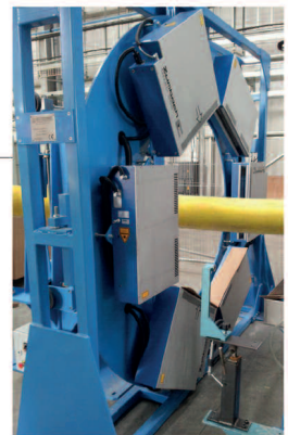
3-achsiges ODAC® 550 Messsystem für Ø bis zu 500 mm
