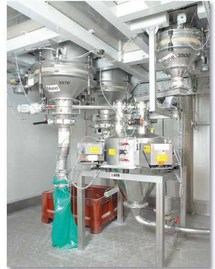
Bild 3: AZO COMPONENTER®, zur Herstellung von Chips
