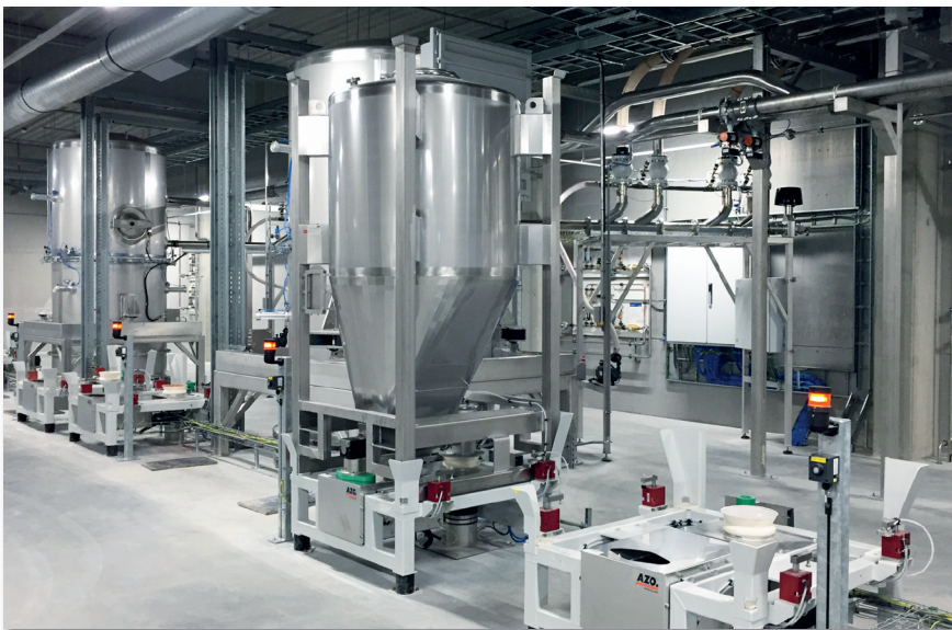
Bild 2: AZO DOSITAINER® für den Einsatz in Bereichen mit leicht entzündlichen Stäuben
