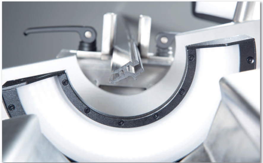
Das neue Inline-Modul Shiny Detection rückt Kratzern und Blasen jetzt auch auf hochglänzenden Oberflächen zu Leibe und meistert auch mehrfach gebogene Metallleisten
