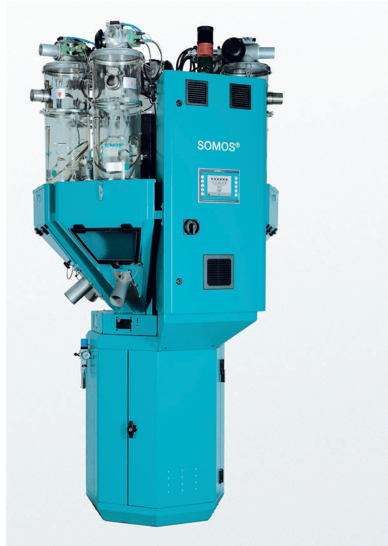
Erhältlich ist der SOMOS Batchmix in drei Größen (M, L, XL) mit Durchsätzen bis zu 1.900 kg/h. Im Bild der SOMOS Batchmix L (Fotos: ProTec Polymer Processing)
