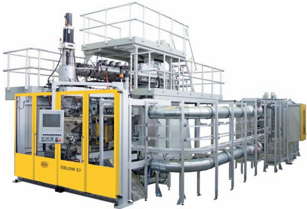
*Die neue elektrische EBLOW 37 vereint mit einer Schließkraft von 350 kN und einer Formbreite von 700 mm Wirtschaftlichkeit und Performance: Kanisteranwendungen sind die Domäne der EBLOW 37*
