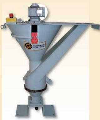
**RMX:** Rückspeisemaschine für Folienschnitzel als Teil eines kompletten asr®-Systems
