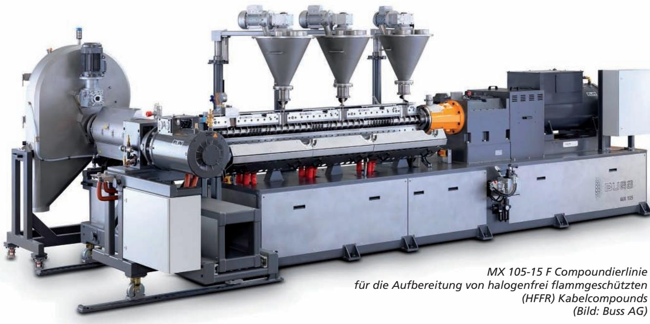
*MX 105-15 F Compoundierlinie für die Aufbereitung von halogenfrei flammgeschützten (HFFR) Kabelcompounds (Bild: Buss AG)*
