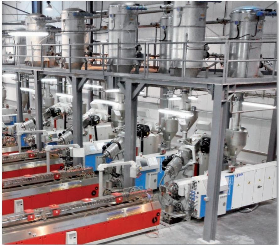
Profilextrusionslinien in Produktion
