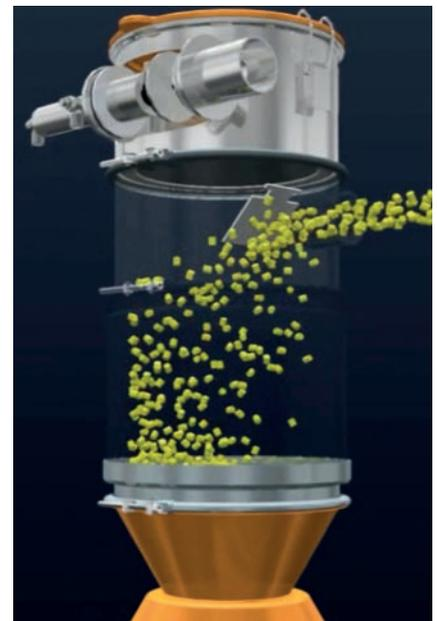
*Das in der Kunststoffverarbeitung mit Abstand wichtigste Förderprinzip ist die pneumatische Förderung, bei der das Fördergut mit Luft transportiert wird (Alle Bilder: Motan-Colortronic)*
