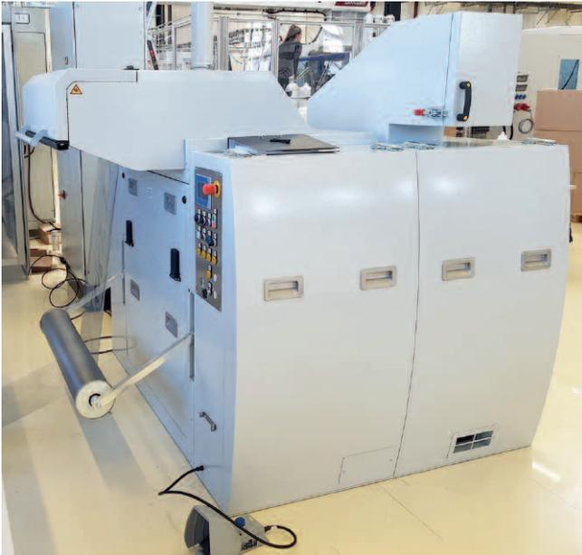
*Um Randstreifen, Stanzgitter und Fehlteile aus dem Vakuumformen kontinuierlich und effizient entsorgen zu können, entschied man sich bei Lechner für die Anschaffung der Einzugsmühle RS 30090-E von Getecha*
