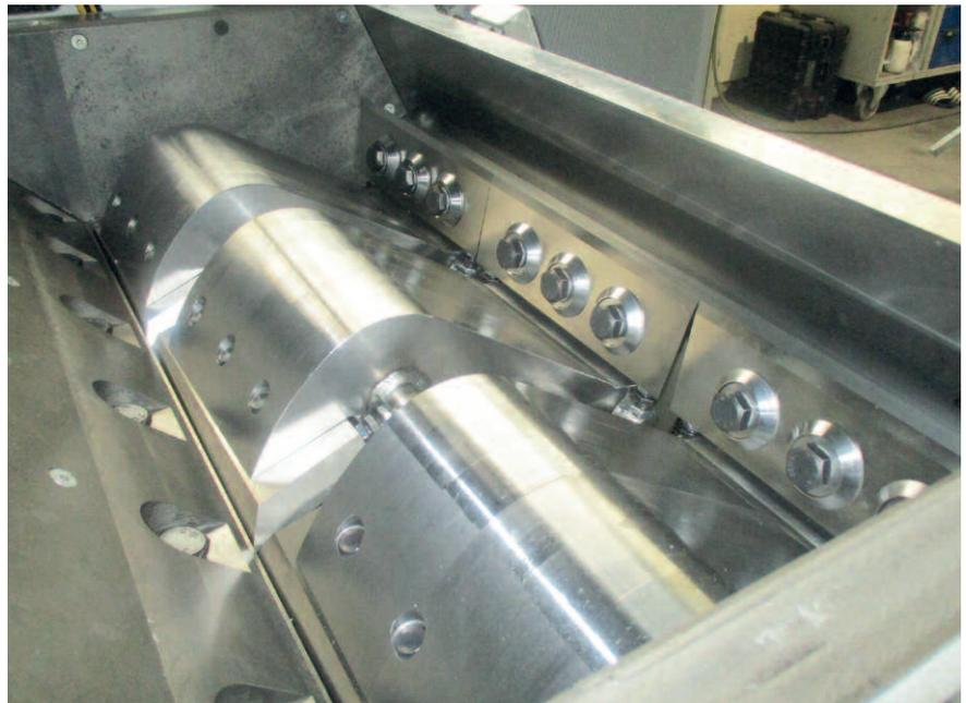
Im Mahlraum der RS 45090 von Getecha arbeitet ein massiver Drei-Messer-Rotor mit Schwungmasse und zusätzlichem dritten Statormesser. Er ist ausgelegt auf die Zerkleinerung stark verrippter Teile und verhindert ein allzu tiefes Eintauchen der Reststücke (Alle Bilder: Getecha)
