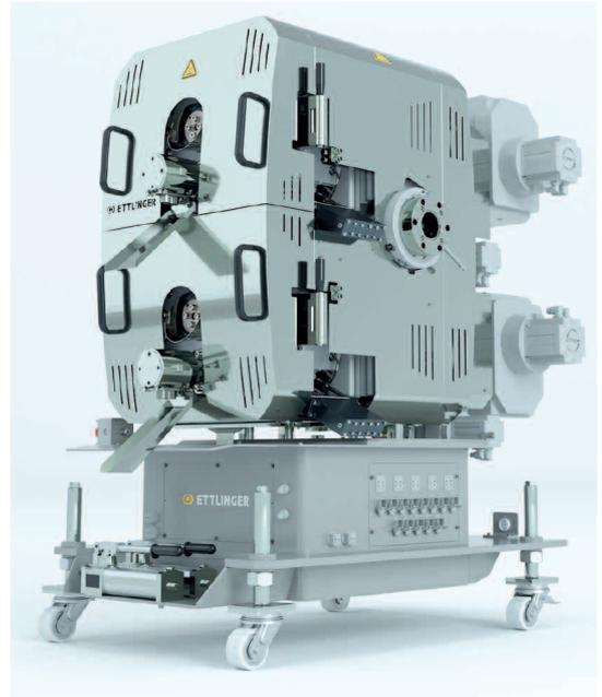
technik mit geringer Kompression er-möglicht sehr hohe Drücke bei geringem Schergefälle. Dadurch wird eine noch hö-here Produktqualität und volumetrische Effizienz sowie Fertigungskonsistenz und -sicherheit möglich.
