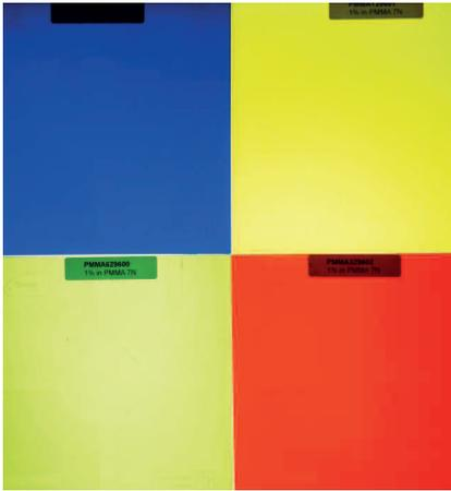
*Tosafs lichtstreuende Masterbatche sorgen auch bei LED-Punktstrahlern für eine gleichmäßige Ausleuchtung (© Tosaf Color Service)*
