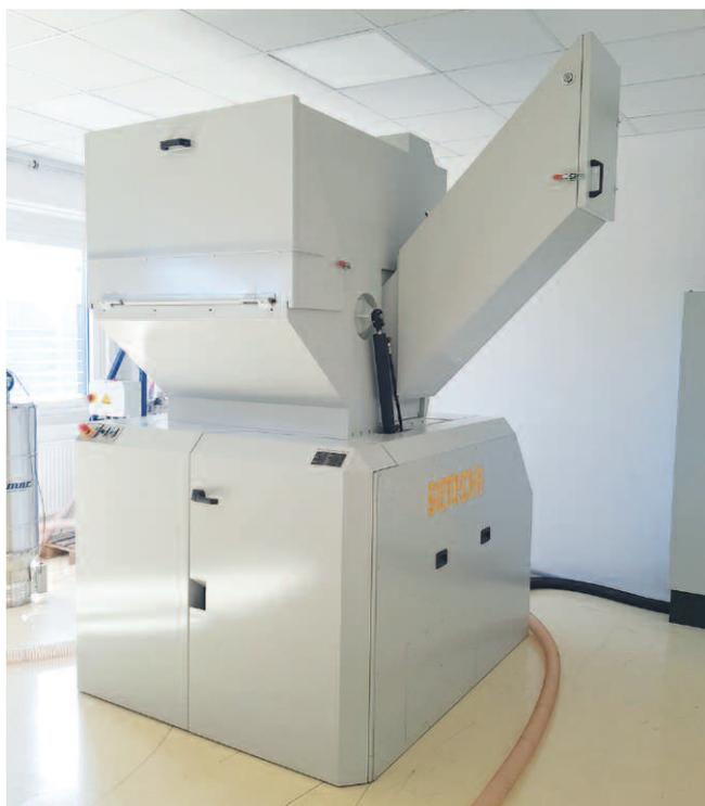
**Starke Performance: Die große Zentralmühle 45090 für Durchsätze von bis zu 900 kg/h ausgerüstet mit einem Bypassstrichter für die Zuführung von Profilen und Rohren ersetzt das Arbeitsvolumen zweier kleinerer Mühlen**
