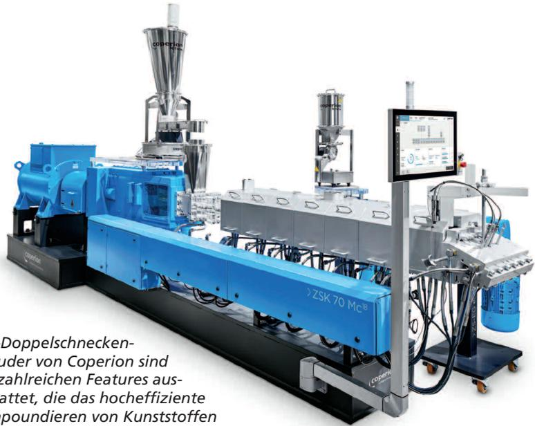
*ZSK-Doppelschneckenextruder von Coperion sind mit zahlreichen Features ausgestattet, die das hocheffiziente Compoundieren von Kunststoffen sicherstellen (Bild: Coperion, Stuttgart)*
