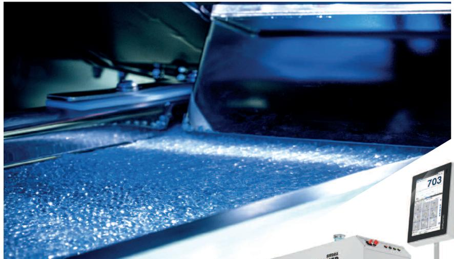
*Der PURITY SCANNER ADVANCED wird zur Inspektion und Sortierung von Kunststoffmaterial eingesetzt*
