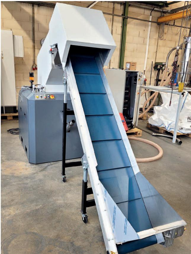
*Die auf Rollen verfahrbare RS 2404 von GETECHA hat einen 5,5 kW-Antrieb und ist für einen Stundendurchsatz von bis zu 160 kg ausgelegt*
