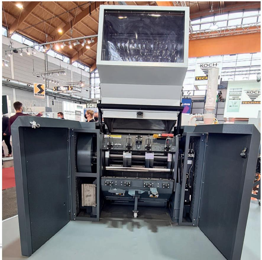
*Als Lösung für den kontinuierlichen Durchsatz mittlerer bis größerer Volumen von Kunststoffabfällen und Resten aus der Produktion stellt GETECHA auf der Fakuma unter anderem die Zentralmühle RS 45090 vor (Alle Bilder: Getecha)*
