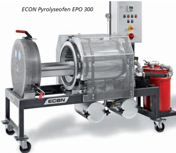
ratur werden Thermoplaste und Mischkunststoffe ohne Reinigungsmittel unter Vakuum entfernt. Bei den ECON Pyrolyseöfen werden ölgeschmierte Vakuumpumpen verbaut, und somit ist für den Betrieb nur ein Stromanschluss erforderlich, Wasser wird nicht benötigt. Abgase werden in einem Aktivkohlefilter adsorbiert.
