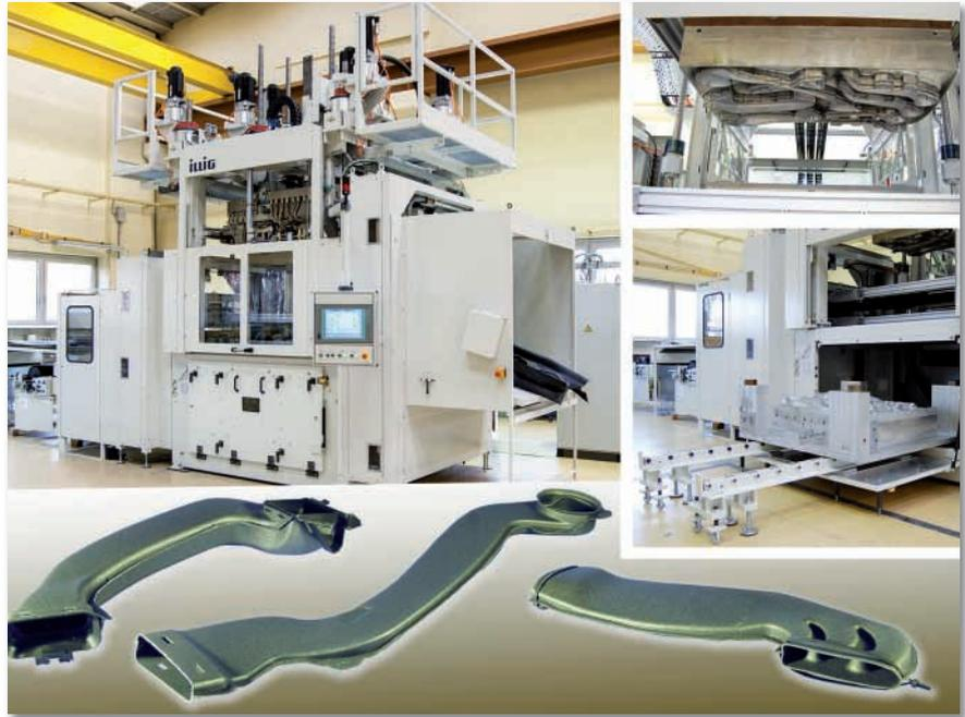
*Thermogeformte, sehr leichte und flexible Pkw-Luftführungskanäle in anspruchsvoller 3D-Geometrie aus XLPE-Schaumfolie: Der spanische Automobilzulieferer stellt sie serienmäßig im Twinsheet-Verfahren auf mittlerweile bereits drei Thermoformmaschinen ILLIG UAR 155g her (Bild: ILLIG)*
