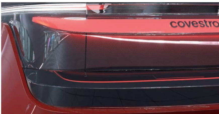
*Mit leuchtenden Flächen und darin integrierten Scheinwerfern und Heckleuchten kommt der Autobeleuchtung eine ganz neue Bedeutung zu: Licht und die Lichtwirkung selbst wird zum Stylingelement. Für das neue Fahrzeugkonzept hat Covestro gemeinsam mit dem Autozulieferer HELLA eine innovative Lösung auf Basis von holografischen Folien entwickelt*
