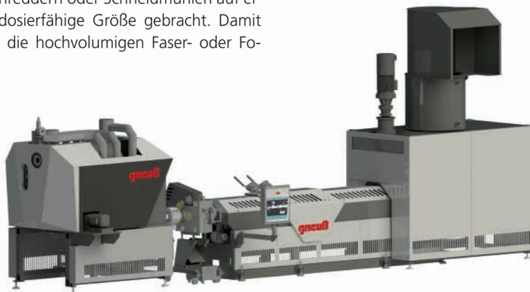
Bestandteile der Gneuß-Industrieabfall-Recyclinganlage, wie sie auf der K präsentiert werden. Mit Dosier- und Stopfeinheit, MRS-Extruder 90i, Rotary-Filtriersystem RSFgenius, Online Viskosimeter VIS und Jump-Reaktor
