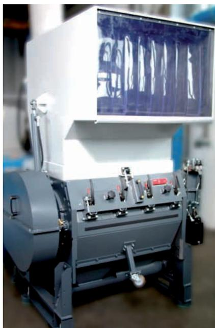
ist die hochwirksame integrierte Schalldämmung, die das Betriebsgeräusch der Zentralmühle auf ein Minimum senkt. Trotz dieser Ergonomie-Maßnahmen baut die RS 45090 aber dank ihres nach oben verlegten und ins Gehäuse integrierten Antriebs sehr kompakt und beansprucht nur eine verhältnismäßig geringe Stellfläche.
