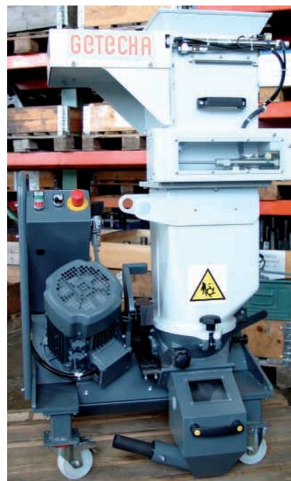
*Als Zerkleinerungslösung für Produktionslinien der Kunststofftechnik mit erhöhten Anforderungen an Hygiene und Sauberkeit präsentiert Getecha auf der K 2016 seine staubdicht ausgeführte Sauberraum-Schiebermühle GRS 180*
