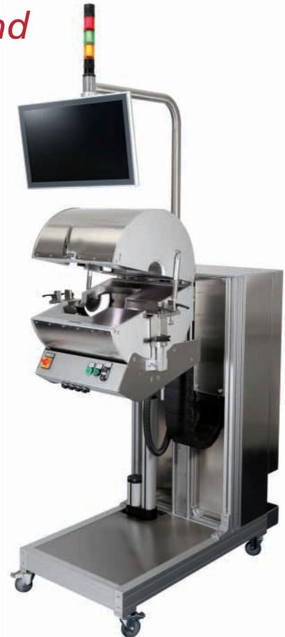
*Aus zwei mach eins: PC7 kombiniert erstmals 100 Prozent Oberflächeninspektion mit 360° Dimensionsvermessung in einem Sensor*
