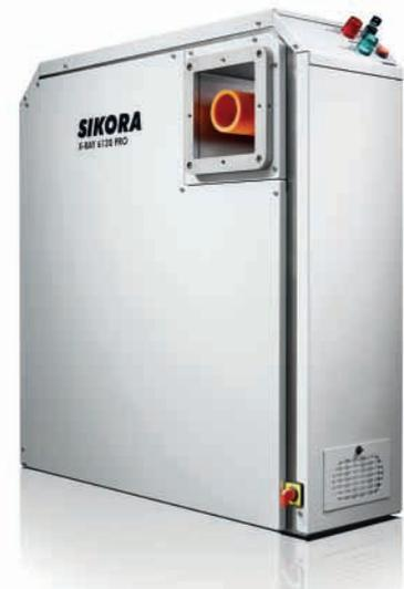
*Das X-RAY 6000 misst online, auf der Basis von Röntgentechnologie, den Innen- und Außendurchmesser, die Konzentrität, die Ovalität sowie die Wanddicke von Rohren und Schläuchen*
