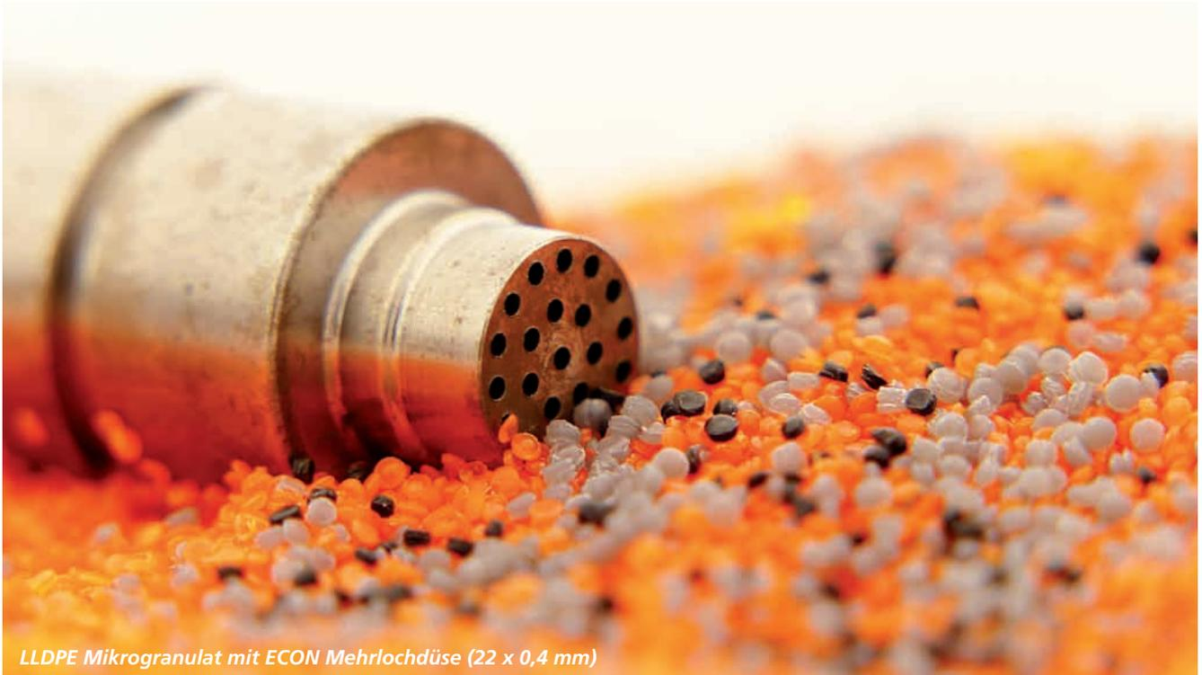
LLDPE Mikrogranulat mit ECON Mehrlochdüse (22 x 0,4 mm)
