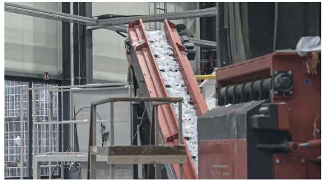
*Das zerkleinerte Material wird mit einem Förderband abtransportiert*
