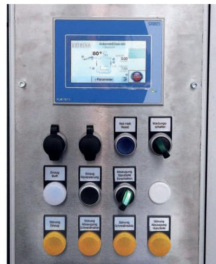
*Alles im Blick: Bedienfeld mit Touchscreen an einer Getecha-Zerkleinerungsmühle mit integrierter Zu- und Abführtechnik*
