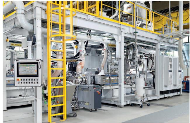
*KraussMaffei EdelweissCompounding-Anlage mit zwei Zweisechneckenextrudern ZE 65 Blue Power ist ausgelegt für eine Maximalleistung von rund 2.000 kg/h*
