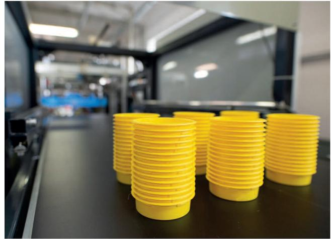
*Thermogeformte Schutzelemente von Pöppelmann KAPSTO®: Platzsparende Stapelung reduziert Transport- und Lagervolumen um bis zu 75 Prozent*
