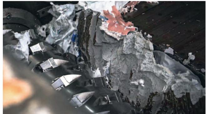
*Bei der Zerkleinerung von Airbag-Laminat wird ein besonders präziser Schnittspalt benötigt*
