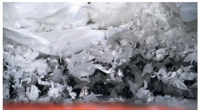
*Der F-Rotor wurde speziell für die Zerkleinerung von Folien und Fasern entwickelt*
