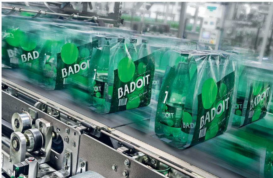
Dank des Schrumpffolienpackers kann Badoit eine deutlich reduzierte Foliendicke verarbeiten. Zudem erreicht die Maschine eine optimale Folibreite per Pack (Alle Bilder: Quelle: KHS Gruppe)
