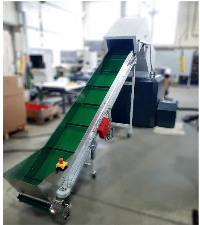
*GETECHA-Zerkleinerungsmühle mit Steigförderband zur kontinuierlichen, automatischen Zerkleinerung blasgeformter Behälter und Butzen kurz vor der Auslieferung*
