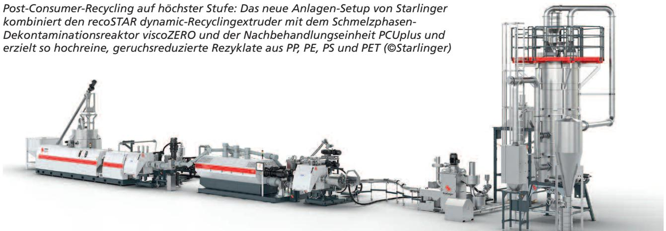
reingt und homogenisiert. Unerwünschte Gerüche oder Substanzen wie Spinnzusätze werden effektiv entfernt. Bei der Verarbeitung von PET ist es zudem möglich, den IV-Wert auf das gewünschte Niveau zu erhöhen.
