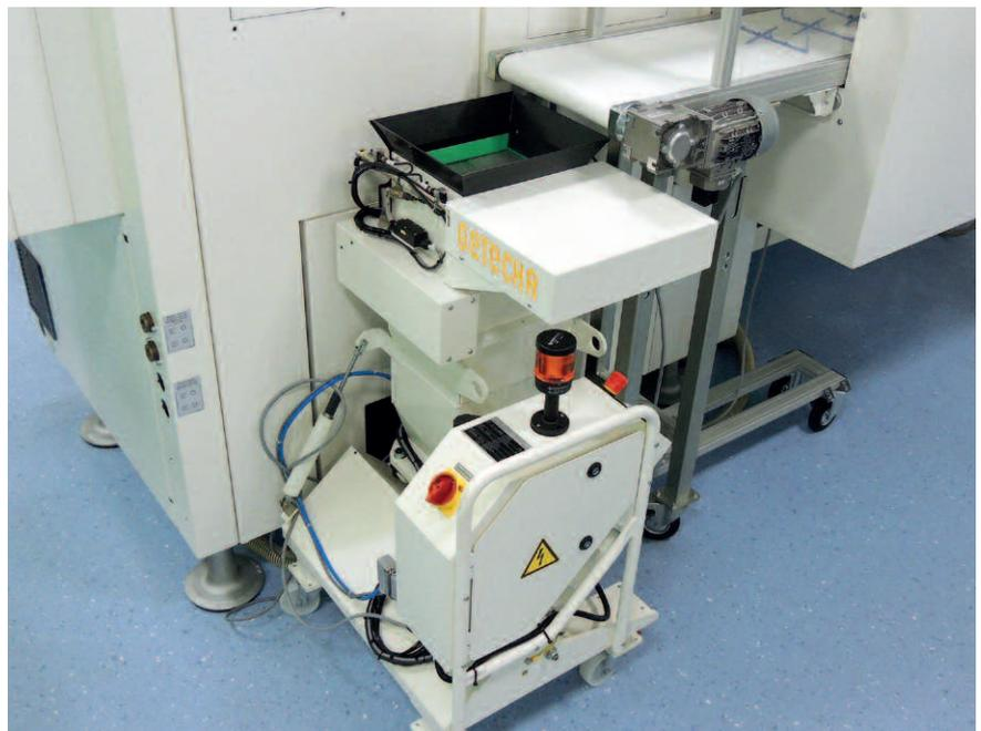
Die fertigungsintegrierte Zerkleinerung kleiner Pipetten, Ausschussflaschen und Butzen ist die Domäne der Beistellmühlen GRS 180/ 300 von GETECHA. Das Bild zeigt eine Sauberraum-Ausführung mit Schleusenzuführung (Alle Bilder: Getecha)
