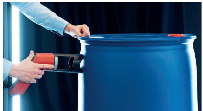
Das **Warp Portable** ist ein mobiles, intuitiv bedienbares Handmessgerät für die punktuelle Wanddickenmessung. Seine integrierte Zentrierhilfe sorgt für einen idealen Messabstand. Das Gerät misst auf Knopfdruck. Die letzten 500 Messwerte werden
