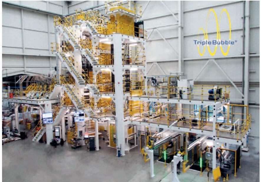
*Mittelgroße Triple-Bubble®-Blasfolienanlagen von Kuhne erreichen Durchsätze bis zu 250 kg/h bei der Herstellung von Folien für recyclinggerechte, weiche Barriere-Schrumpfbeutel (Bilder © Kuhne Anlagenbau)*
