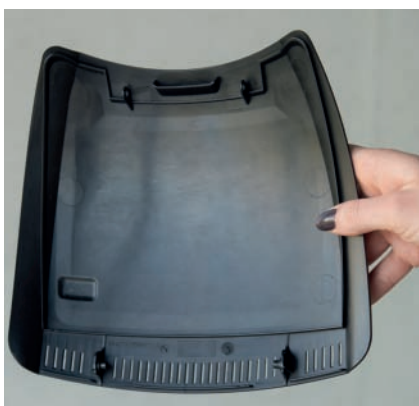
Gehäusedeckel, hergestellt aus einem Gemisch von Polyhydroxy-Buttersäure (PHB) mit Polypropylencarbonat. PHB ist sehr spröde. Die Mischung sorgt für bessere Materialeigenschaften. Polypropylencarbonat kann aus dem Klimagas Kohlendioxid hergestellt werden
