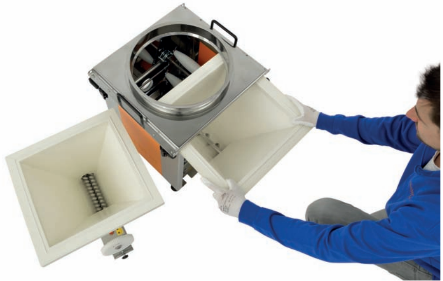
Exchange module / Wechselmodul – In unter 60 Sekunden gewechselt
