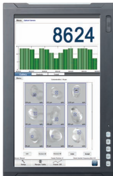
Anzeige der detektierten Verunreinigungen in transparenten Pellets auf dem ECOCONTROL 6000
