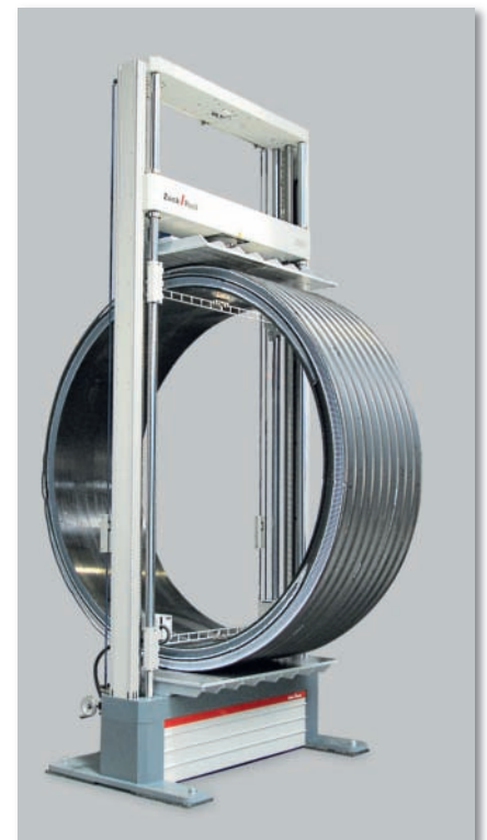
Prüfung von Rohren mit einem Durchmesser von bis zu 3,5 m
