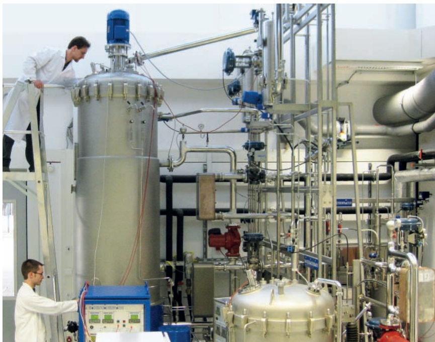
Technikum des Forschungszentrums für Weiße Biotechnologie. Der 1000-Liter-Fermenter bildet das Herzstück der Ausstattung, die die Untersuchung der Hochskalierung vom Labor- bis in den Pilotmaßstab ermöglicht (Fotos: Battenberg, Andreas / TUM)
