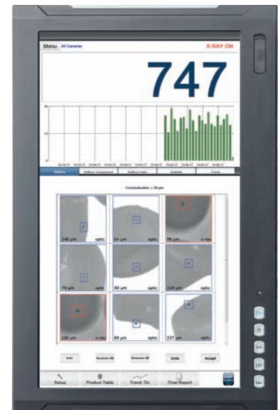
Anzeige der detektierten Kontaminationen in den Pellets auf deren Oberfläche auf dem ECOCONTROL 6000
