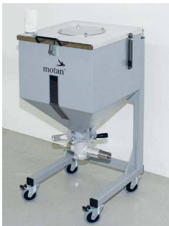
Beschleierungsbehälter als Beistellausführung um Material trocken zu halten (Bild: motan)
