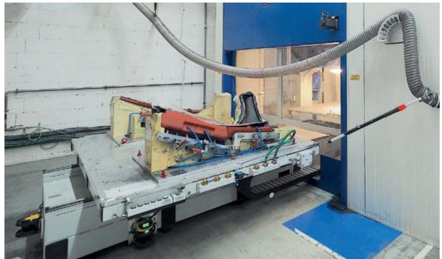
Das Shuttlesystem mit zwei Tischen senkt die Stillstandszeiten der Fräszentren auf zwei bis drei Prozent der Maschinenlaufzeit – gegenüber 40 bis 45 Prozent bei einer Anlage mit nur einem Tisch (Foto: HG GRIMME SysTech)
