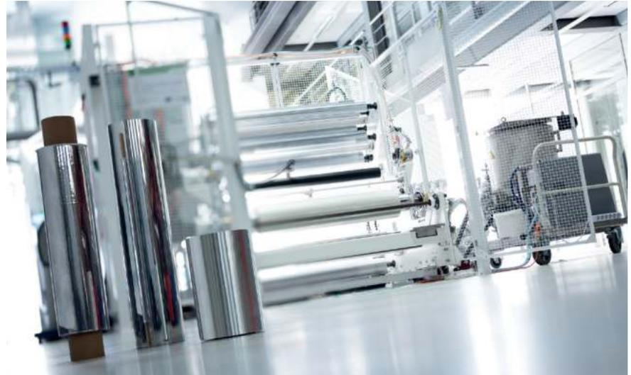
Rolle-zu-Rolle Pilotbandbeschichtungsanlage atmoFlex 1250 mit 1200 mm Beschichtungsbreite für die Rolle-zu-Rolle Nano-Imprint-Lithografie (RzR-NIL-Prozess) © Fraunhofer FEP, Jan Hosan
