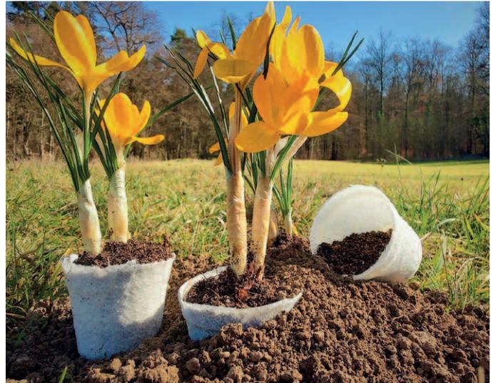
*3D-geformter PHB-Vliesstoff aus einem Meltblown-Prozess im Einsatz als Blumentopf*
