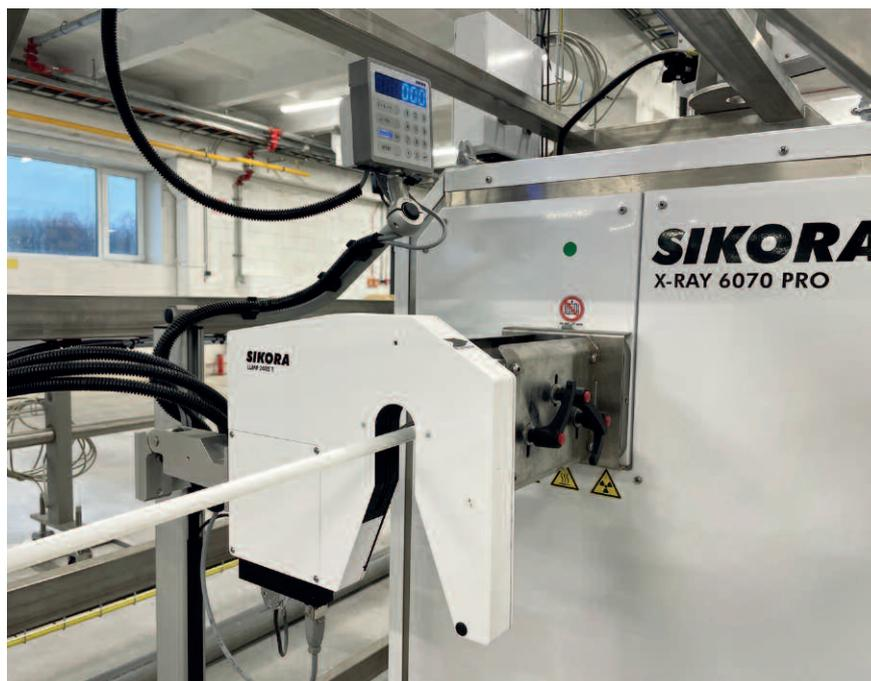
Für eine optimale Qualitätskontrolle setzt HÖHLE den LUMP 2000 zur Erkennung von Knoten und Einschnürungen in den Microduct-Produktionslinien ein
