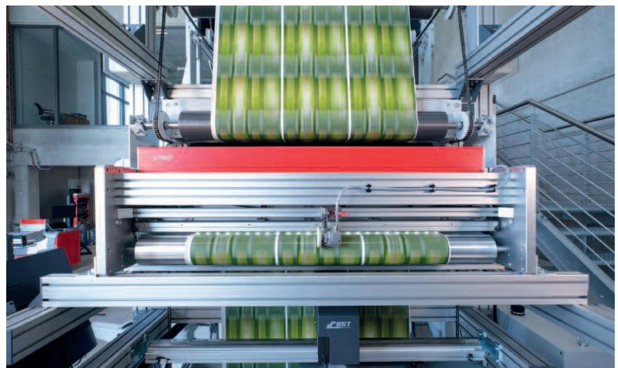
Druckfehler wie Spritzer, Registerabweichungen oder Farbveränderungen. Das führt zu weniger Makulatur bei Druckprozessen und wirkungsvoller Qualitätssicherung am Slitter. Dank seines kompakten Montagerahmens aus Aluminiumstrangpressprofilen lässt sich TubeScan XL einfach in neue und bestehende Maschinen integrieren.
