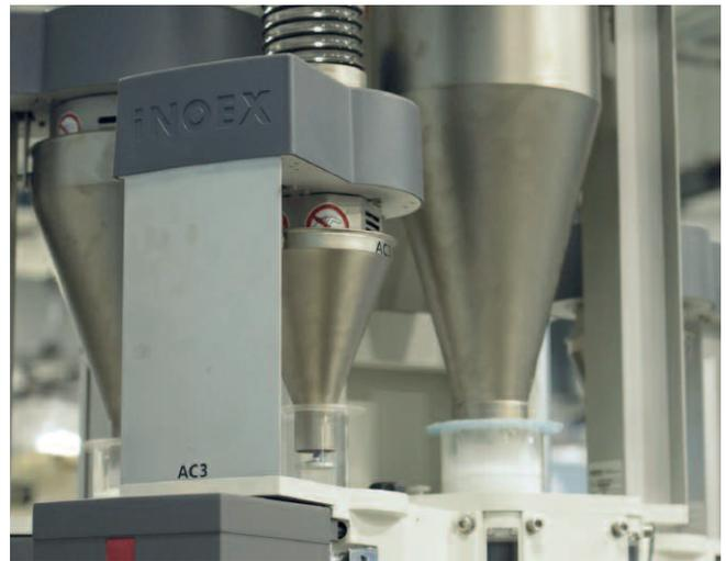
*Das gravimetrische Dosiersystem sorgt für eine präzise Dosierung und seine Steuerung spielt eine wesentliche Rolle bei der Systemintegration*
