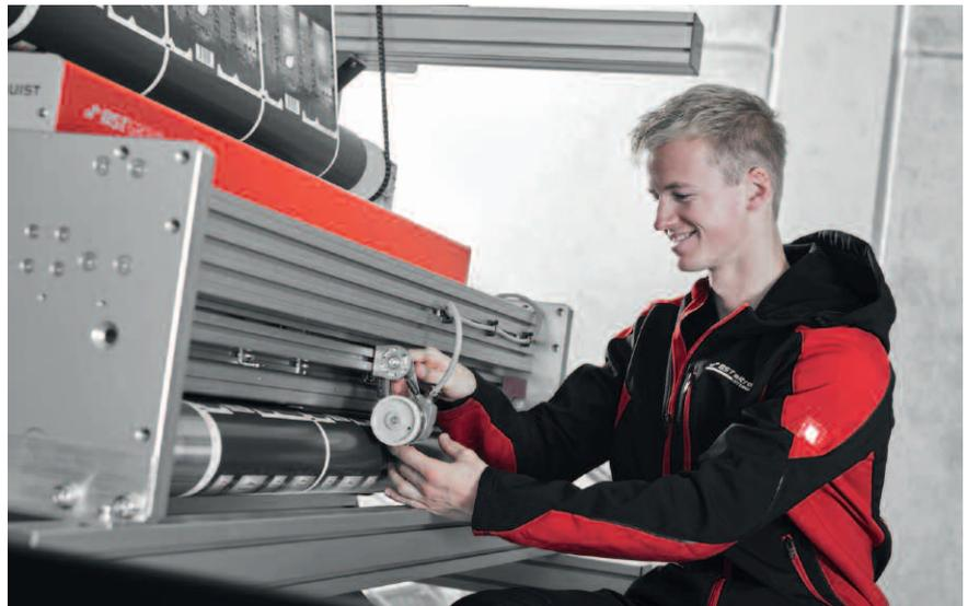
*TubeScan XL lässt sich auf gängigen Schneide- und Druckmaschinen installieren. Das System besitzt einen universellen Montagerahmen, in den zwei Umlenkwalzen integriert sind, die je nach Bahnverlauf auf unterschiedliche Weise vormontiert werden können*
