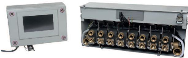
**34** *Single Temperiertechnik bringt mit dem Smart Control Flow den ersten „smarten“ Wasserverteiler an einem Temperiersystem auf den Markt. Das Modulare Konzept ermöglicht Lösungen für unterschiedlichste Aufgabenstellungen und wird dazu vollständig in die Temperierung integriert.*
