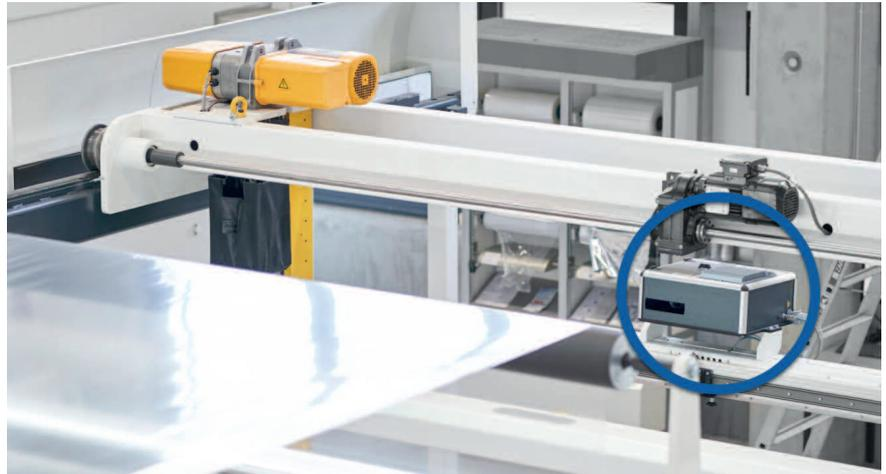
*OCS FSP600 Workstation integriert in der Folienproduktionslinie
