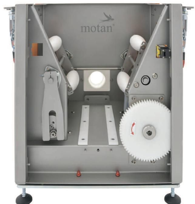
Interessant ist das modulare Konzept dieser Dosiersysteme hinsichtlich ihrer Flexibilität und Einsatzbandbreite. So lässt sich der Materialbehälter ohne Werkzeug in kurzer Zeit austauschen, was etwa für schnelle Materialwechsel entscheidend ist, denn die Reinigung des Behälters kann separat erfolgen.
