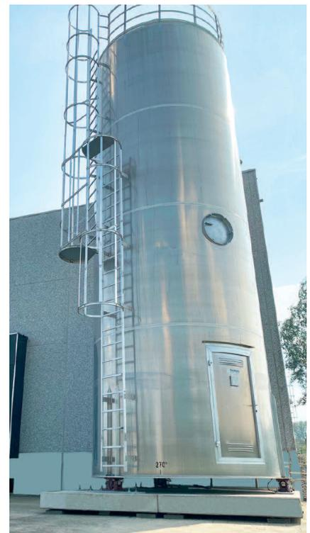
Primär können Kunststoffgranulate in dem 70 Kubikmeter fassenden Silo zwischengelagert werden, um sie zu einem späteren Zeitpunkt weiterzuverarbeiten. Diese können mittels Saugförderer direkt den mobilen Granulatsortierungsanlagen der SEPARATION zugeführt werden, wo fehlerhafte Teilchen über optoelektronische und mechanische Trennverfahren aussortiert werden. Nach der Sortierung erfolgt die Abfüllung des Granulats wie gewohnt wahlweise in Säcken, Big Bags
