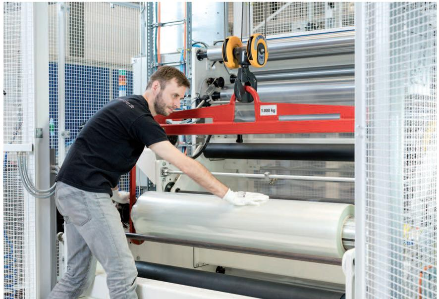
*1,25 Meter breites Foliensubstrat an der Rolle-zu-Rolle-Beschichtungsanlage atmoFlex 1250 (© Fraunhofer FEP, Fotograf: Ronald Bonss)*
