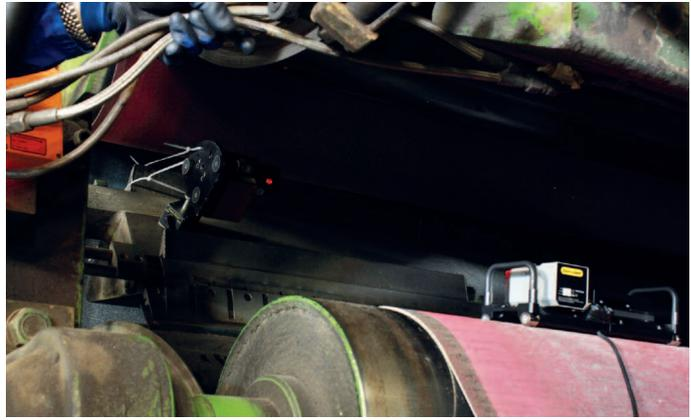
Das Unternehmen nutzt unter anderem die Parallelitätsmessung mit Winkeldetektor. Dadurch können auch kurze Betriebsunterbrechungen für eine Messung genutzt und einzelne Walzen eingestellt werden
