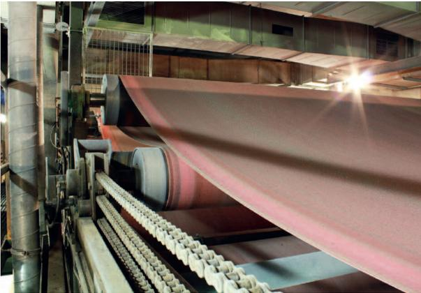
Anlagen zur Herstellung von Papier oder Kunststoffmatten zählen zu den größten industriellen zusammenhängenden Maschinen. Das Zusammenspiel zahlreicher Walzen, Wellen und Kalandersorgt für einen spannungsfreien und gleichmäßigen Bahnverlauf
