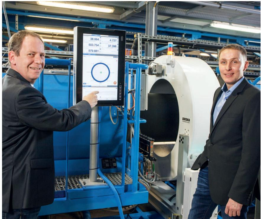
*Die Millimeterwellen-Technologie von SIKORA misst bei Gerodur inline den Durchmesser, die Ovalität, Wanddicke und das Sagging von Kunststoffrohren, von links: Peter Hügen, Area Sales Manager bei SIKORA, und Andre Richter, Teamleiter*
