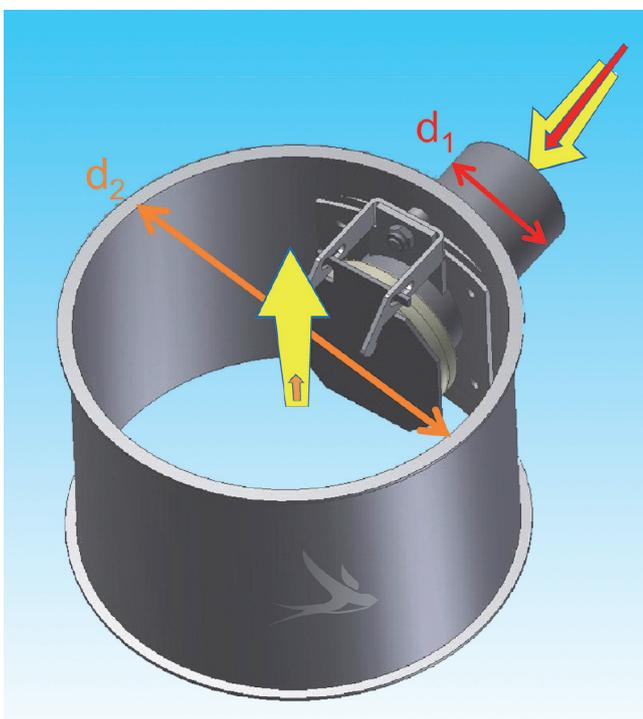
des Fördergerätes, ehe es am Ende des Förderzyklus ausgetragen wird. Die Schwebegeschwindigkeit ist ihrerseits unter anderem abhängig von der Masse, der Dichte und der aerodynamischen Form (cw-Wert) des Granulats. So beträgt beispielsweise die Schwebegeschwindigkeit von PS-Granulat (3 mm, 1 kg/dm<sup>3</sup>, cw = 0,6) 7,4 m/s.
