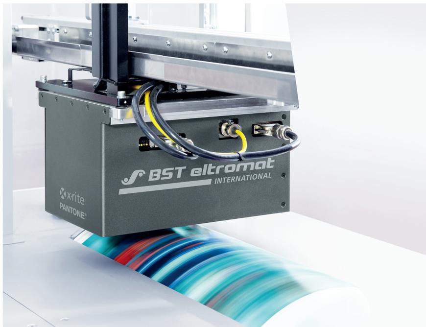
*Mit COLOR DATAPreparation präsentiert BST eltromat International auf der diesjährigen ICE Europe eine neue Option, die das Einrichten der Inline-Spektralfarbmessung iPQ-Spectral vereinfacht. Die Software wird in Druckvorstufe, Produktionsplanung oder Qualitätsmanagement installiert, die von nun an die Daten für die Inline-Spektralfarbmessung aufbereiten*
