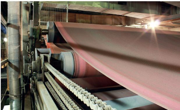
**28** Anlagen zur Herstellung von Papier oder Kunststoffmatten zählen zu den größten industriellen zusammenhängenden Maschinen. Das Zusammenspiel zahlreicher Walzen, Wellen und Kalanders sorgt für einen spannungsfreien und gleichmäßigen Bahnverlauf. Eine spezielle Laser-Echtzeitmessung verringert Stillstandzeiten.
