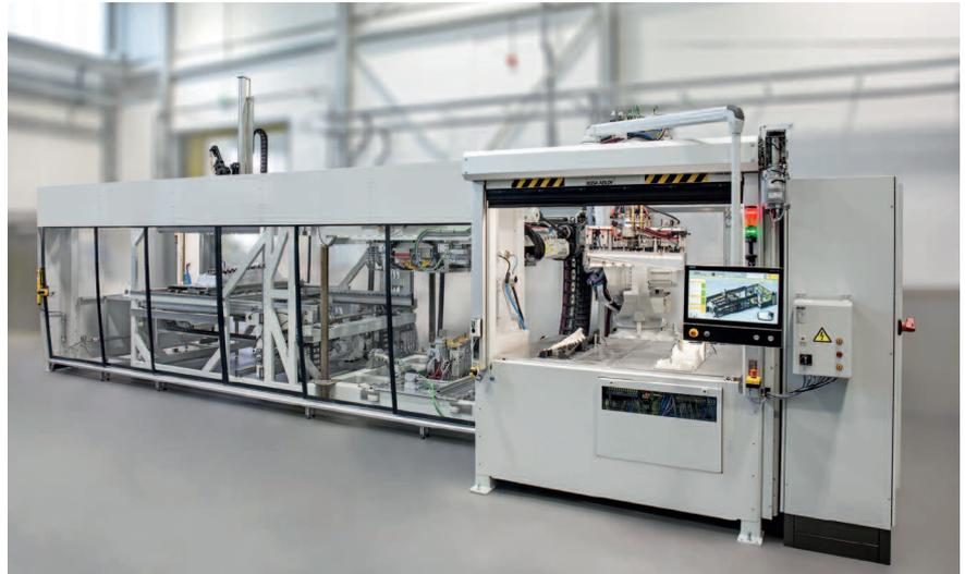
Neue hochautomatisierte und modular aufgebaute Kiefel-Vakuumkaschieranlage nach dem TBL Verfahren (Tailored-Blank-Laminating)
