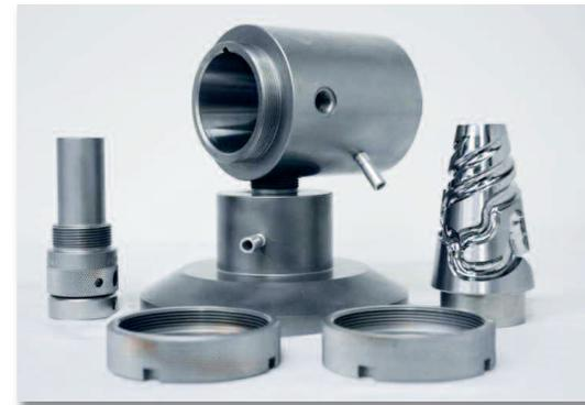
Fotos der Bullet II zeigen das Nichtvorhandensein von Befestigungsteilen, das heißt Muttern und Schrauben, um Demontage, Reinigung und Neustart zu erleichtern
