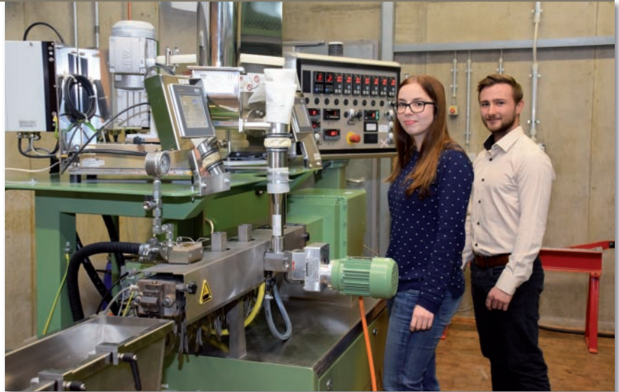
Leistritz ZSE 18: ein flexibler Doppelschneckenextruder für die Hochschule (Bild © Hochschule Esslingen)
