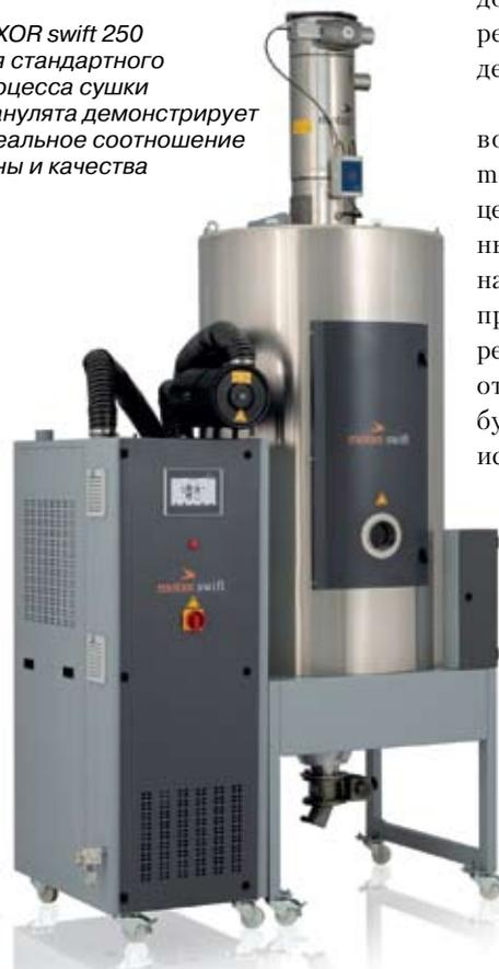
загрузчики METRO swift HOS. Пластиковый гранулят быстро и в чистом виде транспортируется посредством METRO swift HOS в дозаторы, воронки, сушильные бункеры или другие накопительные резервуары и подается в машину по мере необходимости. Это исключает потерю материала и обеспечивает чистоту и безопасность рабочей зоны.
