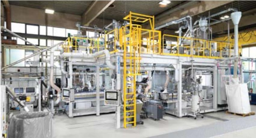
*Технология компаундирования Edelweiss от KraussMaffei — оптимальный модульный вариант для подготовки и компаундирования чистосортных пластиковых отходов в рамках единого процесса*
