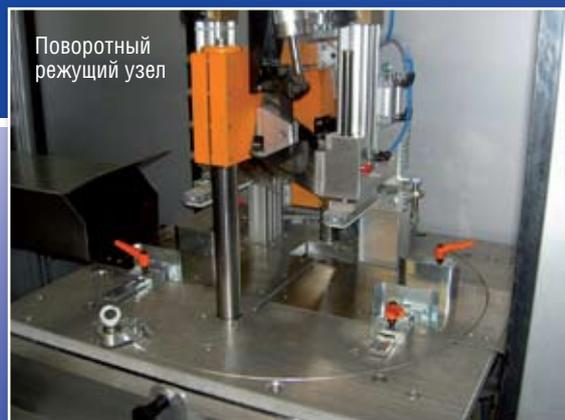
Поворотный режущий узел
