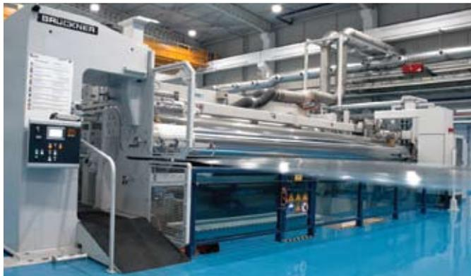
Высокоэффективная установка для ориентации пленки
