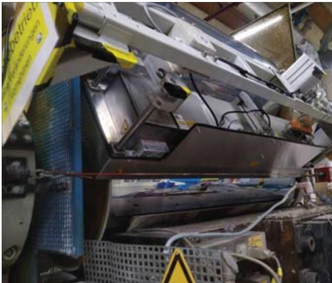
Опытно-промышленная модель системы бесконтактной очистки поверхности холодной плазмой ED TouchlessClean
