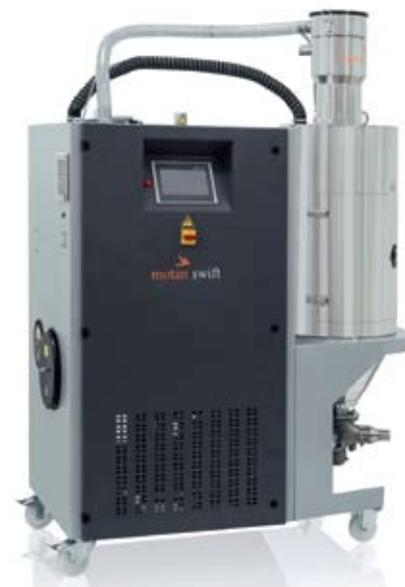
*COMPACT swift обеспечивает сушку и подачу в одном устройстве*
