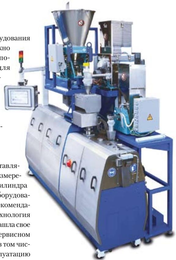
Экструдер FED 26 MTS с 3 гравиметрическими дозаторами и металлосепаратором для контроля качества загружаемого основного материала
