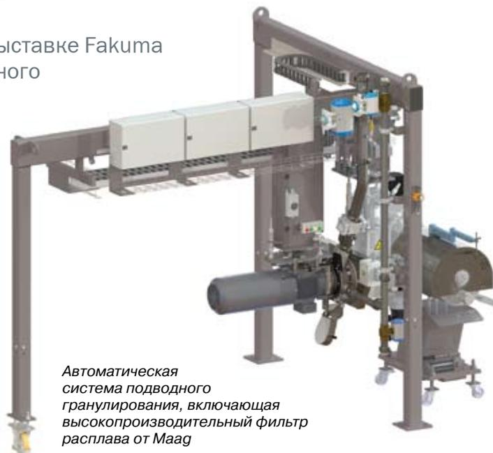
Автоматическая система подводного гранулирования, включающая высокопроизводительный фильтр расплава от Маг
