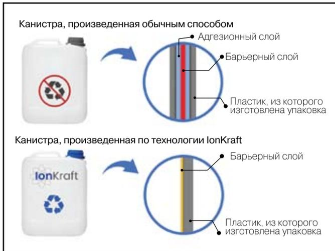
*Сравнение стандартной технологии создания барьерного слоя с технологией плазменного нанесения покрытия IonKraft*
