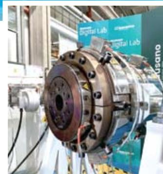
Кроме того, экструзионные системы Vausano снабжены инновационной системой Smart Energy для нагрева цилиндра с помощью электромагнитного поля, что позволяет сэкономить до 35% энергии.
