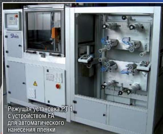
Режущая установка РТ 1 с устройством FA для автоматического нанесения пленки
