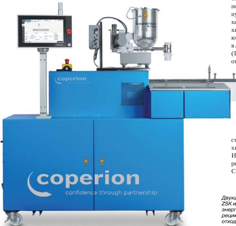
*Двухшнековый экструдер Coperion ZSK идеально подходит для энергоэффективного химического рециклинга смешанных пластиковых отходов за счет высоких показателей мощности, диспергирования и дегазации*
