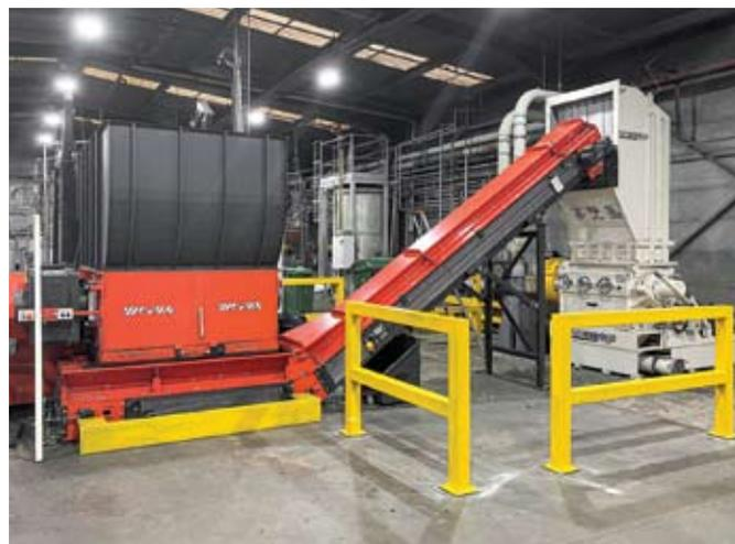
Двухступенчатое измельчение с помощью шредера WEIMA Zerkleinerer и ножевой дробилки Neue Herbold
