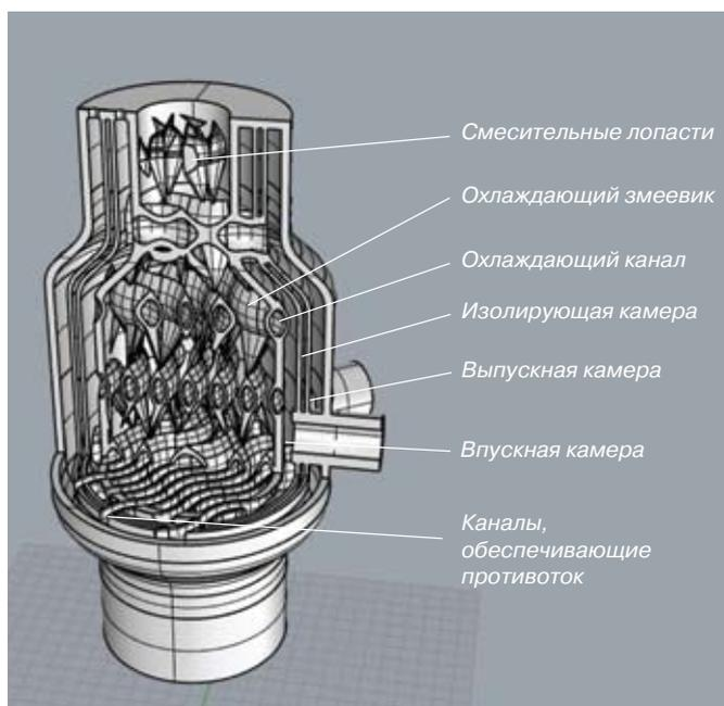
*Рисунок 1. Конструкции охладителя расплава, изготовленного по технологии селективного лазерного плавления в разрезе*
