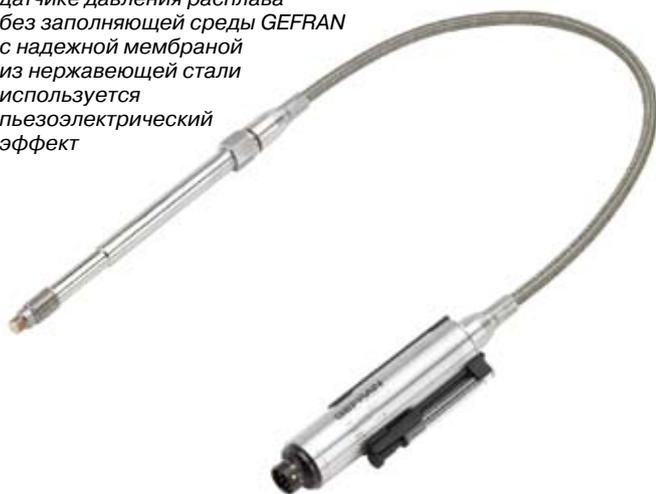
лопнуть. Неосторожная или неправильная очистка датчиков также может быстро привести к повреждению сравнительно тонкой мембраны и тем самым помешать надежной защите от превышения давления. Только опытные сотрудники способны выполнить очистку головки датчика, не нарушая его работоспособность.
