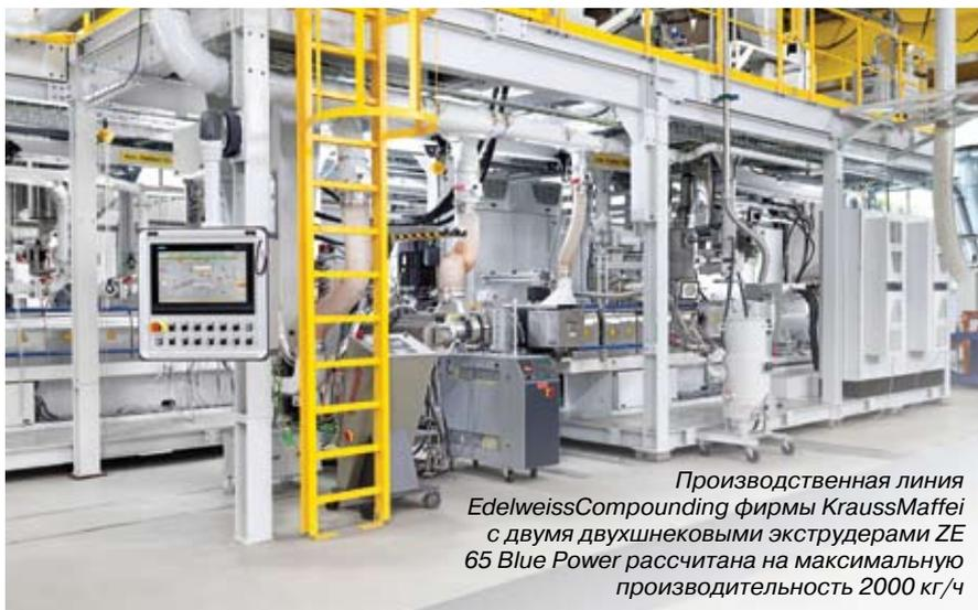
*Производственная линия EdelweissCompounding фирмы KraussMaffei с двумя двухшнековыми экструдерами ZE 65 Blue Power рассчитана на максимальную производительность 2000 кг/ч*
