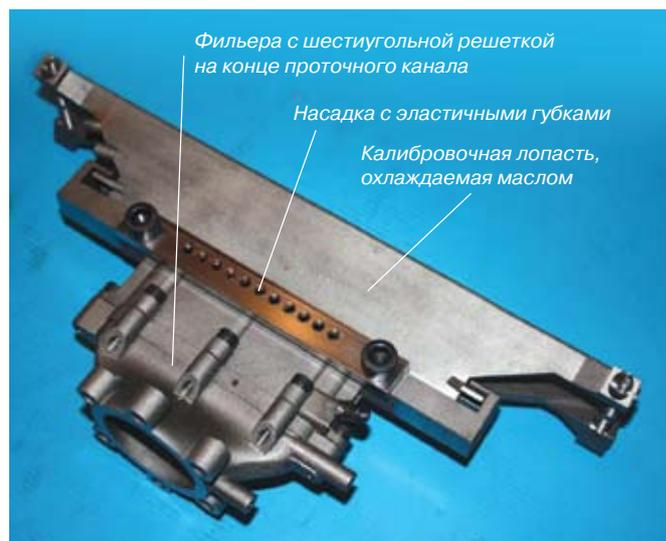
Фильтра с шестиугольной решеткой на конце проточного канала
