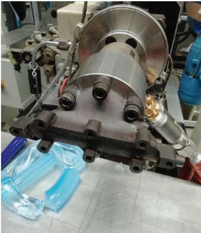
Рисунок 4. Фильтр для исследований, присоединенный к охладителю расплава, с шестиугольной решеткой в проточном канале на выходе фильеры
