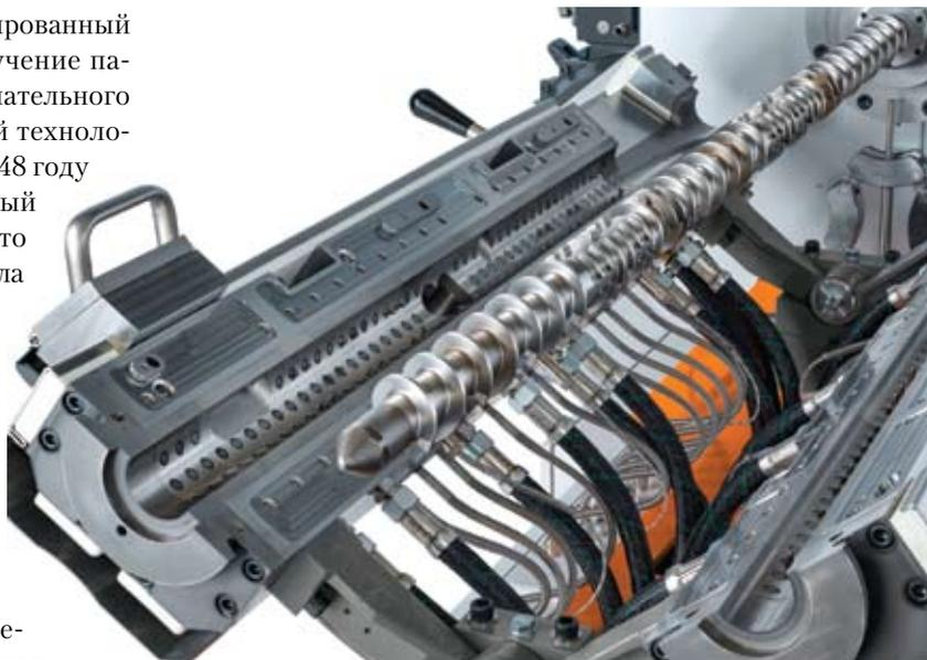
*В технологической зоне современных компаундеров COMPEO в цилиндре закреплены смешивающие штифты, которые взаимодействуют со смешивающими лопастями модульного шнека (фото: Buss)*
