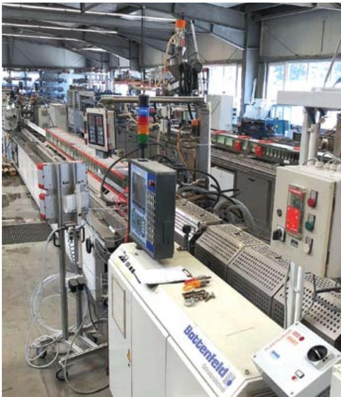
На новых экструзионных линиях фирма SLS может производить сложные профили с сечением до 300×200 мм, при этом масса профилей может достигать 4 кг/м. Профили с различным сечением могут иметь толщину стенки до 8 мм
