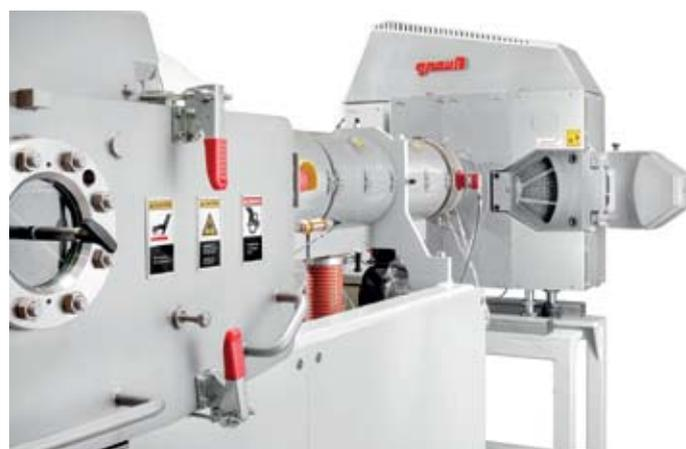
*Самоочищающаяся система фильтрации RSFgenius обеспечивает поддержание перепада давления расплава в жестко контролируемом диапазоне  $\pm 2$  бар*
