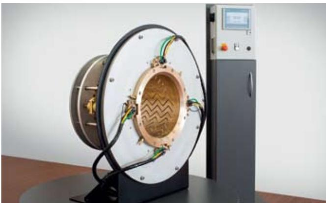
Новейшая разработка ССА: рукавный калибратор с электроприводом для инлайн-контроля диаметра и овальности трубы. Оптимален для полимерных труб диаметром от 280 до 2600 мм
