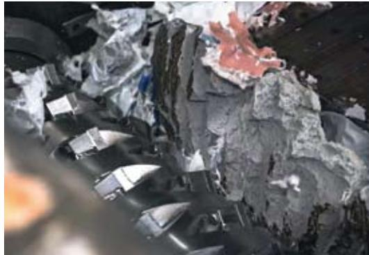
Для измельчения надувных подушек безопасности из ламинированного материала необходимо обеспечить точный зазор при резании
