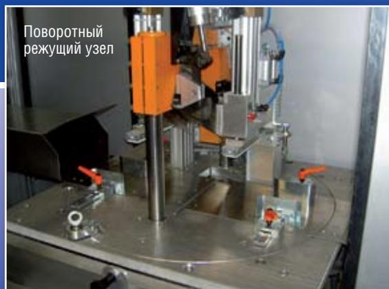
Поворотный режущий узел
