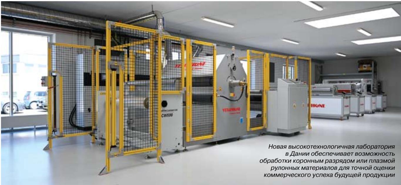
*Новая высокотехнологичная лаборатория в Дании обеспечивает возможность обработки коронным разрядом или плазмой рулонных материалов для точной оценки коммерческого успеха будущей продукции*
