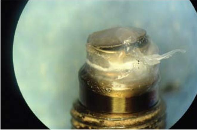
*Мембрана традиционного датчика давления расплава с заполняющей средой, разрушенная налипшим полимерным материалом*
