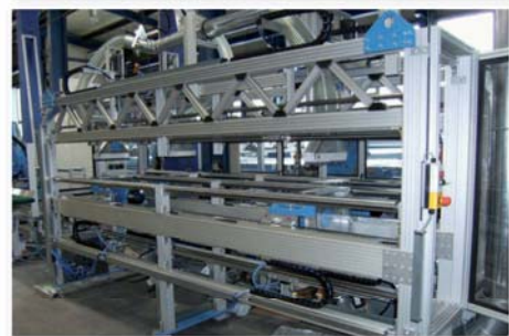
Устройство продольного разрезания RB 2 с четырьмя позициями распиливания
