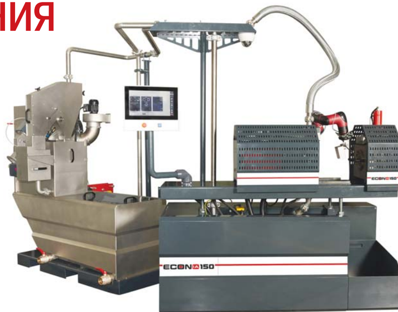
Общий вид ECONia 150 — первой в мире полностью автоматической системы подводного гранулирования
