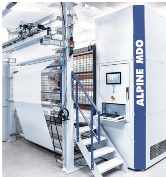
Вытяжная установка MDO 04 для производства пленок, пригодных для вторичной переработки
