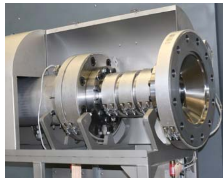
Рисунок 3. Во время работы три ленточных нагревателя поддерживают заданную температуру фильтра 115°C (фото: Maag)
