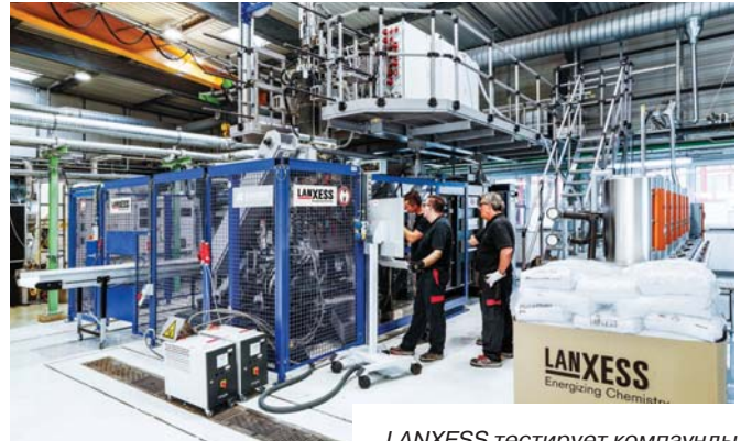
LANXESS тестирует компаунды для экономичного выдувного формования деталей на установке KBS20-SB от компании Kautex Maschinenbau
