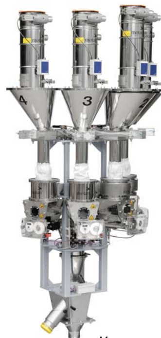
Модульная система дозирования и смешивания SPECTROPLUS с загрузочными устройствами, сконфигурированная для производства пленки
