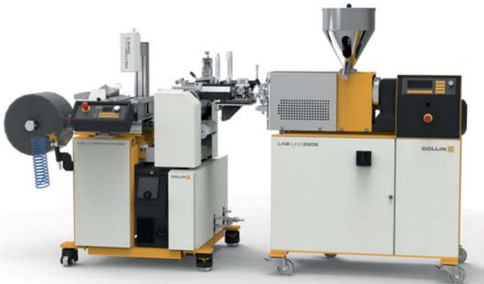
Линия Dr. COLLIN для производства плоской пленки с измерением реологических параметров в режиме реального времени и системой контроля на базе видеокамеры
