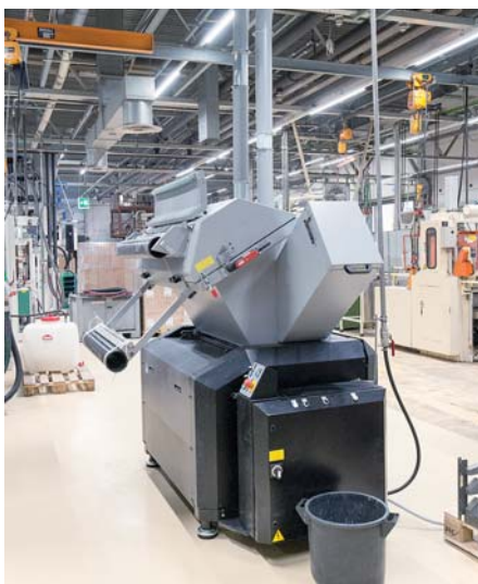
Решетка с остатками материала попадает с термоформовочной установки в измельчитель, так что дробленка может быть вновь подана в экструдер
