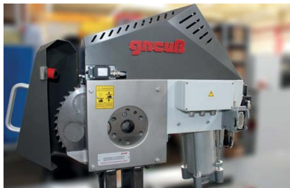
Ротационная непрерывная система фильтрации KF 150 эффективно работает даже в условиях частой смены материалов
