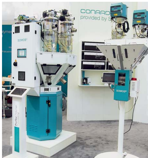
Гравиметрические порционные дозаторы серии SOMOS Batchmix (справа — Batchmix 50), в зависимости от типоразмера могут перерабатывать до 12 различных материалов (фото: VM Verlag)
