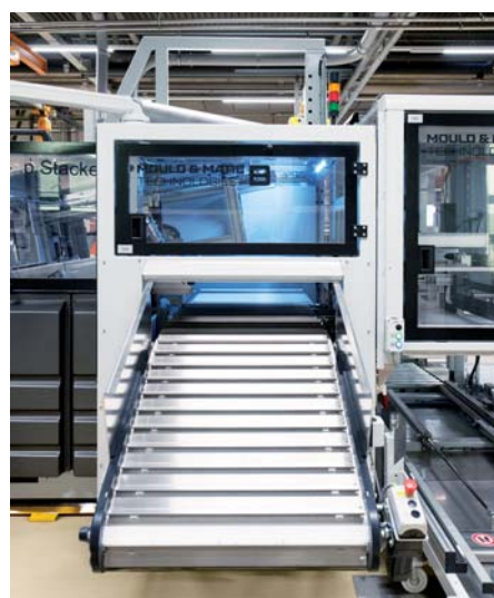
Когда штабели достигают определенной высоты, они с помощью автоматического устройства подаются в картонную коробку или извлекаются вручную
