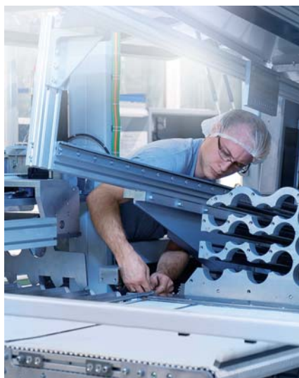
Замена инструмента также включает в себя переоснастку устройств штабелирования и упаковки с изменением формата на укладчике
