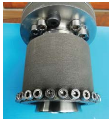
Рис. 7. Конический дорн в положении, обеспечивающем максимально возможное значение величины зазора филъеры
