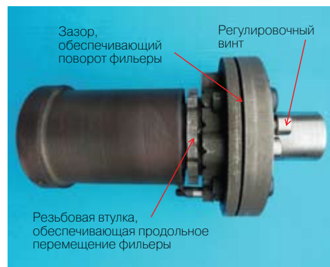
Рис. 5. Вид сбоку головки с обычной массивной фильерой и фланцевым соединением и заданной щелью между фильерой и головкой для ограничения угла наклона
