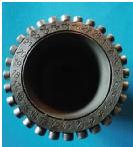
Рис. 6. Филъера с гибкой кольцевой втулкой диаметром 50 мм (хорошо видны регулировочные винты, обеспечивающие точную настройку толщины стенки трубы)
