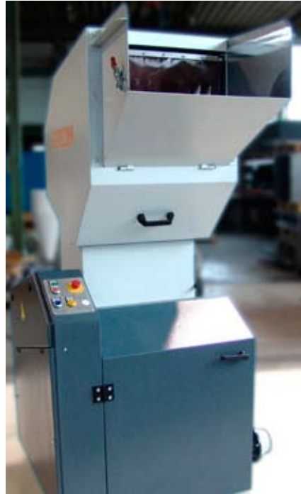
Система RS 2404 B от Getecha рассчитана на производительность до 160 кг в час. Являясь дробилкой среднего класса, она установлена на многих предприятиях, специализирующихся на выдувном формовании
