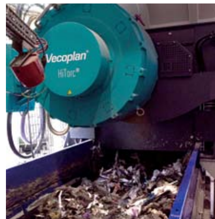
Шредер от Vecoplan с приводом HiTorg одинаково эффективно перерабатывает упаковку из пластика, металла и композитов, а также бытовые отходы
