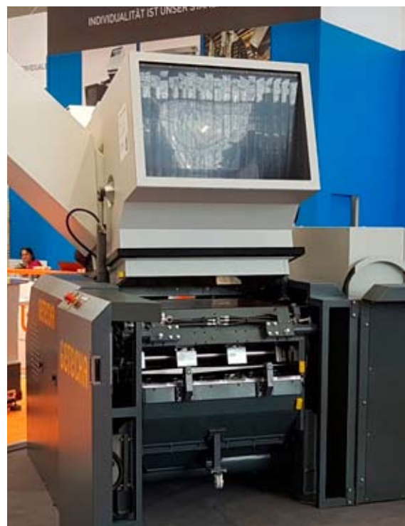
Большая дробилка со звукоизоляцией Getecha 45090 рассчитана на производительность до 900 кг/ч (все фото: Getecha)
