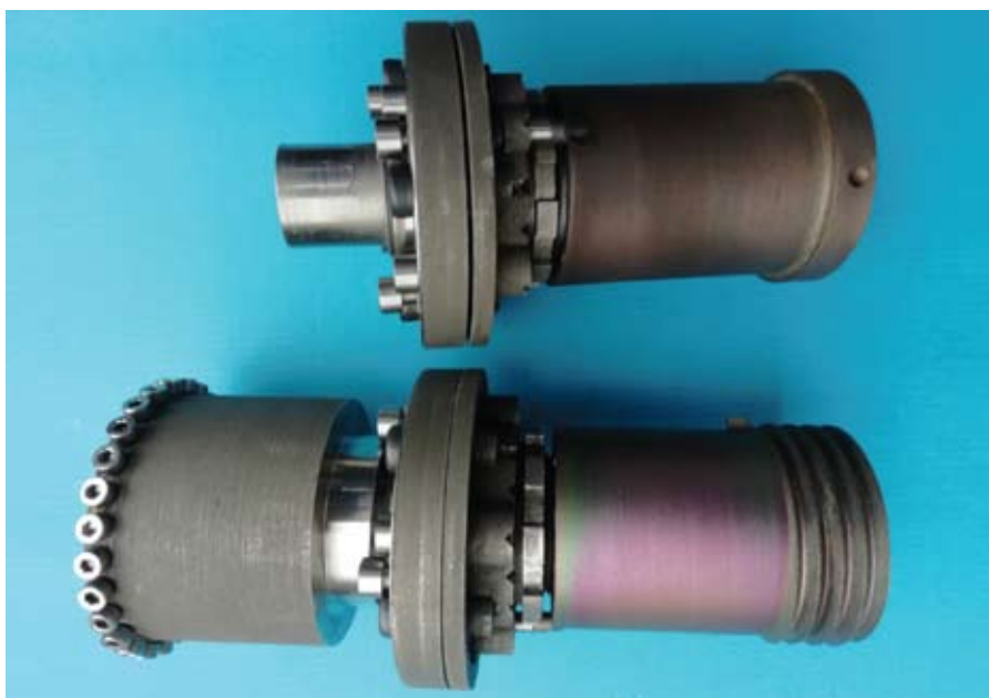
Рис. 1. Головки, произведенные по аддитивной технологии и разработанные в соответствии с индивидуальными требованиями двух заказчиков
