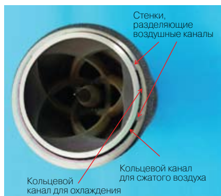
Рис. 4. Вид головки с торца (видны воздушные каналы и крепление дорна)
