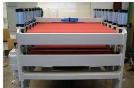
Роликовое тянущее устройство AZ 8, сторона выхода
