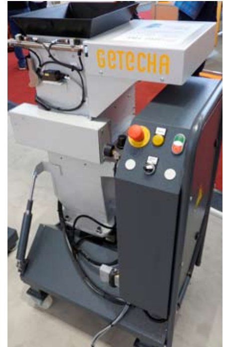
Дробилка для чистых помещений GRS 180 от Getecha отличается, помимо прочего, своей компактной (в первую очередь по высоте) конструкцией
