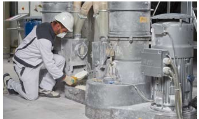
На заводе Blend+ в Дюрене используются смесительная линия и две производственные линии на базе технологии Hot Compaction с температурой переработки до 160°C
