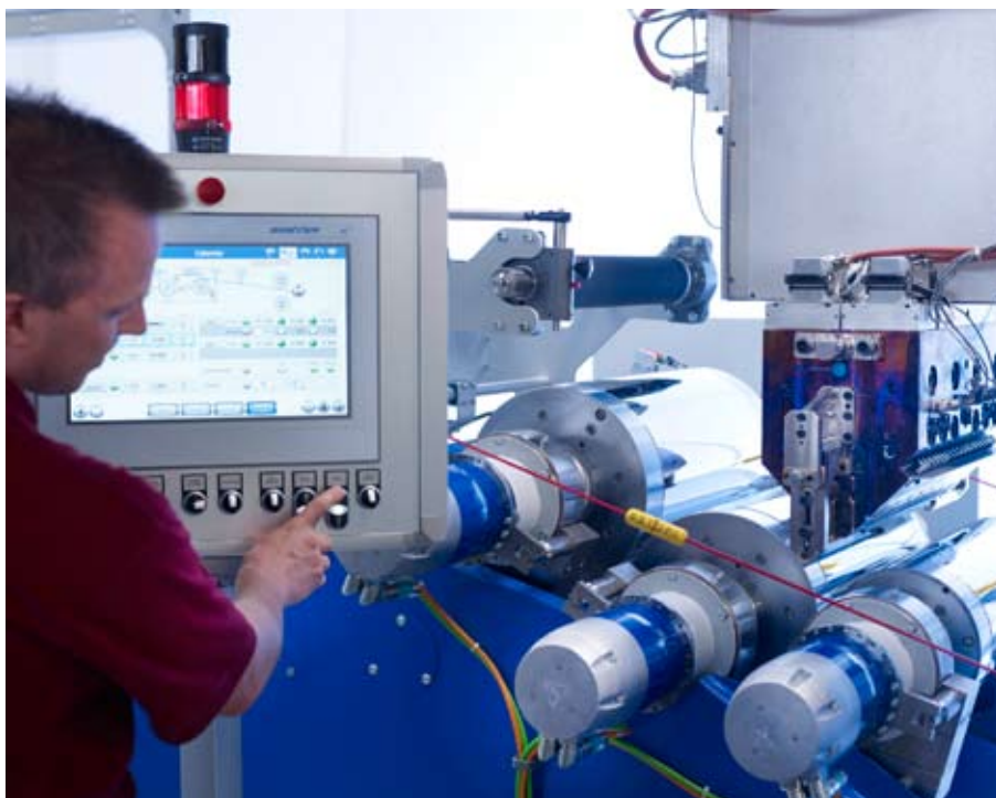
Система каландрования, обеспечивающая получение пленки с гладкой поверхностью с обеих сторон
