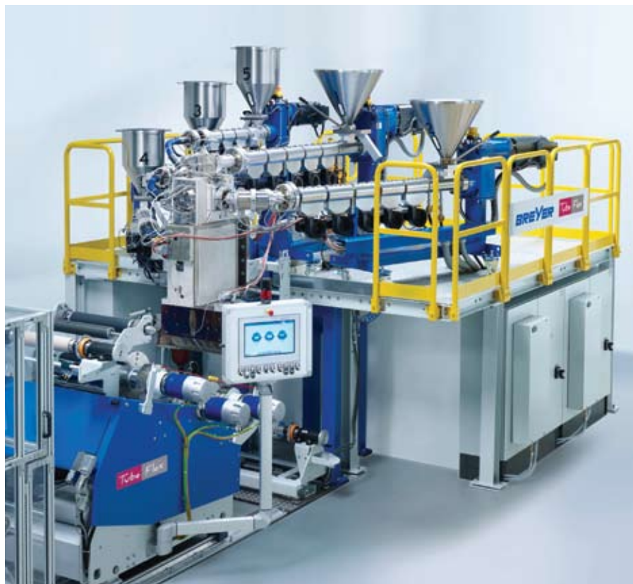
Оборудование Breyer TubeFlex для производства многослойных пленок для труб
