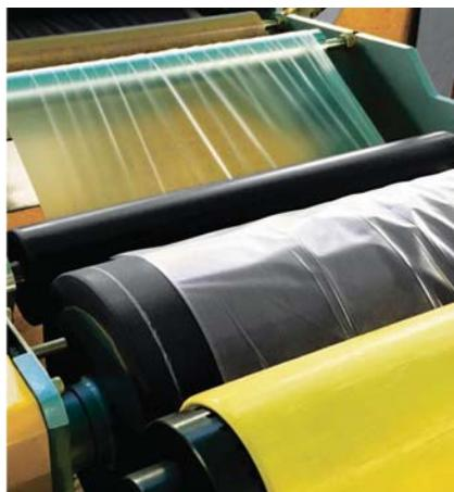
Вал с покрытием из токопроводящего полиуретана (черный)
