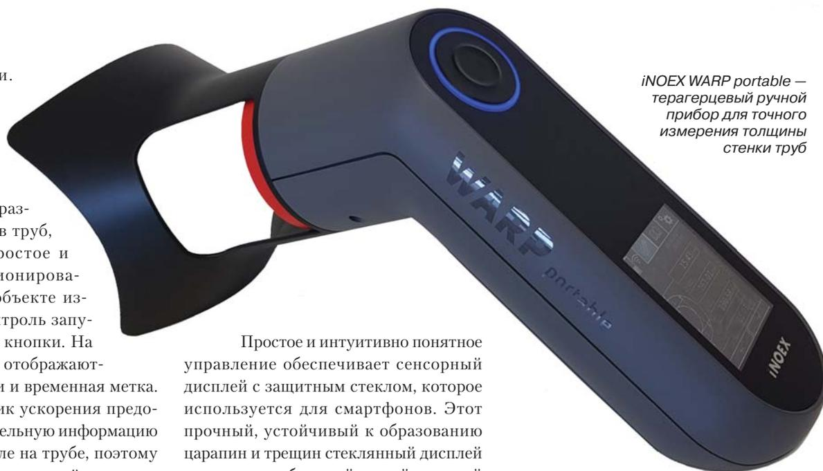
*iNOEX WARP portable — терагерцевый ручной прибор для точного измерения толщины стенки труб*
