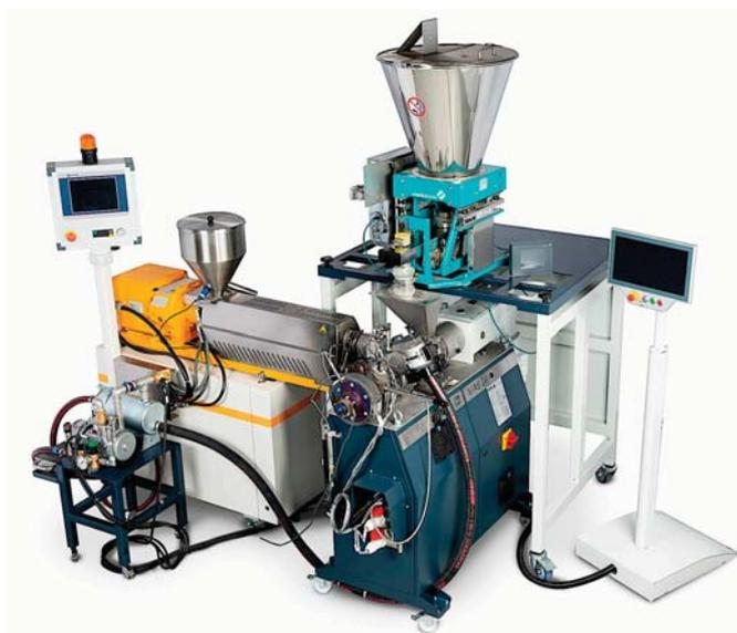
Рис. 2. Линия для компаундирования от компании MAS состоит из экструдеров с двумя однонаправленно вращающимися коническими шнеками, в которые загружаются добавки, и одношнекового экструдера с боковым питателем, отвечающим за загрузку основного полимера
