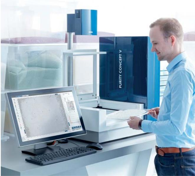
*Система PURITY CONCEPT V используется для оптического выборочного контроля полимерного гранулята. Помимо прочего, она обнаруживает черные пятна*
