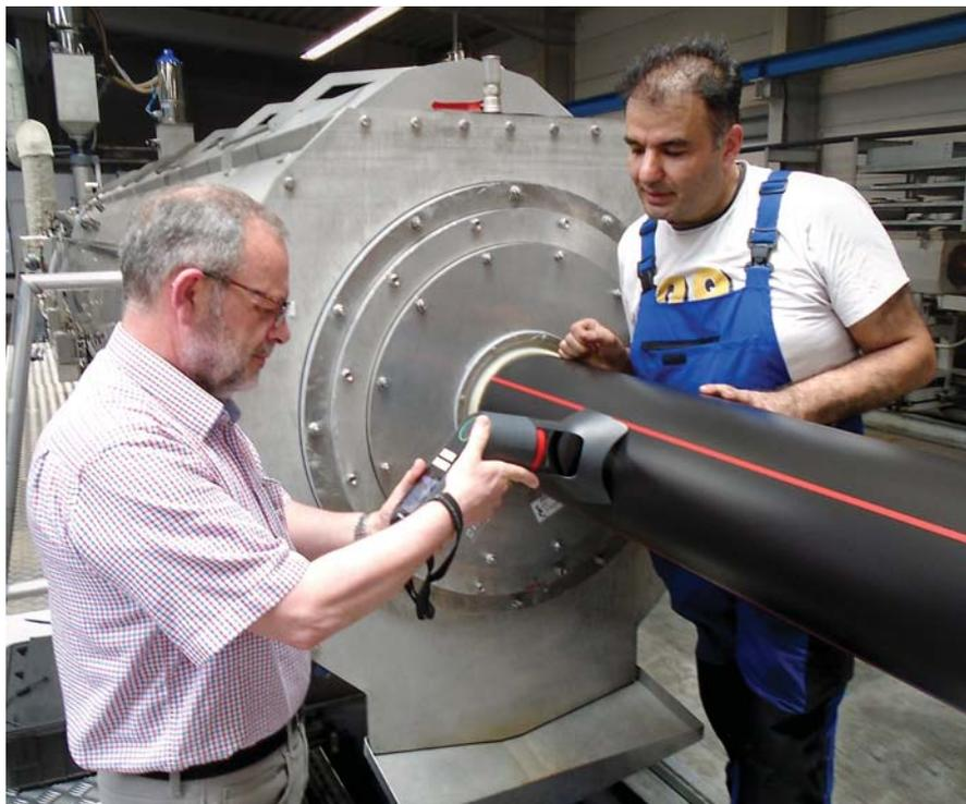
*Штефан Депмер, начальник производственно-технического отдела, и Тюркаян Гюнейик, начальник производства, контролируют толщину стенки трубы без остановки процесса экструзии с помощью толщиномера WARP portable*
