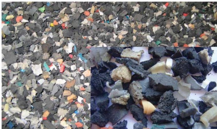
Рис. 3. Эластомерная фракция после разделения в сепараторе hamos RSS
