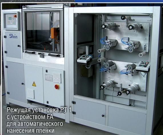
На все машины могут быть установлены дополнительные устройства. Например устройство автоматического нанесения пленки, а также измерительное колесо для точного определения длины профиля или нанесения маркировки чернилами или лазером.
