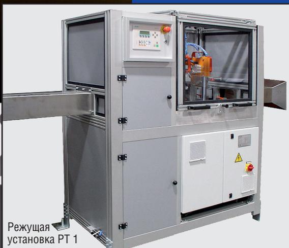
500 режущих установок PT 1 безупречно работают по всему миру, обеспечивая наилучшее качество резания штапиков для крепления стекла, различных профилей – небольшого сечения, оконных и технических. Скорость резания плавно регулируется, при этом время такта между двумя резами составляет от 2 до 4 с.
