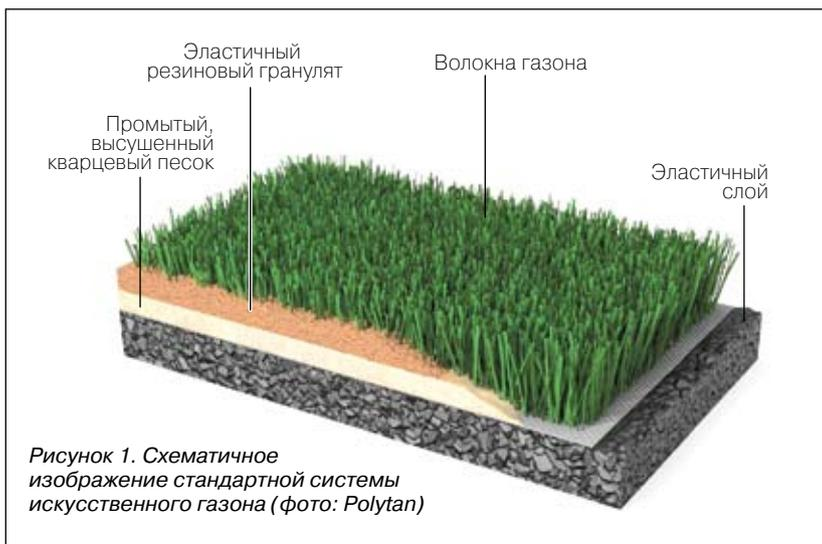
Рисунок 1. Схематичное изображение стандартной системы искусственного газона (фото: Polytan)
