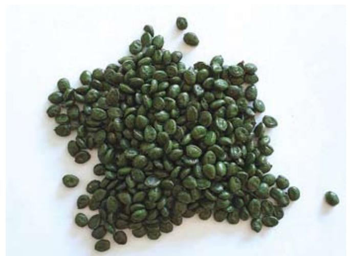
Рисунок 8. Конечный продукт вторичной переработки искусственных газонов — высококачественное сырье для новой продукции (фото: MAS)
