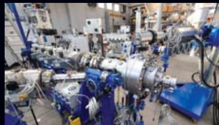
Экструзионная головка VENUS MULTI 2 PE
