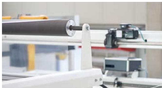
*Система контроля пленки OCS (FSP600) — камера OCS, установленная на линии по производству пленки*
