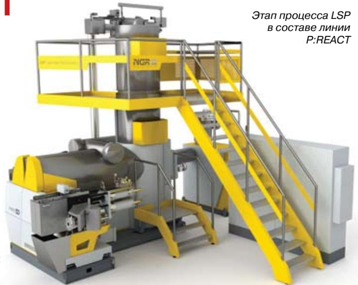
времени и постоянно настраивается на заданное заказчиком целевое значение с помощью автоматизированной системы регулирования вакуумного блока. За счет этого достигается требуемое качество материала и гарантируется постоянство значения характеристической вязкости, необходимой для последующей переработки материала.
