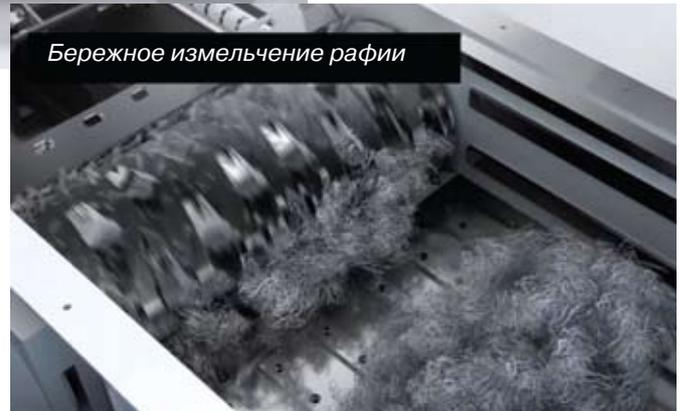
Рисунок 3. Вместо отдельного агломератора или пласткомпактора, длительно перерабатывающих материал при повышенной температуре, щадящий, но мощный одновалный шредер в составе Rego-One выполняет резку отходов ПП-рафии быстро и при гораздо меньшей температуре. Это помогает сохранить свойства переработанных отходов как можно ближе к качеству исходного сырья
