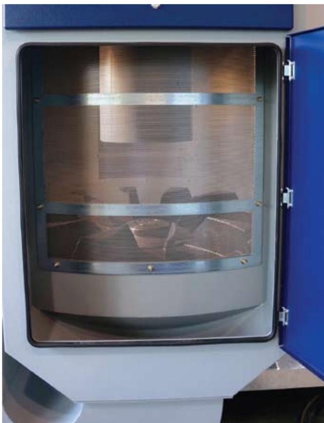
Рисунок 5. Вид камеры центрифугирования системы DRD 26 (через тангенциальную сетку); снизу — двойная роторная система с 12 лопастями, над ней — корпус регистра нагревателя (фото: Reinhard Bauer)
