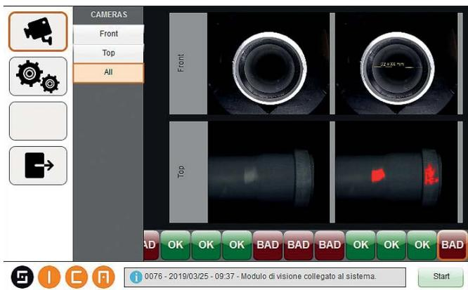
Рисунок 4. Показатель внутреннего диаметра уплотнителя (D2e) находится в допустимом диапазоне
