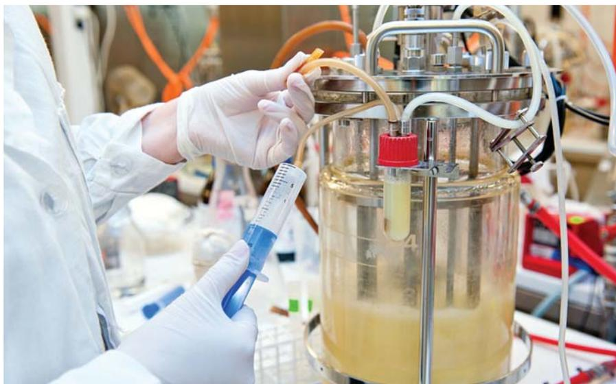
*Процесс отбора образцов из биотехнологического биореактора в микробиологической лаборатории не обходится без применения медицинских трубок*
