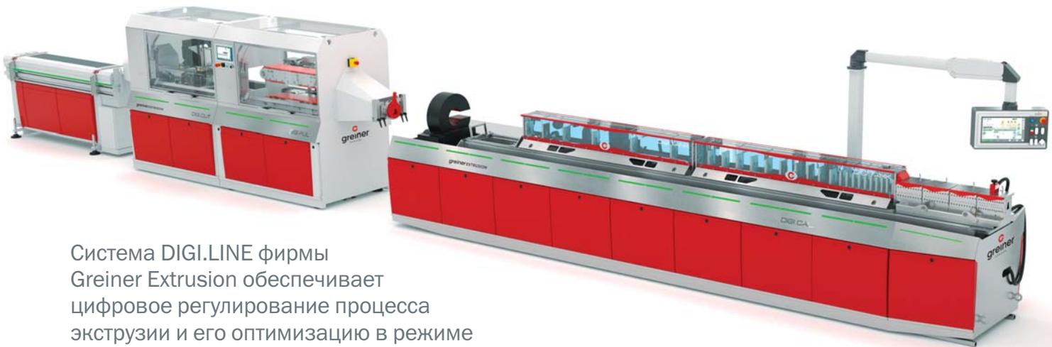
Система DIGI.LINE фирмы Greiner Extrusion обеспечивает цифровое регулирование процесса экструзии и его оптимизацию в режиме реального времени. Это относится к сфере производства как оконных, так и технических профилей. Длительные комплексные испытания на практике подтвердили существенную экономию материала при применении данного инструмента.
