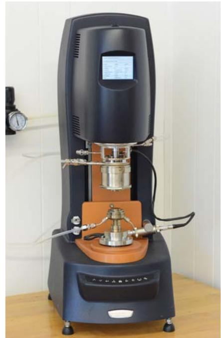
Гибридный ротационный реометр TA Instruments Discovery HR-2
