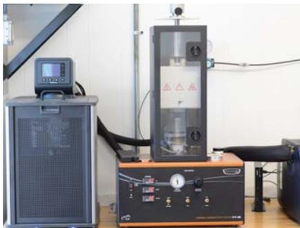
Измеритель теплопроводности TA Instruments DTC-300
