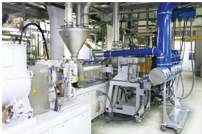
Два боковых питателя на двухшнековом экструдере подключены к системе дегазации Plastex, что обеспечивает повышение насыпной плотности наполнителя
