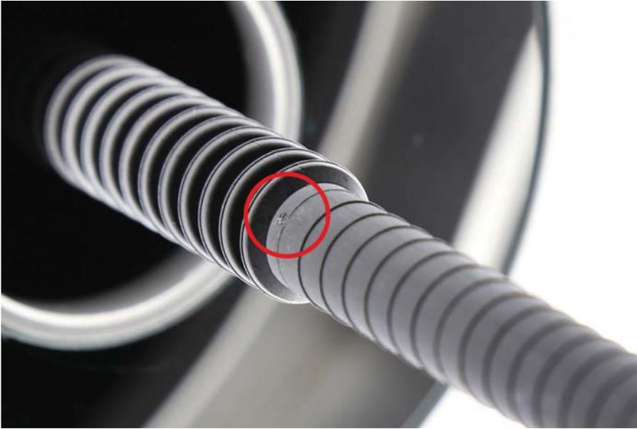
Даже малейшие дефекты (вроде показанной на фото крошечной вмятины на защитной трубе для автомобильной электропроводки) легко могут стать причиной нарушения безопасности эксплуатации транспортного средства
