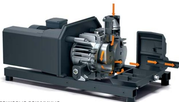
Кулачковые вакуумные насосы MINK являются основой систем дегазации Plastex. Благодаря бесконтактному принципу работы использование рабочей жидкости не требуется
