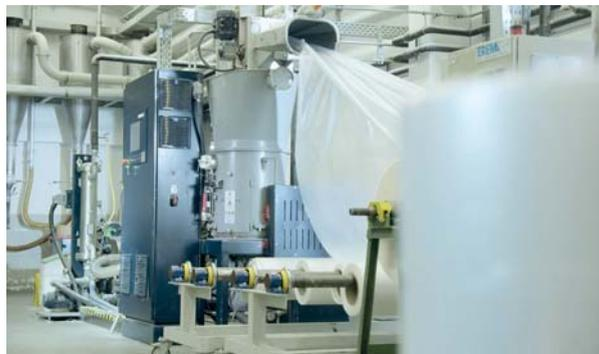
На предприятии Coveris система INTAREMA® K эксплуатируется 24 часа в сутки, возвращая переработанные обрезки пленок в производство (фото: EREMA)
