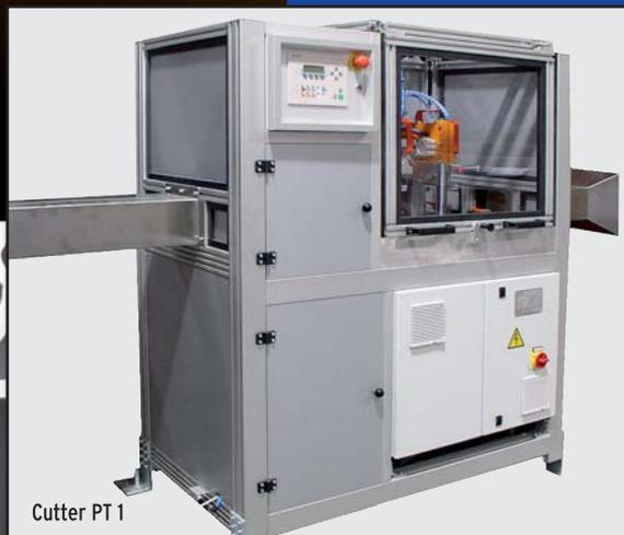
Эта режущая установка, 500 экземпляров которой безупречно работают по всему миру, обеспечивает наилучшее качество резания оконных штапиков, малых профилей, основных профилей и технических профилей. Скорость резания регулируется плавно, при этом получаются длительности такта прикл. от двух до четырёх секунд.
