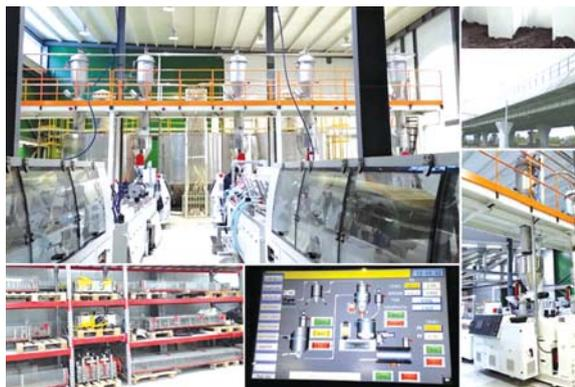
непластифицированного ПВХ. Шнеки и цилиндры изготовлены из стали 38CrMoAlA и азотированы. Экструдеры оснащены приводами Siemens с инверторами АВВ. Конструкция редуктора рассчитана на большие нагрузки при работе на максимальных режимах. Вертикальное исполнение редуктора позволяет сэкономить производственные площади. Машины имеют компьютерное управление Siemens с цветным сенсорным дисплеем.
