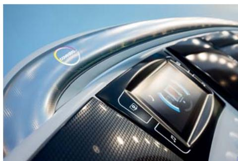
*Актуальная тенденция: бесшовная интеграция дисплеев в трехмерную формованную поверхность панели приборов*
