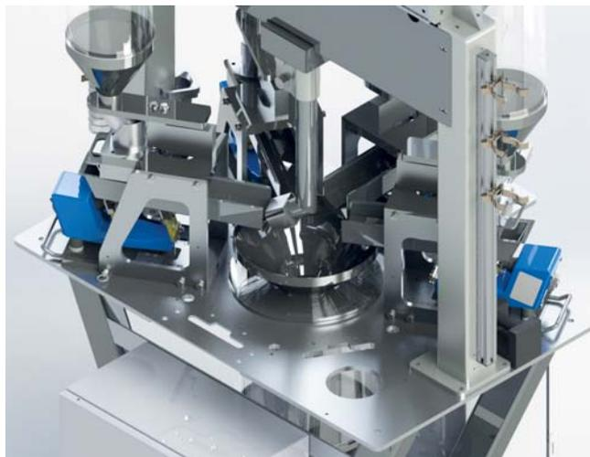
воздуха. При использовании режима Rundown, разработанного фирмой Advanced Blending Solutions, смена материала происходит примерно за 20 с в зависимости от объема весов.
