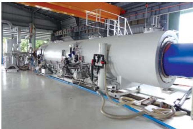
Производство многослойной трубы наружным диаметром 1200 мм с внешним слоем из ПЭ-100 HSCR на заводе Authentic Production в Мьянме
