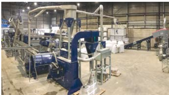
Производительность новой линии составляет от 8 до 12 т регранулята за 8-часовую смену в зависимости от качества перерабатываемого сырья
