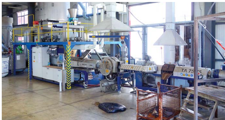
Рисунок 5. Подготовленные пленочные хлопья, предварительно просушенные после моечной установки, подаются в каскадную экструзионную линию MAS, состоящую из двухшнекового экструдера с коническими шнеками, дискового фильтра и одношнекового дегазационного экструдера
