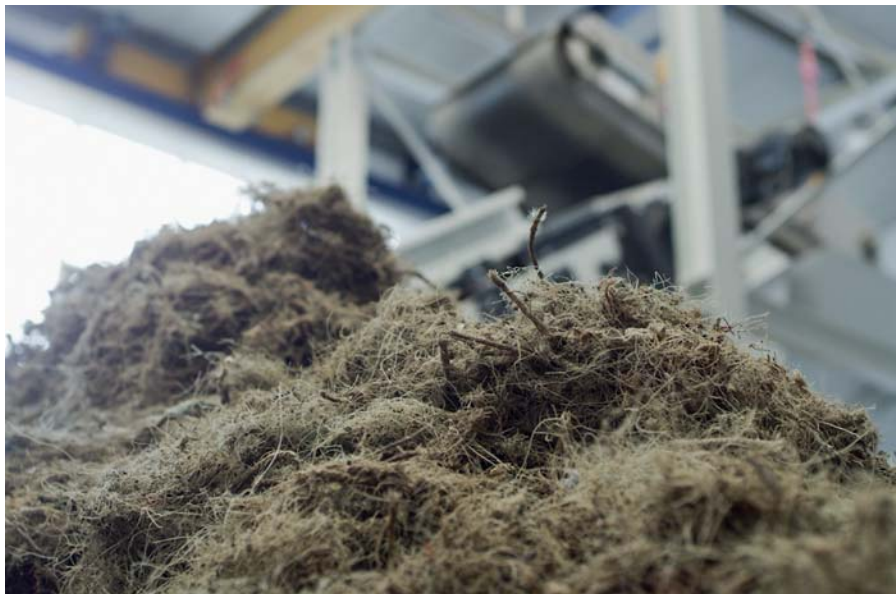
С помощью подбора ротора и неподвижного ножа, а также выбора соответствующей сетки измельчитель может быть точно настроен под требования входящего и готового материала
