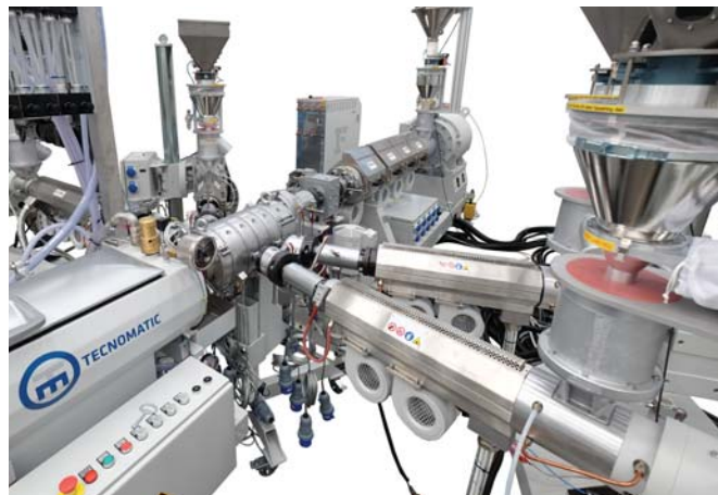
Высокоскоростная линия для изготовления пятислойных труб из сшитого полиэтилена и полибутена
