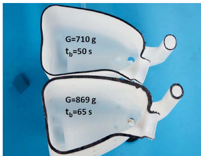
Рис. 1. Распределение толщины стенки, масса и время цикла, достигнутое с помощью фильеры с GWDS
