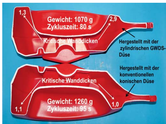
Рис. 5. Оптимизация фильеры для изготовления прицепа для машинок Bobby Car
