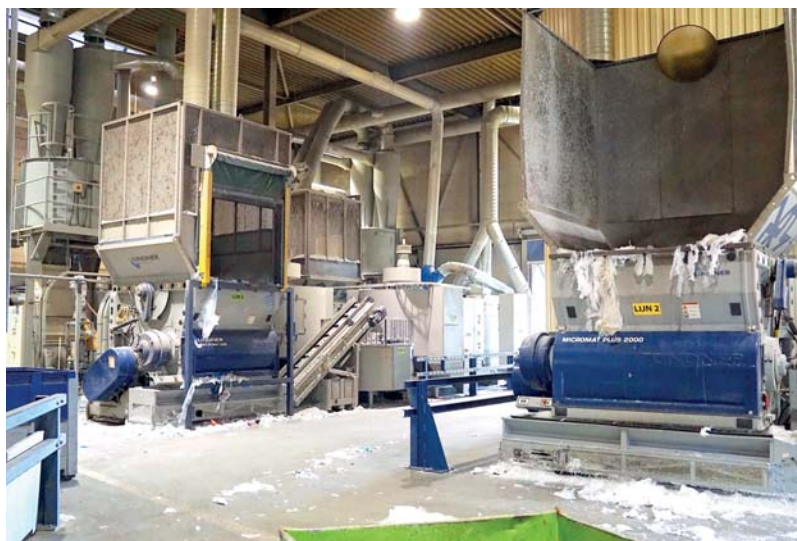
Кипы с пленкой измельчаются ножевыми дробилками в хлопья, которые затем подаются партиями в систему сухой очистки MAS-DRD, которая удаляет зернистые примеси и влагу
