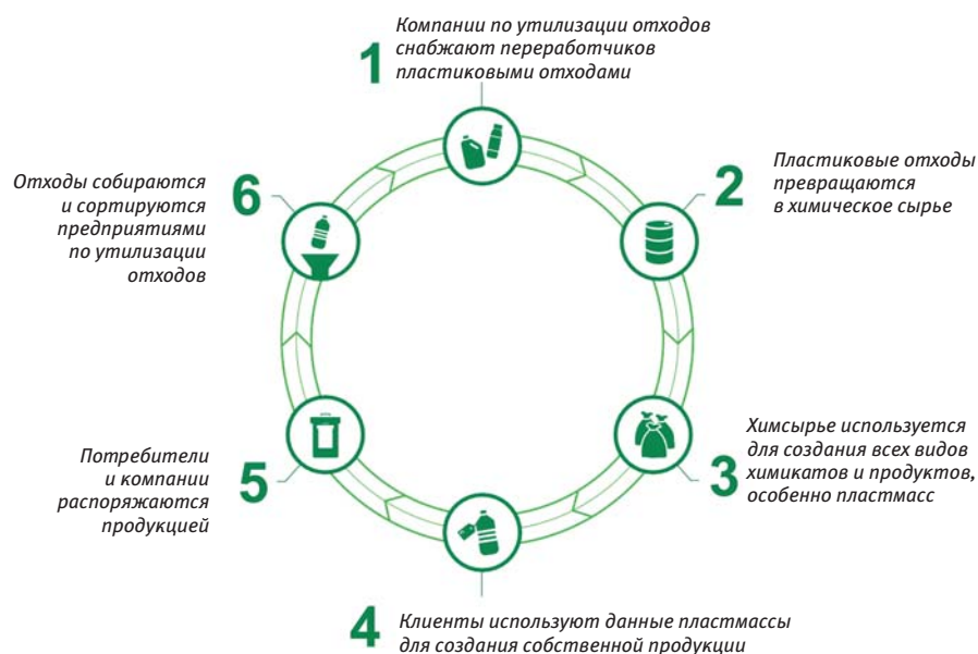
Схема функционирования проекта ChemCycling
