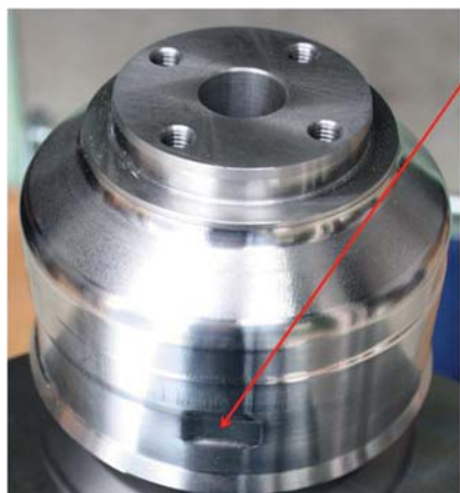
Рис. 2. Для получения требуемой толщины стенки 1 мм в начале резьбы заливной горловины канистры при использовании конического проточного канала необходимо значительно увеличить толщину стенки по всей окружности и по всей длине горловины
