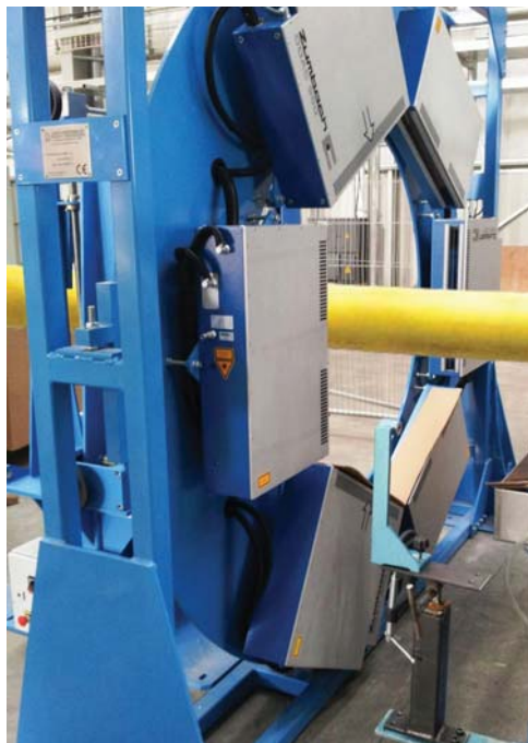
Рис. 2. 3-осевая система ODAC® 550 для измерения подводного кабеля с наружным диаметром 500 мм
