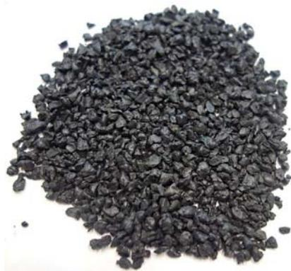
Рис. 3. Агломерат с насыпной плотностью 300 г/л
