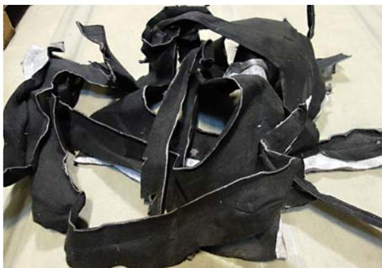
Рис. 2. Отходы ковриков от элементов обшивки салонов автомобилей
