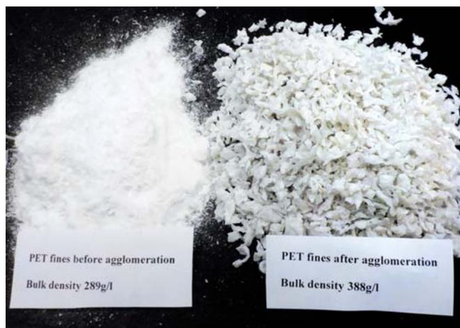
Рис. 5. Пыль от отходов ПЭТ до и после компактирования в пласткомпакторе HERBOLD
