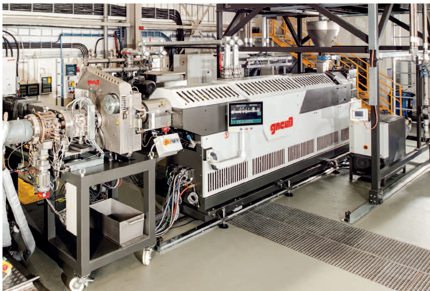
MRS130多螺杆挤出机，RSFgenius 150旋转过滤器，VIS在线粘度测试仪和格诺斯压力传感器
