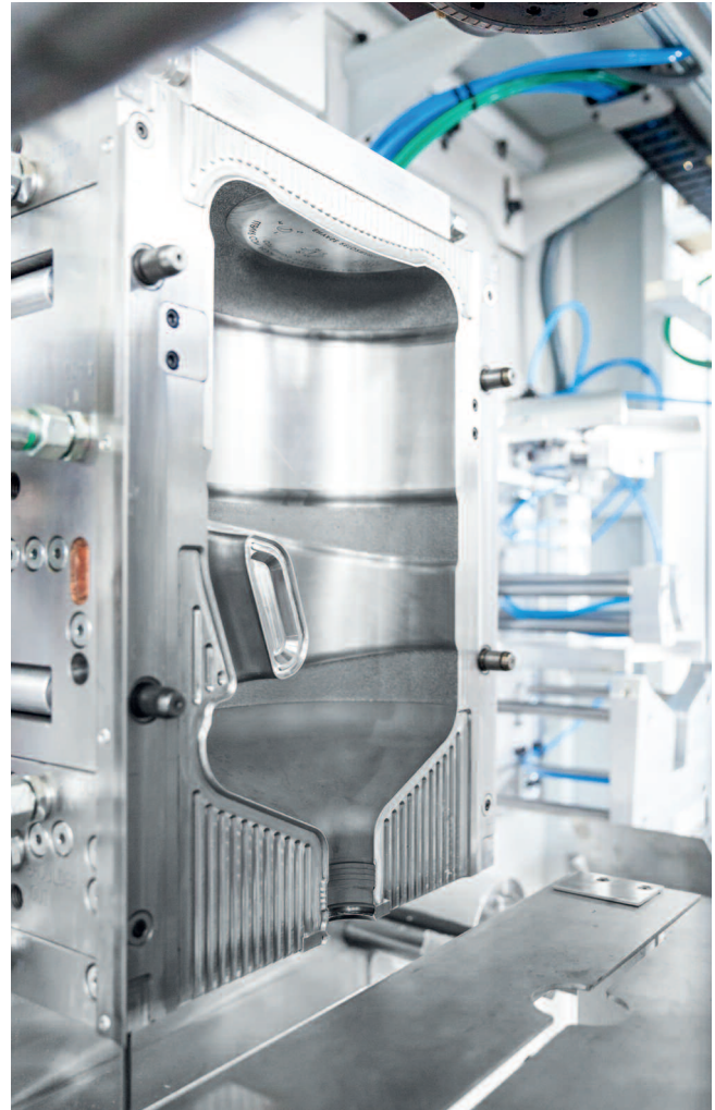
打开的中空成型模具，带有多区温度控制，用于生产PC原料制成的水桶
