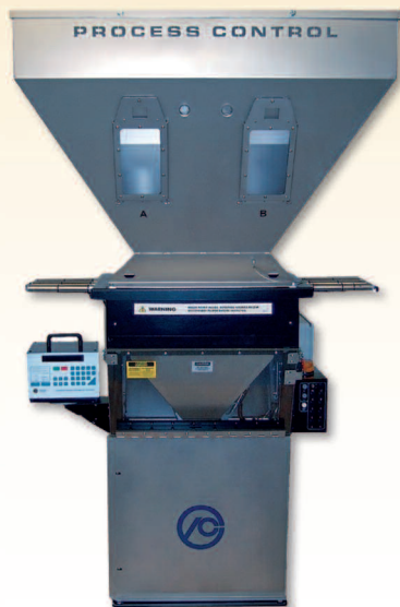
Guardian®: Gravimetrischer Chargenmischer für bis zu 12 Komponenten
