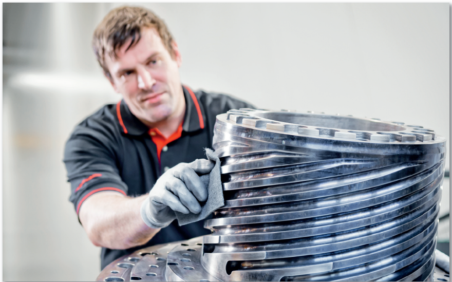
Der Blaskopfservice bei W&H reinigt alte Blasköpfe und beseitigt Verschleißerscheinungen – die Blasköpfe arbeiten wieder wie neu
