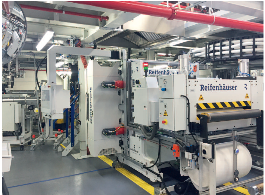
Das mechatronische Glättwerk MIREX-MT der Reifenhäuser Cast Sheet Coating für Barrierefolien-Anwendungen (Foto: RPC Bebo Plastik)
