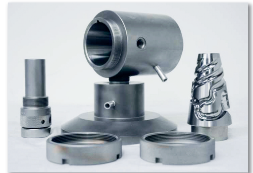
Fotos von der Bullet II zeigen das Fehlen von Befestigungsteilen, das heißt Muttern und Schrauben, um die Demontage, Reinigung und den Neustart zu erleichtern
