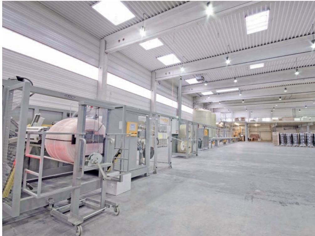
Komplette Produktionslinie zur Herstellung 5-schichtiger PE-RT Rohre
