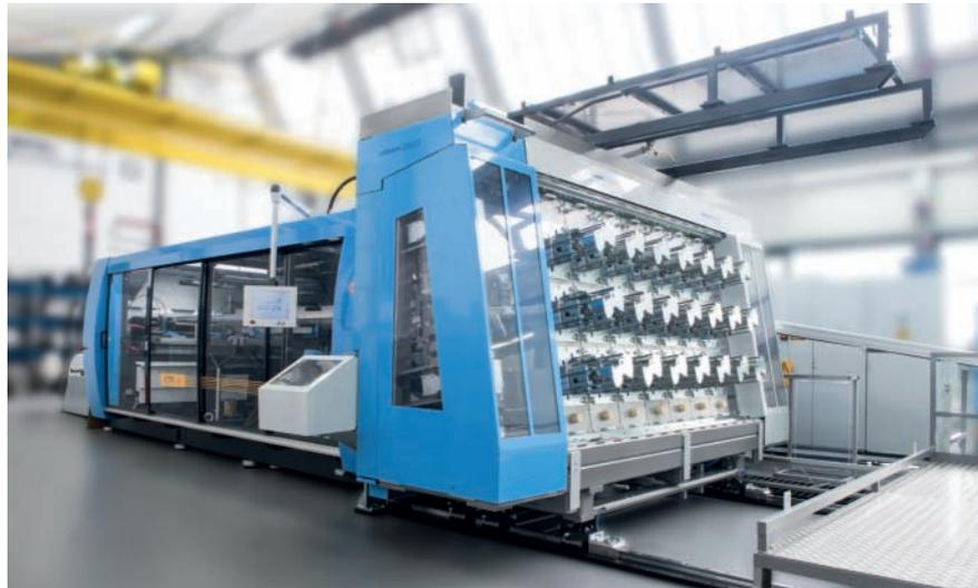
Bild 1 a+b: Druckluftformanlage KTR 6.1 T-IML – Becher und Etiketten sind in jeder Form möglich
