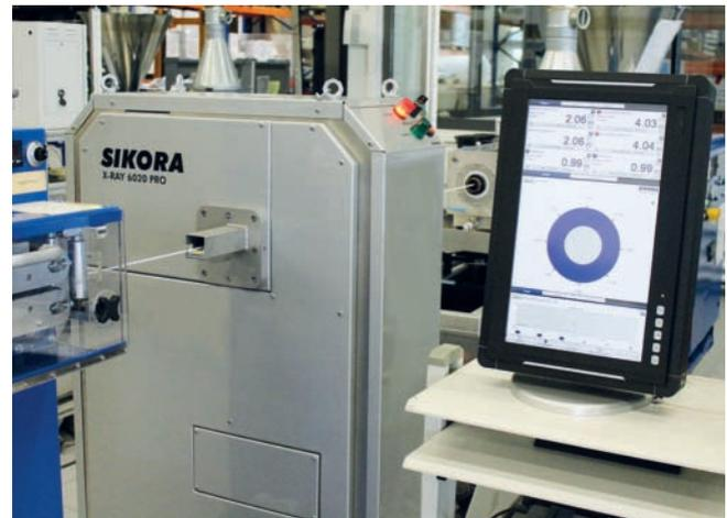
*Das SIKORA Röntgenmesssystem X-RAY 6000 misst sämtliche Schlauchparameter. Am Monitor des Prozessorsystems ECOCONTROL 6000 werden die Produktdaten visualisiert*
