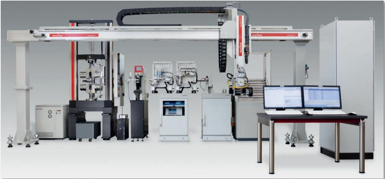
*Roboter-Prüfsystem roboTest P*
