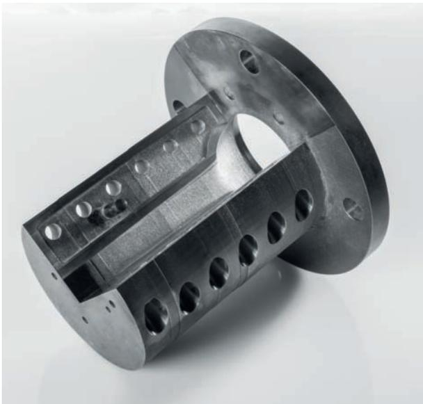
Die Herstellung von Kunststoffprofilen und -folien erfolgt mit hochentwickelten Werkzeugen, deren Geometrien genau auf die Fließeigenschaften der Kunststoffe abgestimmt sind. Diese Abstimmung bedarf oft langer Iterationsschleifen in Simulation und Experiment. Diese Schleifen stellen einen erheblichen Kosten- und Zeitfaktor dar und bedrohen perspektivisch die Fertigung in Hochlohnländern.
