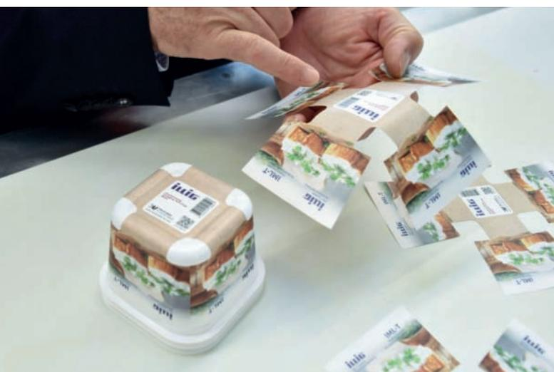
IML-T-Labelzuschnitt und IML-T-dekorierter Becher an der RDML 70b Maschine von ILLIG
