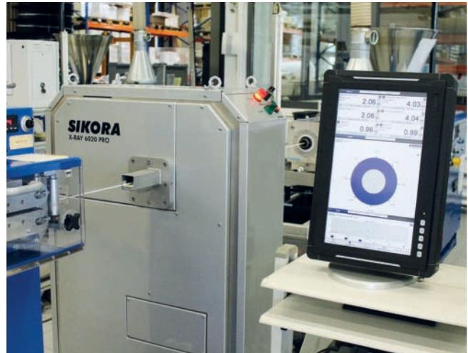
Das SIKORA Röntgenmesssystem X-RAY 6000 misst sämtliche Schlauchparameter. Am Monitor des Prozessorsystems ECOCONTROL 6000 werden die Produktdaten visualisiert
