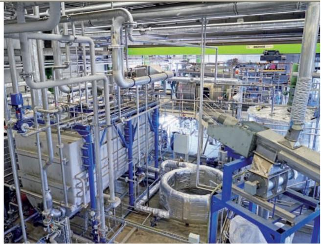
*Die Trenntechnik Ulm GmbH hat in Memmingen eine maßgeschneiderte Anlage zur chemischen Trennung von PA/PE-Verbundfolien aufgebaut. Mit diesem Verfahren und einem geeigneten Lösungsmittel könnten zukünftig auch andere Rohstoffe zurückgewonnen werden
