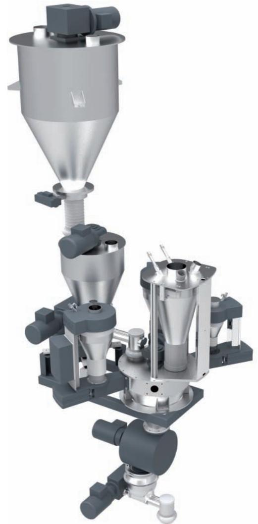
PVC Dosierstationsprinzip mit SAVEOMAT HF Komponente
