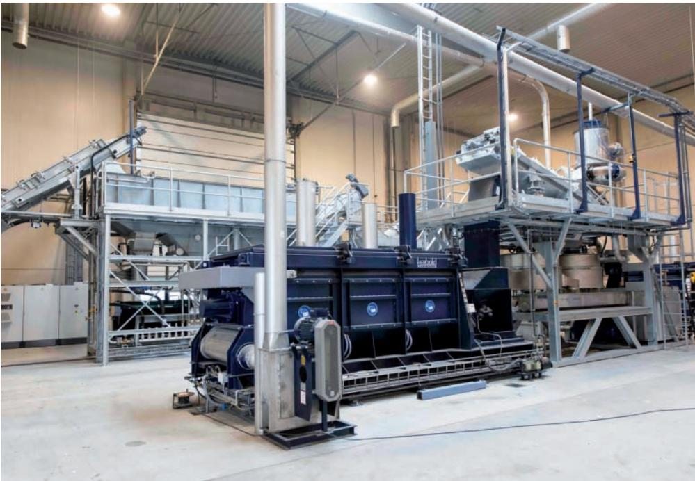
**Bild 3: Hydrozyklon und Trockner, im Hintergrund Vorwascheinheit**
