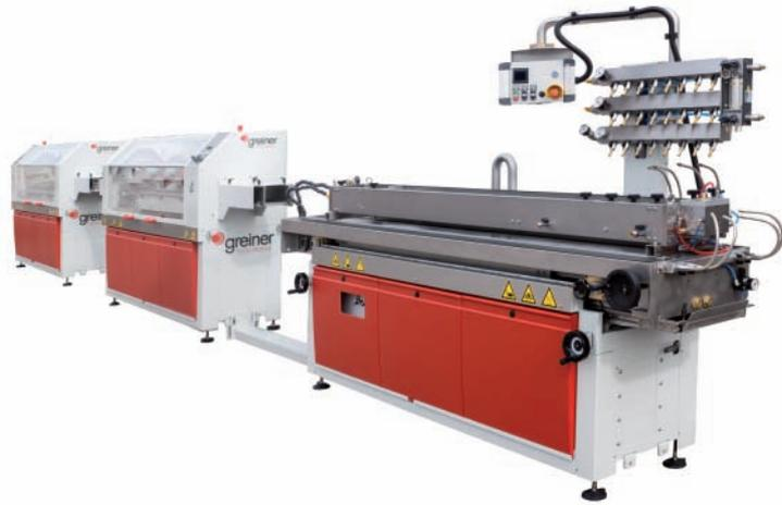
Greiner TEC.TOOL und TEC.LINE sind Werkzeug- und Maschinen-Lösungen für die Extrusion kleiner Voll- und Hohlkammerprofile. Bei der Entwicklung fokussierte das Team des Branchenspezialisten Greiner auf die höchstmögliche Steigerung der Produktivität und eine kompakte, modulare Bauweise.
