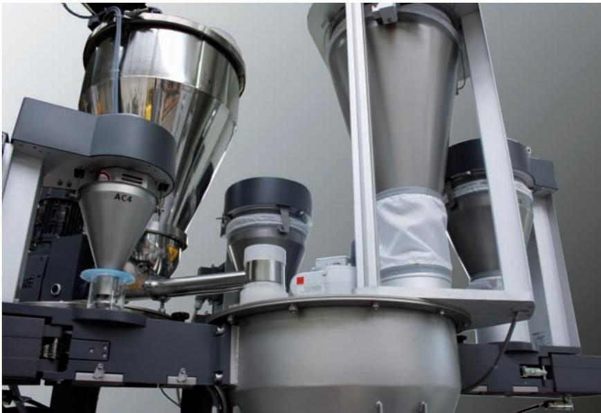
PVC Dosierstation mit SAVEOMAT HF Komponente
