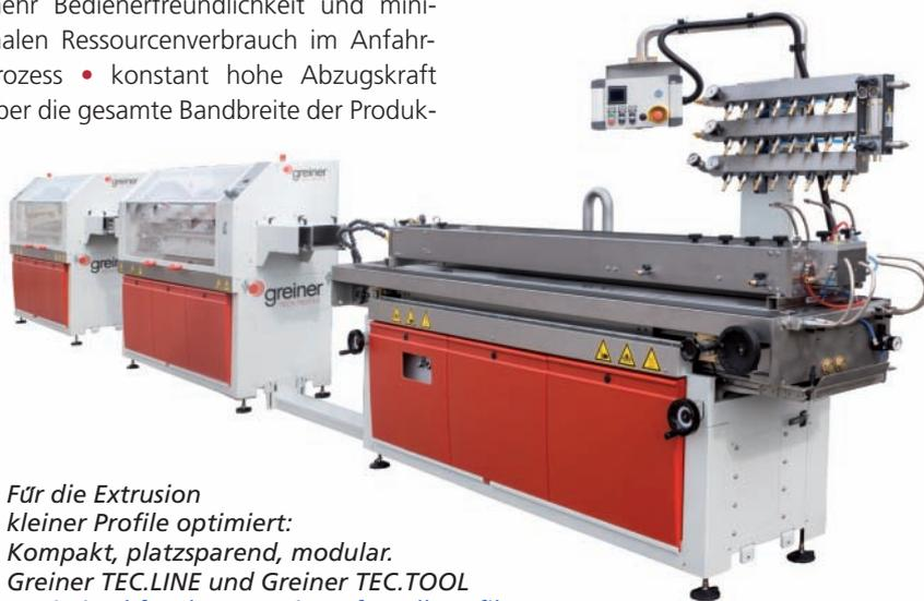
Für die Extrusion kleiner Profile optimiert:
