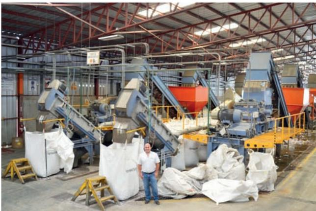
Nach der Sortierung werden die PET-Flaschen in zwei Herbold Schneidmühlen mit einer Leistung von je 1800 kg/h zerkleinert. After sorting, the PET bottles are size reduced in two Herbold granulators each with a capacity of 1800 kg/h
