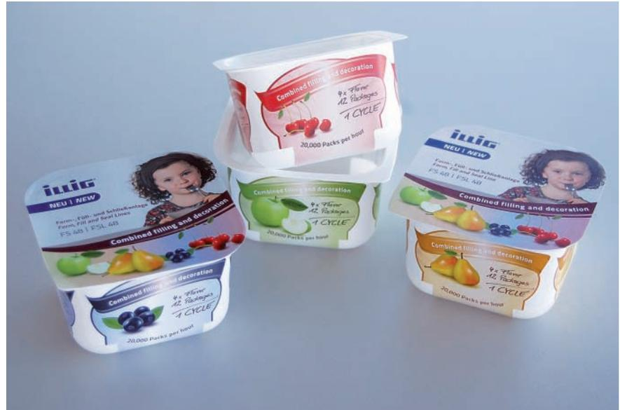
Die Mehrspurigigkeit der FSL 48 ermöglicht das Abfüllen von Produktfamilien, beispielsweise mit unterschiedlicher Geschmacksrichtung, in individuell durch IML-Thermoformen dekorierte Packungen
