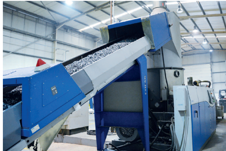
Die seit 2007 laufende EREMA 1514 TVE sorgt bei Ambigroup Reciclagem in Chamusca, Portugal für eine hohe Regranulatqualität. Die Maschine ist mit Double Disc, Air Flush Modul und Laserfilter ausgestattet (Alle Bilder: EREMA)
