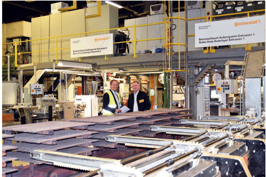
In der Bremschlauchfertigung bei ContiTech in Korbach sorgt SIKORA Röntgenmesstechnologie für die inline Qualitätskontrolle. Von links: Peter Hügen (Vertriebsingenieur SIKORA AG), Jan Eric Theis (Leiter Plant Engineering Schläuche ContiTech GmbH)
