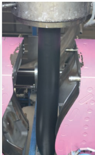
Bild 6: Abgekühlter, unverstreckter Vorformling mit einer maximalen Wanddicke von 9,5 mm und einer minimalen von 6 mm (linkes Bild) sowie aus der Düse ausgetragener Vorformling kurz vor dem Schließen des Werkzeugs (rechtes Bild)
