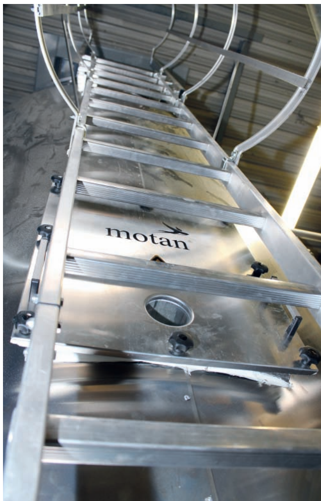
Technik bis unter die Decke – um die gewaltigen Durchsätze sicherzustellen, wurde eine der Linien um diesen Trockentrichter mit einem Fassungsvermögen von 7500 l erweitert
