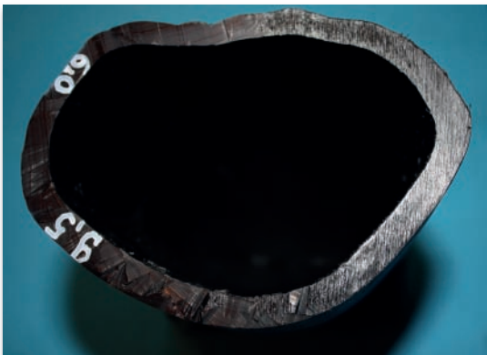
Bild 6: Abgekühlter, unverstreckter Vorformling mit einer maximalen Wanddicke von 9,5 mm und einer minimalen von 6 mm (linkes Bild) sowie aus der Düse ausgetragener Vorformling kurz vor dem Schließen des Werkzeugs (rechtes Bild)
