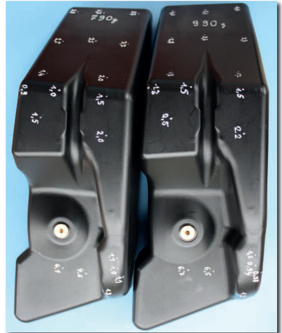
Bild 7: Vergleich der Wanddickenverteilung zwischen dem konventionell hergestellten Behälter (Gewicht 990 g) und dem mit der nachgerüsteten GWDS-Düse gefertigten Behälter (Gewicht 790 g)
