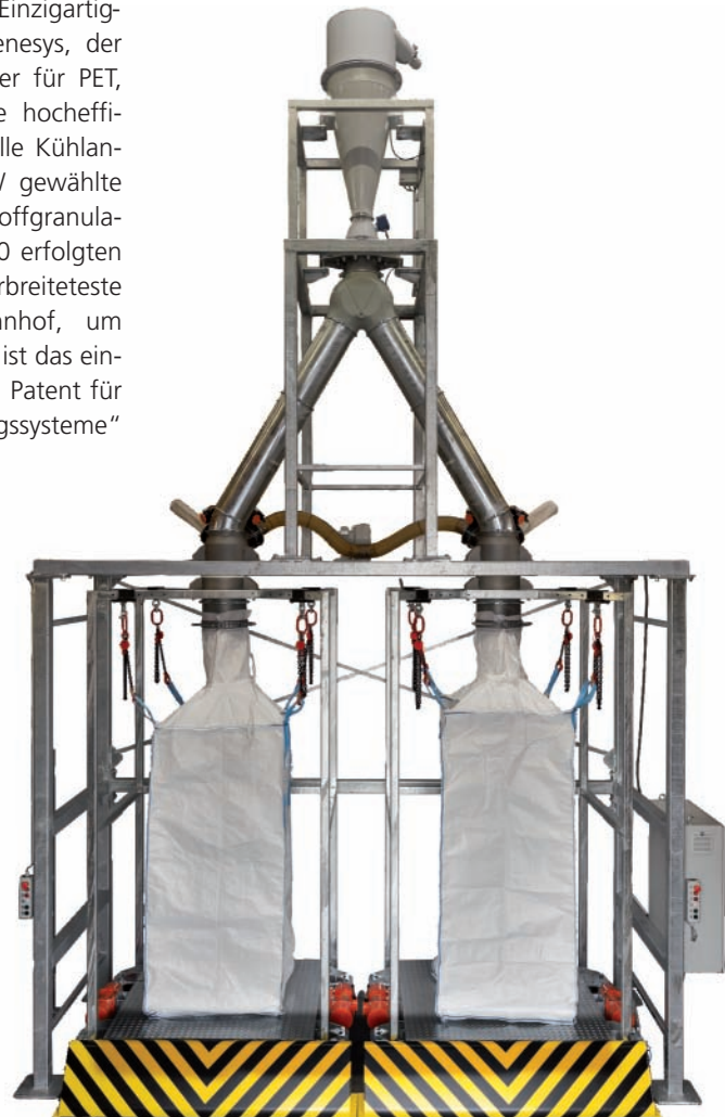
Big Bag Stationen von FDM sind maßgeschneiderte Lösungen für das Big Bag Handling in der Kunststoffindustrie. Das Bild zeigt eine Big Bag Befüllstation mit Wiegeeinrichtung
