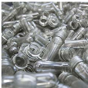
Пригодные для контакта с пищевыми продуктами преформы, полученные из ПЭТ-хлопьев
