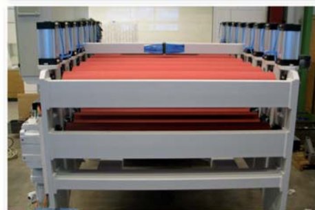
Роликовое тянущее устройство AZ 8, сторона выхода
