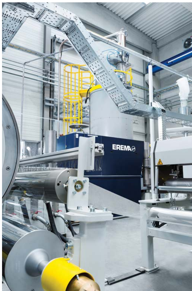
Все за один цикл: входящий материал попадает из MPR в экструзионную систему, а затем перерабатывается в инлайн-продукт (лист) (все фото: EREMA, Humer / Wallmen)
