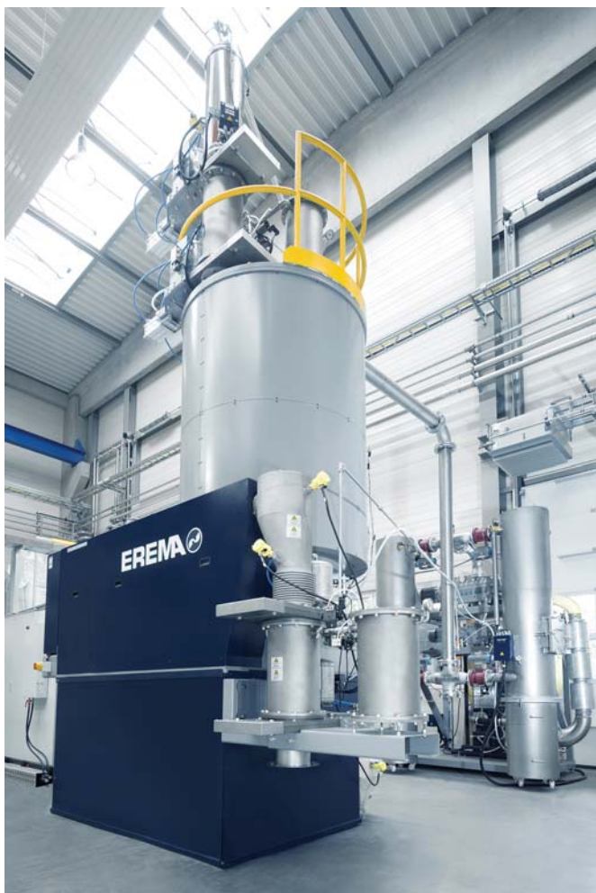
MPR от EREMA обеспечивает деконтаминацию, сушку, удаление пыли и кристаллизацию различных входящих ПЭТ-материалов до этапа экструзии
