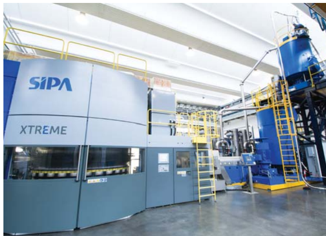
Новая инлайн-система для производства ПЭТ-преформ
