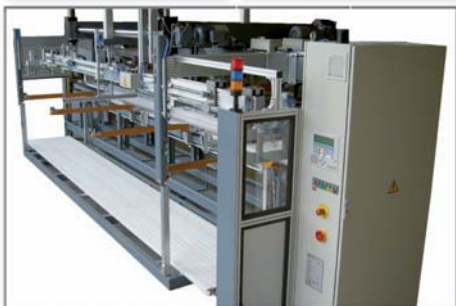
Автоматический штабеле- укладчик PRO 63
