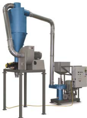
Мельница для тонкого измельчения Maag REX basic
