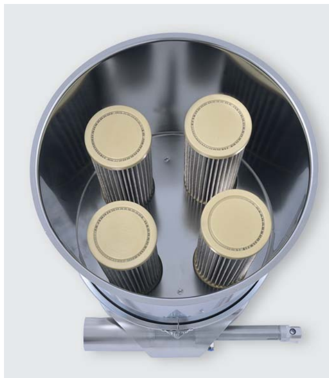
При транспортировке порошка фильтр и порошок обязательно должны соответствовать друг другу, в противном случае возникает опасность того, что частицы смогут пройти сквозь фильтр или закупорить его (фото: motan-colortronic)
