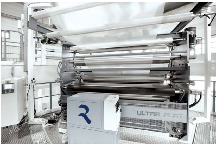
Линия вытяжки пленки EVO Ultra Flat
