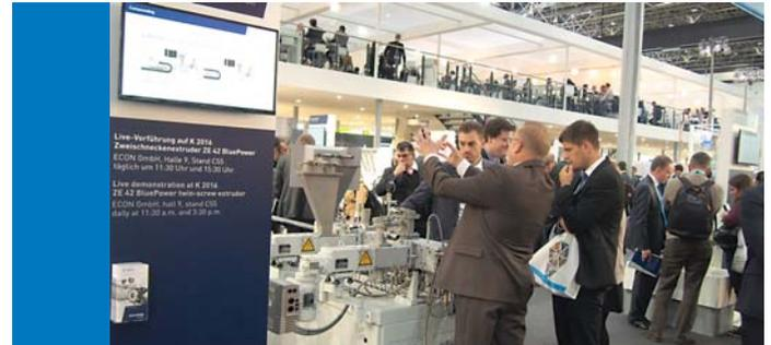
Двухшнековый экструдер ZE 42 BluePower предназначен для компаундирования и характеризуется низким энергопотреблением. Во время выставки он работал на стенде фирмы ECON в составе линии для получения гранул из ЛПЭВД
