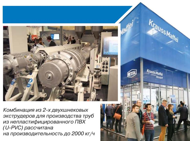
Комбинация из 2-х двухшнековых экструдеров для производства труб из непластифицированного ПВХ (U-PVC) рассчитана на производительность до 2000 кг/ч
