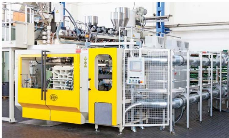
Новая электрическая машина EBLow 37 с усилием смыкания 370 кН и шириной поля формования 700 мм
