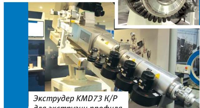
Экструдер KMD73 K/P для экструзии профиля (все фото: пласткуррьер-ЭКСТРУЗИЯ)
