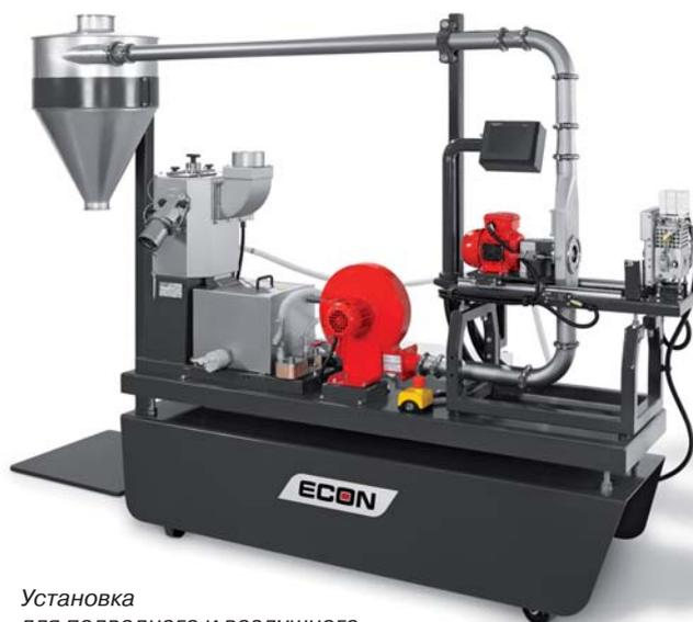
Установка для подводного и воздушного гранулирования EWA 10
