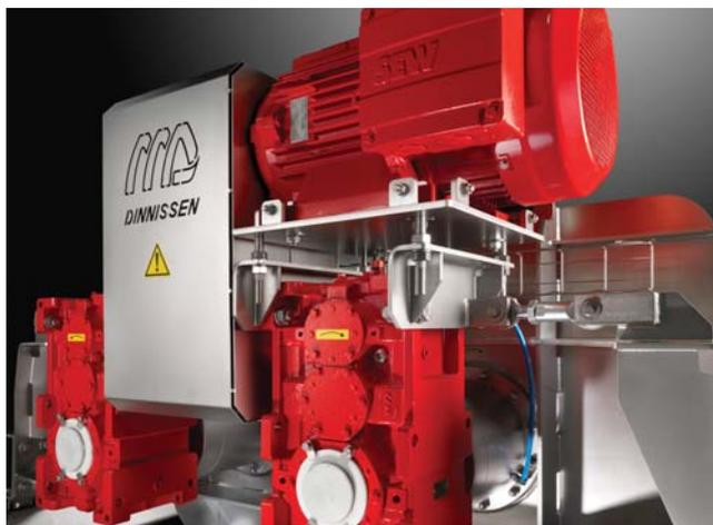
Хорошо известные смесители Pegasus®, представленные на выставке К-2016, имеют две оси смешивания, вращающиеся в противоположных направлениях. В результате образуется псевдооживленная зона смешивания, обеспечивающая за короткое время исключительную однородность смеси, но расходующая при этом минимум энергии.
