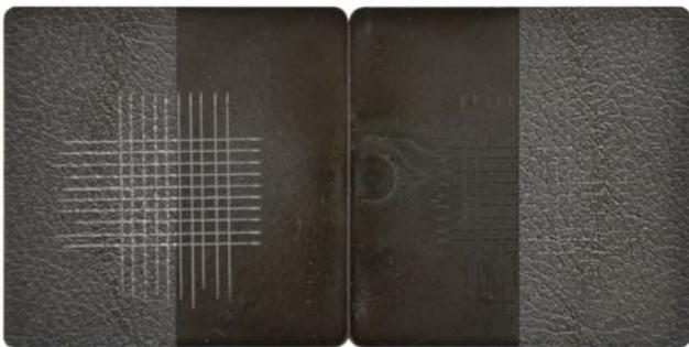
Тест на устойчивость к царапинам на образце пластика, используемого в автомобилестроении, изготовленном без применения добавок Croda (слева) и с применением их (справа)
