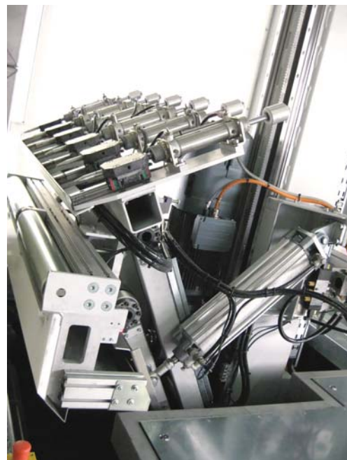
То, что привлекает внимание при взгляде на линию переработки пластмасс компании Getecha: параллелограммный захват-толкатель (здесь в исходном положении) со встроенными измерительными датчиками, предназначенный для полностью автоматической подачи сложенных в штабель полипропиленовых панелей в мельницу (фото: Stoecker)
