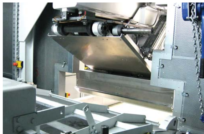
Взгляд из звукоизолирующей кабины мельницы: хорошо видна широкая передняя плита секции толкателя манипулятора Getecha, который в своем исходном положении располагается непосредственно перед втягивающими валками мельницы (фото: Stoecker)
