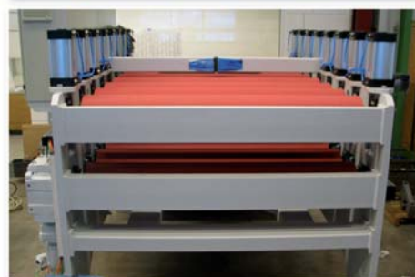
Роликовое тянущее устройство AZ 8, сторона выхода
