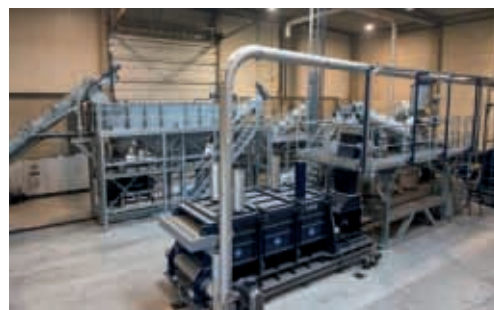
Гидроциклон и сушилка, на заднем плане система предварительной мойки
