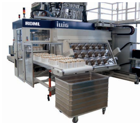
На выставке будет продемонстрировано изготовление декорированных полипропиленовых упаковок за одну операцию на формовочном автомате ILLIG IC-RDML 70 с 18-местной пресс-формой
