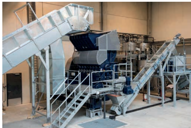
Шредер HGM 60/200 для дробления с водой
