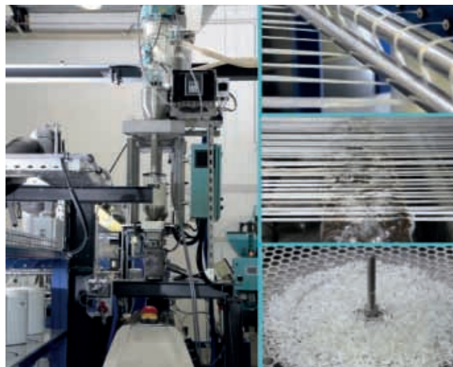
Оборудование ProTec позволяет изготавливать высококачественные армированные волокном грануляты по технологии пултрузии Фото: ProTec Polymer Processing
