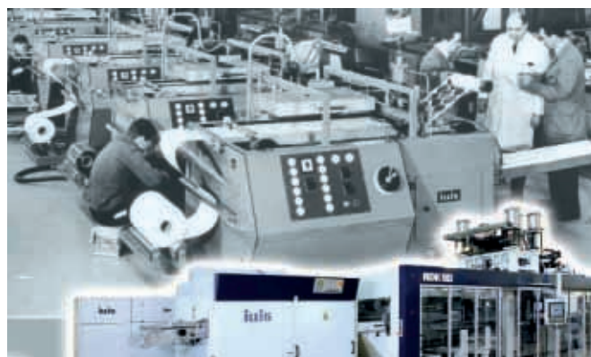
Между первым формовочным автоматом R 650 с рулонной подачей, который появился в 1960 г. (на фото сверху: RDM 37), и современным рулонным автоматом RDK 90 (внизу), работающим в режиме формование-вырубка, лежит 50-летняя история развития. Сегодня на современных машинах со скоростью 55 циклов в минуту производятся поддоны (Фото: ILLIG)
