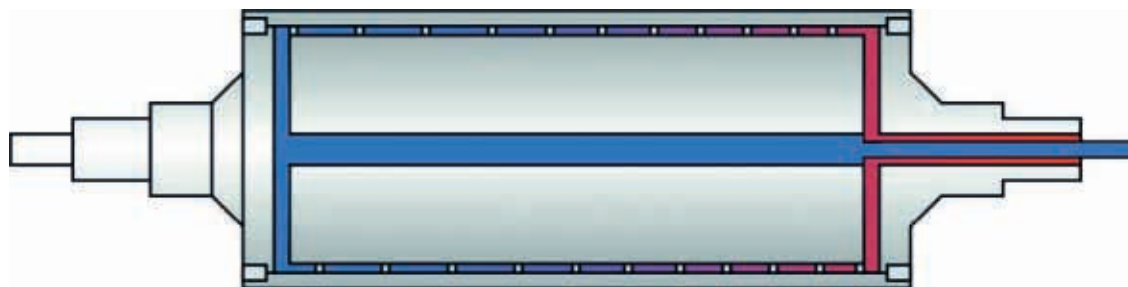
Рис. 2 : Валец с дегресивной спиралью охлаждения
