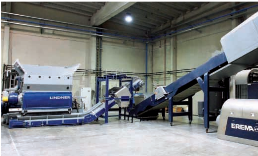
Комбинация измельчителя Micromat Plus 2000 и установки INTAREMA® 1714 TVEplus® на предприятии Tivaco: измельчитель фирмы Lindner, установленный перед экструдером для рециклинга от Erema, подготавливает сырье, что позволяет повысить производительность последующей экструзии на 15 % по сравнению с прямой переработкой
