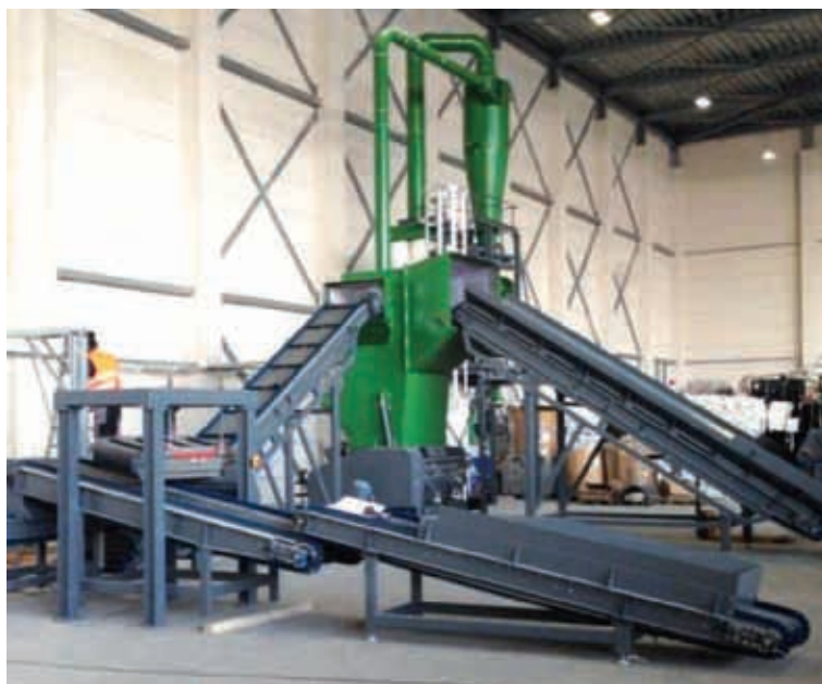
Комплексное решение для измельчения от Getecha: мощная дробилка S 6015 серии Roto-Schneider (зеленая) с периферийным оборудованием для подачи (серое) и циклонным сепаратором (зеленый) (все фото: Getecha GmbH)
