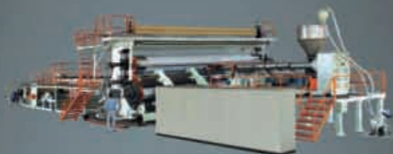
Extra-width Geomembrane/Waterproof Sheet Extrusion Line Широкая и высокая линия для производства геомембраны, водонепроницаемой пленки
