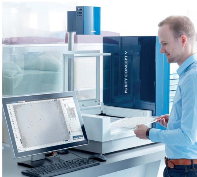
На выставке Fakuma впервые будет представлена система оптического контроля и анализа пластмассовых материалов в автономном режиме PURITY CONCEPT V
