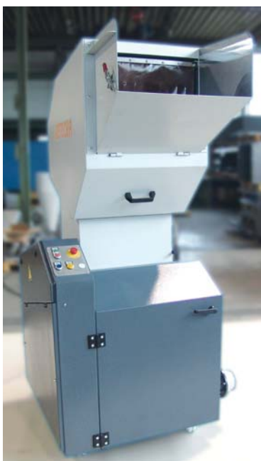
Дробилка RS 2404 B1 мощностью до 160 кг/ч оснащена воронкой, специально адаптированной для использования на предприятиях, занимающихся формованием раздувом
