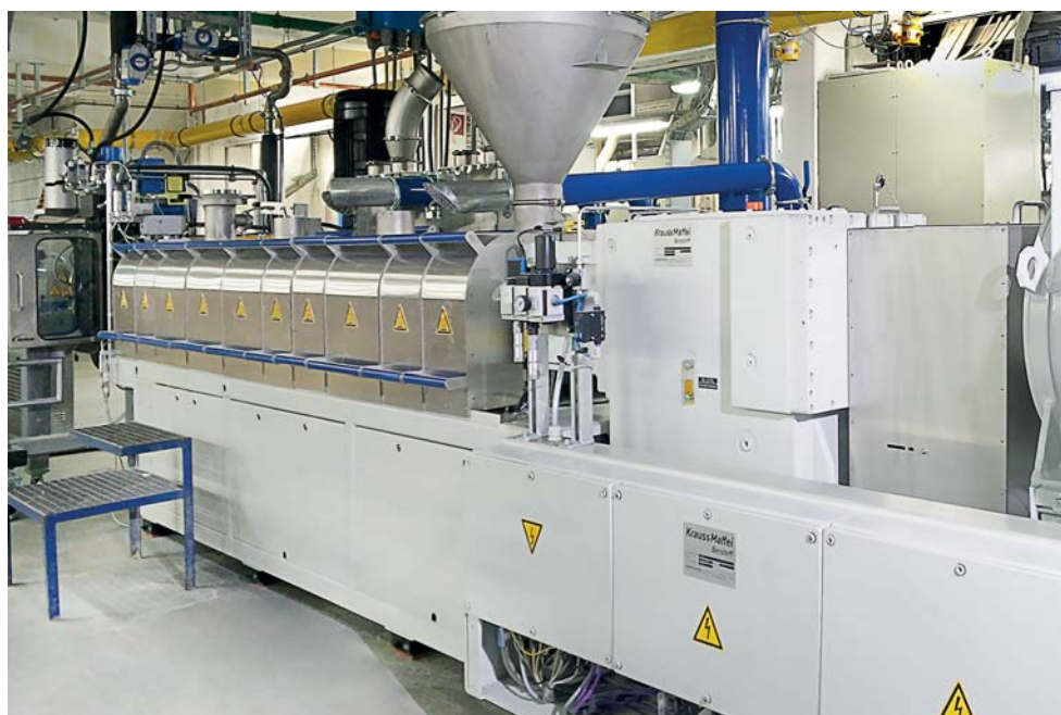
Новый двухшнековый экструдер ZE65x50D серии ZE BluePower от компании KraussMaffei Berstorff на предприятии PolyComp
