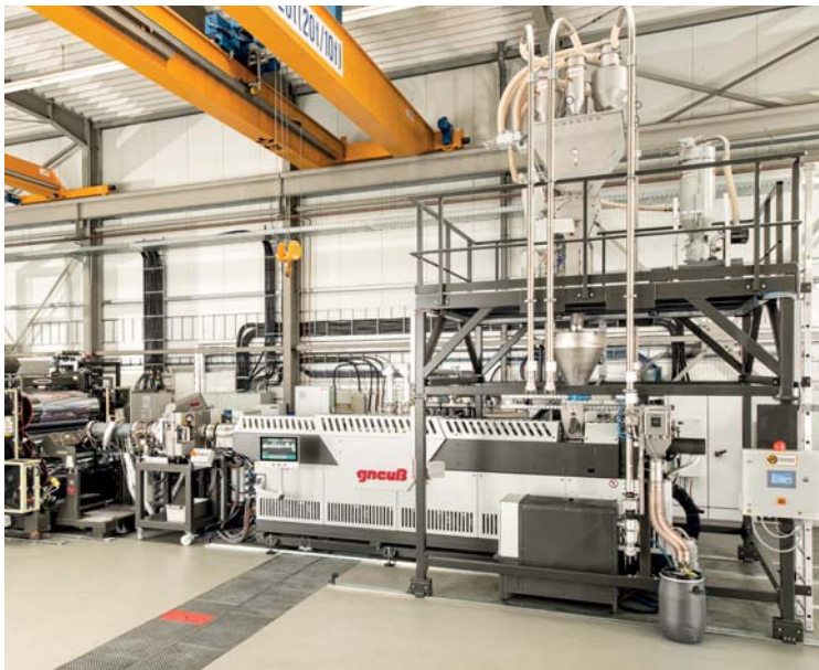
Экструзионная линия для производства пленки с экструдером MRS, ротационной системой фильтрации RSFgenius и встроенным в линию вискозиметром VIS
