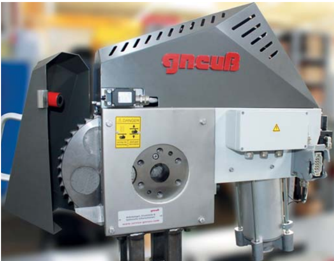
Ротационная система фильтрации KF 150 для непрерывной работы с частой сменой материала
