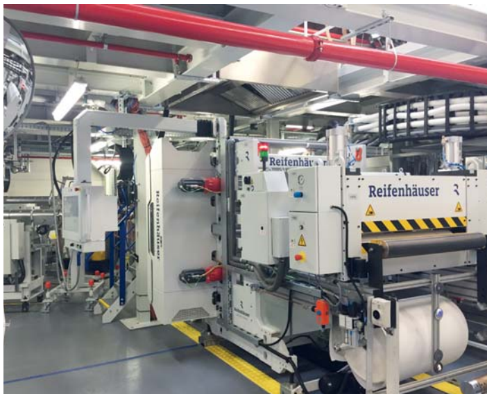
Каландр MIREX-MT фирмы Reifenhäuser Cast Sheet Coating с мехатронной системой управления валками, предназначенный для производства барьерных пленок (фото: RPC Bebo Plastik)
