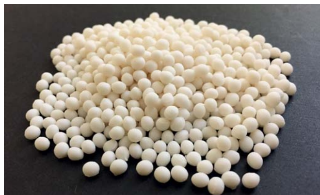
Пероксидные мастербатчи не имеют цвета, сертифицированы согласно ISO 9001:2008, могут храниться в течение нескольких лет и легко смешиваются с полиэтиленом всех известных на рынке марок (фото: Polyvel Europe)
