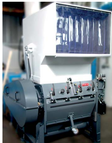
Мощная и тихая: одной из новинок на стенде фирмы Getecha станет центральная дробилка 45090 производительностью до 900 кг/ч
