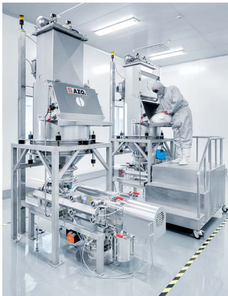
Удобная в очистке вихревая просеивающая машина типа DA с вытягивающими устройствами
