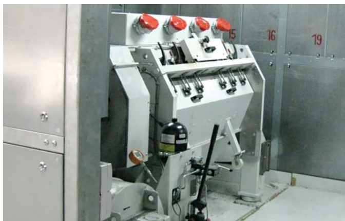
Мельница в звукоизолирующей кабине: мельница RotoSchneider RS 6015 эффективно измельчает остатки полипропилена в пригодные для экструдирования частицы. Вместо воронки для загрузки материала сверху в мельнице, сконструированной для предприятия Infinex, используется простая горизонтальная подача панелей и планок (фото: Stoecker)
