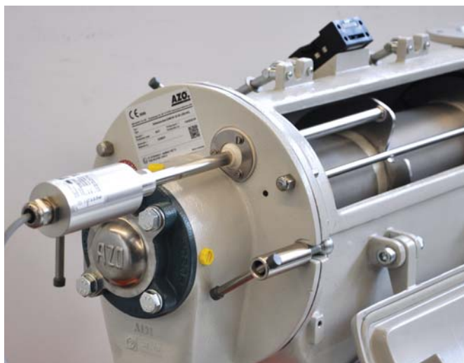
Вихревая просеивающая машина типа ЕЗ60 с ультразвуковым просеиванием
