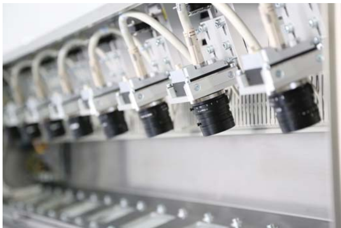
За качеством тканых материалов тщательно следят масштабируемые мультикамерные датчики Hybrid Power
