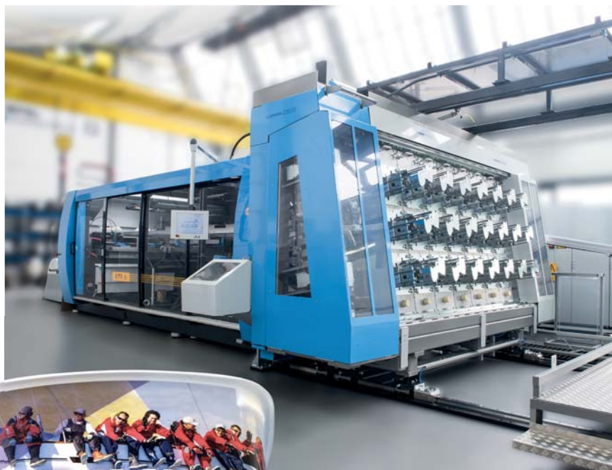
Пневматическая формовочная машина KTR 6.1 T-IML: стаканчики и этикетки могут иметь любую форму
