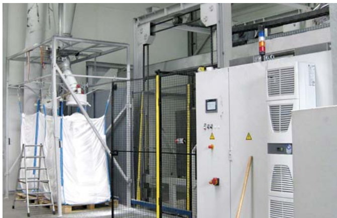
Трехступенчатая система переработки: комплексная система Getecha, разработанная для предприятия Infinex, включает оборудование для подачи с системами подъема и транспортировки, систему измельчения с центральной мельницей типа RotoSchneider RS 6015 и систему транспортировки измельченного материала на станцию загрузки двух биг-бэгов (слева). За управление всем процессом отвечает ПЛК Siemens SPS S7 (справа) (фото: Stoecker)
