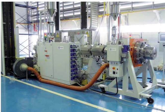
Серия VEGA — результат многолетнего опыта изготовления экструдеров и непрерывной работы над их компонентами. Постоянно совершенствуемая конструкция шнека и прямая литниковая втулка с водяным охлаждением обеспечивают превосходные производственные показатели и оптимальную пластикацию даже при высоких объемах выпуска.
