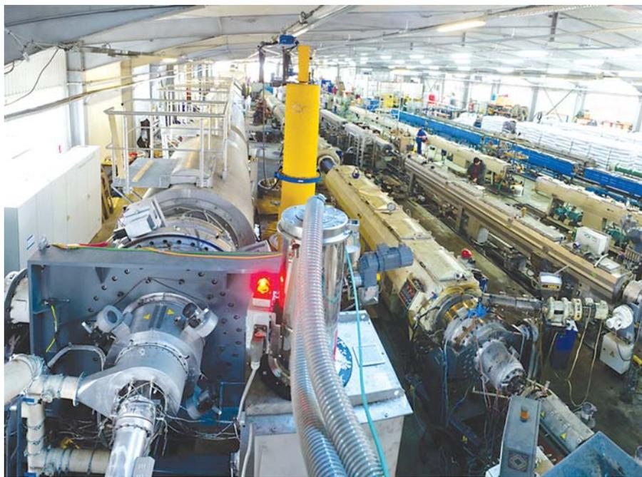
Общий вид производственного цеха компании Tehno World с линией battenfeld-cincinnati для экструзии труб диаметром 1,2 м (слева)
