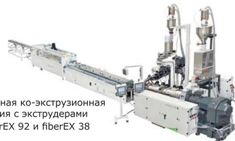
Полная ко-экструзионная линия с экструдерами fiberEX 92 и fiberEX 38
