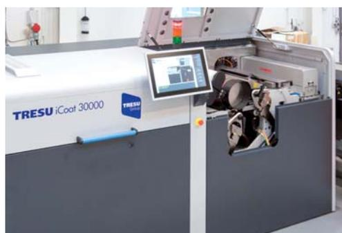
Лакировочный модуль TRESU iCoat 30000 формата B2, оснащенный коронаторами VE1A-J производства Vetaphone
