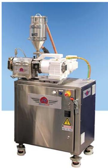
Модульный микроэкструдер American Kuhne с диаметром шнека 12 мм
