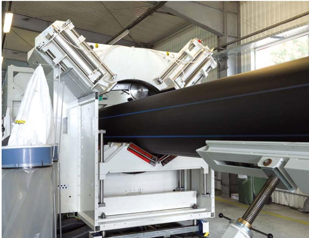
*Отрезная пила cutStream PTA 1200 способна отрезать трубы по размеру как без снятия стружки, так и со снятием (все фото © Tehno World)*
