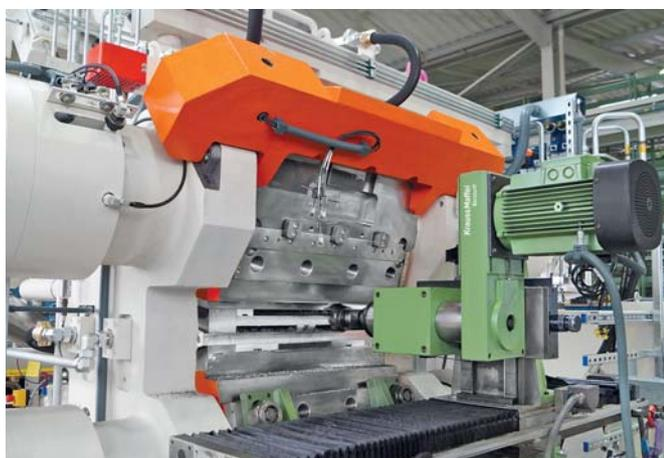
Мобильный фрезерный комплекс от KraussMaffei Berstorff для прецизионной обработки экструзионных головок Multiplex
