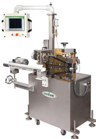
Устройство для вытягивания и резки MedLine® фирмы Conair
