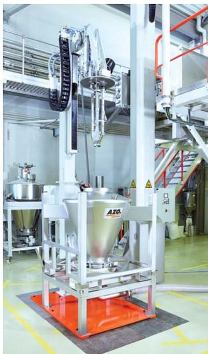
ствах, где действуют строгие требования к гигиене. Продукты могут подаваться из мешков, коробок, бочек или иной подобной тары. Чтобы избежать образования пыли при опорожнении мешков, можно подключить систему аспирации, которая будет запускаться при открытии крышки загрузочной воронки. Выключатель крышки обеспечивает эффективность защиты до уровня D.
