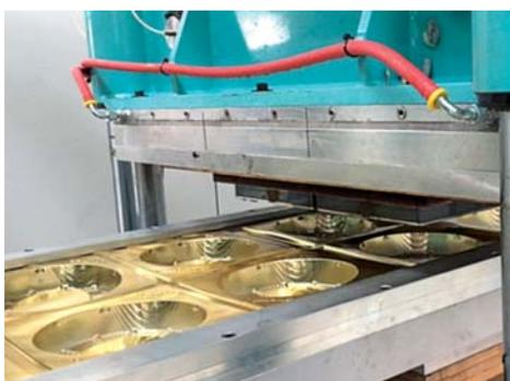
Станции формования на четырех колоннах имеют усилие смыкания 24 000 кг (в верхней части пресс-формы предусмотрена направляющая втулка с сервоуправлением), его можно увеличить до 60 000 кг, если требуется вырубка в пресс-форме.
