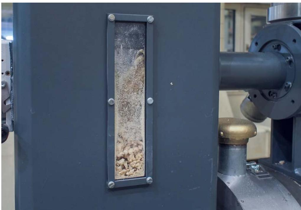
*Агломерат экономично компаундировался в горяче-холодном смесителе, после чего за счет гидростатического давления материал вводился в экструдер (на фото показана заправочная насадка во время эксплуатации, наполовину заполненная агломератом ДПК)*
