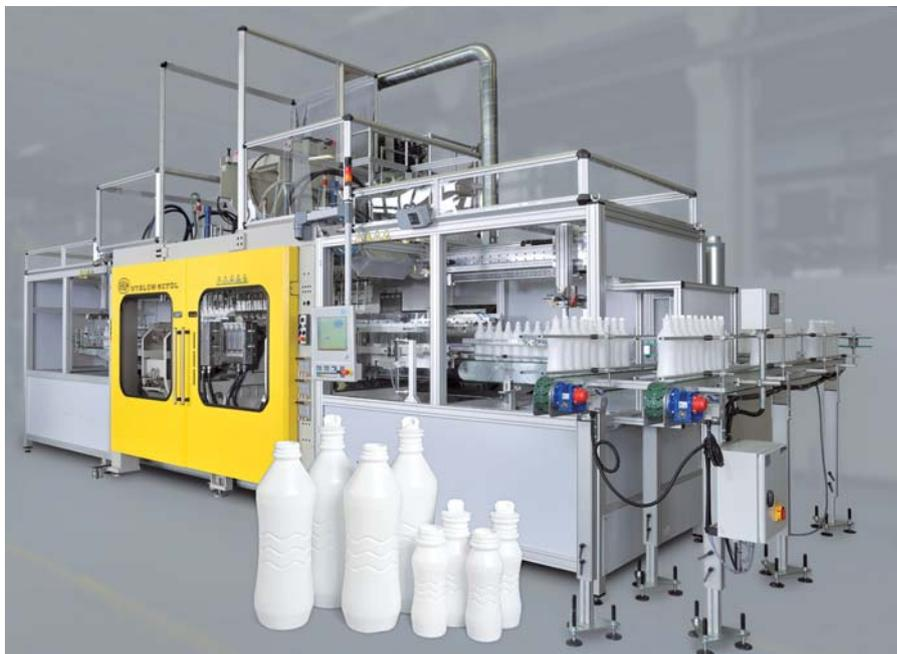
Установка HYBLOW 607 DL по производству упаковок для молочной продукции объемом 1000 мл в 9-местной форме
