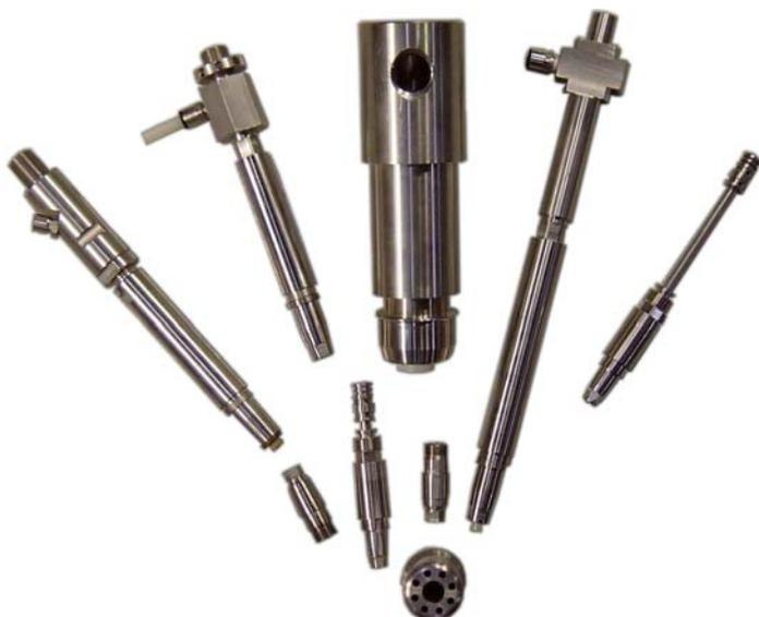
Раздувные дорны и раздувные иглы должны быть сконструированы таким образом, чтобы, с одной стороны, обеспечить формирование изделия при максимальном давлении, определенном для технологического процесса, а с другой стороны, обеспечить обмен охлажденного воздуха внутри изделия. Для этого FarragTech использует соответствующим образом подобранные клапанные блоки
