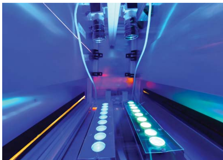
Оптическая измерительная система для контроля толщины слоя и сшивания органических покрытий на производственной линии (©фото: Fraunhofer IVV)
