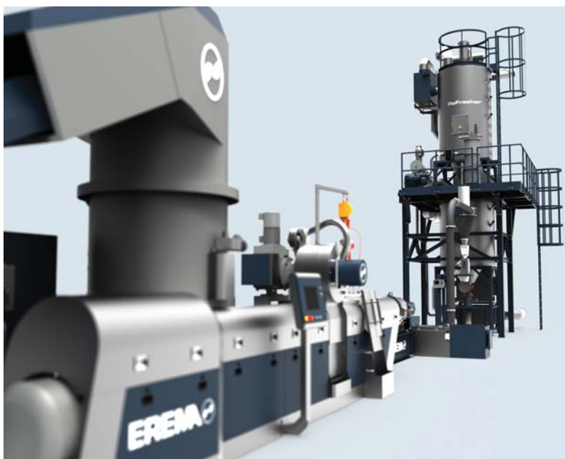
Комбинация установки ReFresher и хорошо известной технологии впервые позволяет получить даже из сильно загрязненных использованных упаковок регранулят без запаха (фото: EREMA)
