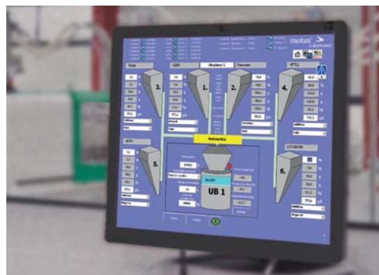
Информационная система Linknet с графическим пользовательским интерфейсом, который наглядно представляет все важные параметры, помогает персоналу управлять установкой и контролировать ее работу. Интерфейс обеспечивает возможность дальнейшей обработки собранных и архивных данных
