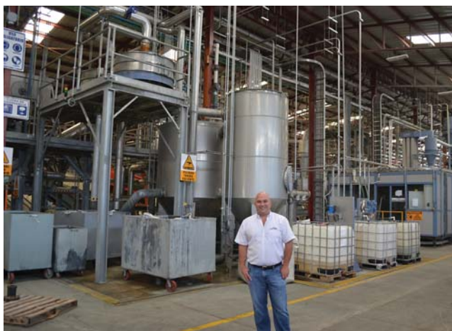
Установка компании Herbold Meckesheim для горячей промывки хлопьев, полученных из пластиковых бутылок, обеспечит высокое качество регранулята
