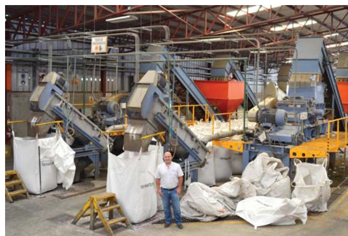
После сортировки пластиковые бутылки измельчаются в двух ножевых дробилках компании Herbold Meckesheim, производительность которых составляет 1800 кг/ч
