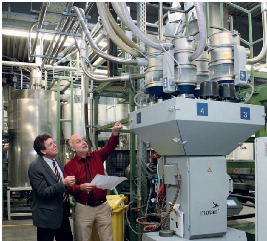
Совместная работа над снабжением материалами на производстве обвязочных ПЭТ лент фирмы Суклор: Георг Флинк (слева) и Бернд Кауземан рядом с устройством дозирования и смешивания Gravicolor 600 с четырьмя дозаторами для гранулята, хлопьев, красителей и мастербатчей (все фото: Motan-Colortronic)
