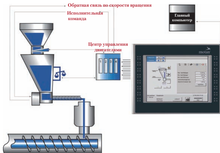
Блок-схема дифференциального дозирования. Определение потери веса (Loss-in-weight) в резервуаре дозирующего устройства осуществляется в режиме реального времени с помощью весовой ячейки с очень короткими интервалами времени (фото: motan-colortronic)
