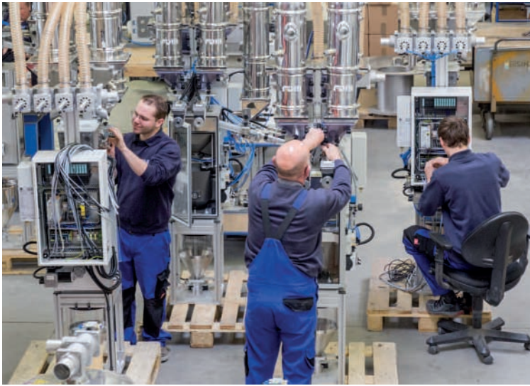
Сборочный цех фирмы FDM в Тройсдорфе. Здесь собирают и испытывают дозаторы для разных сфер производства (трубы, упаковочные пленки, листы, медицинская продукция и т. д.) перед отправкой клиентам
