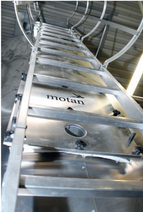
Чтобы обеспечить максимальную производительность, на одной из линий был установлен сушильный бункер объемом 7500 л
