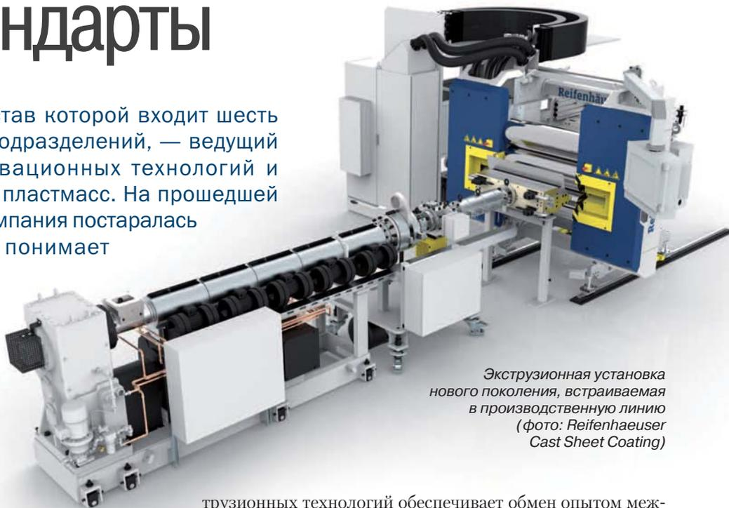
Экструзионная установка нового поколения, встраиваемая в производственную линию (фото: Reifenhäuser Cast Sheet Coating)
