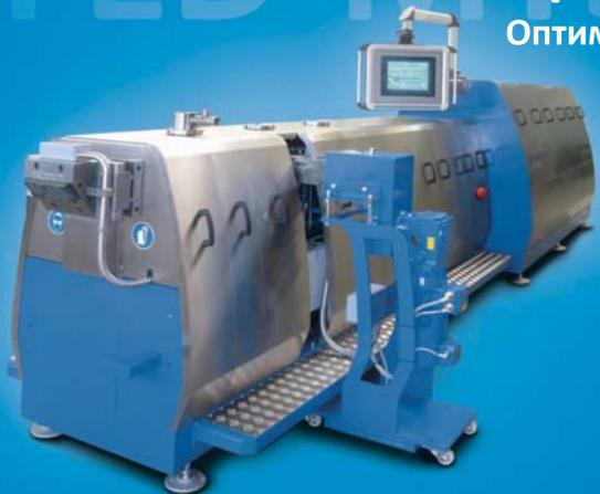
Уникальная геометрия шнековых элементов экструдера FED-MTS обеспечивает достаточное время пребывания для привнесения необходимой энергии без локального перегрева массы.
