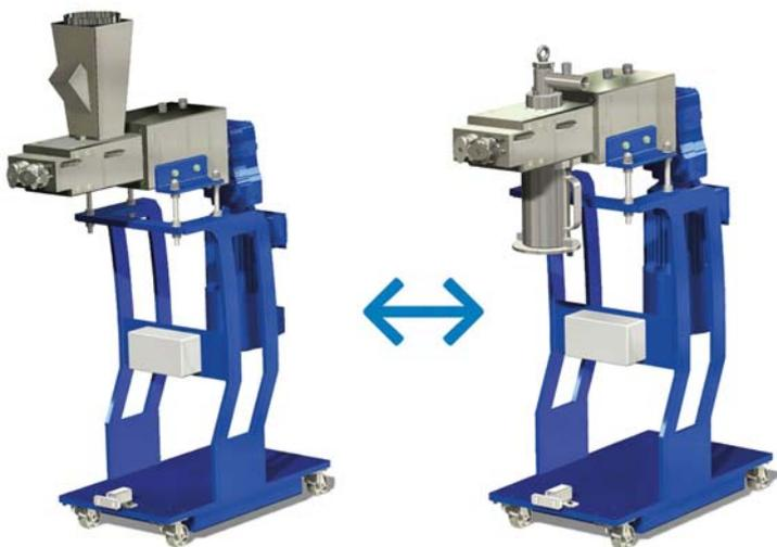
Рис. 2. Перенастройка бокового питателя на выполнение процесса дегазации возможна с минимальными усилиями
