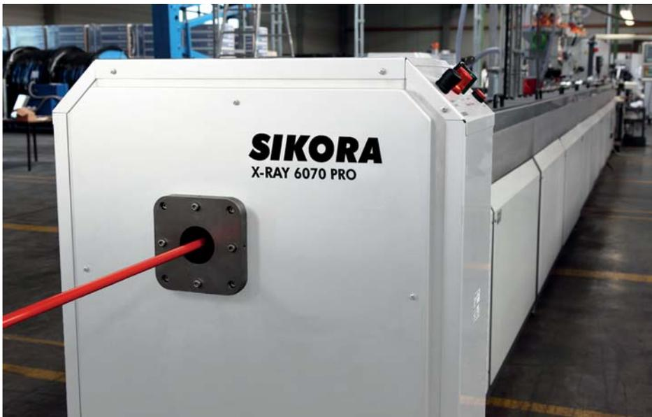
Рис. 4. Рентгеновская система, установленная на линии экструзии шлангов, и экран с технологическими данными
