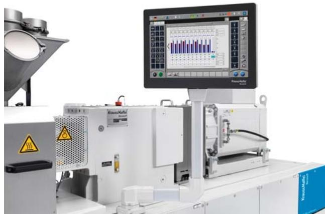
С октября 2016 года двухшнековые экструдеры серий ZE BluePower, ZE UTX и ZE Basic оснащаются новой системой управления VPCTouch
