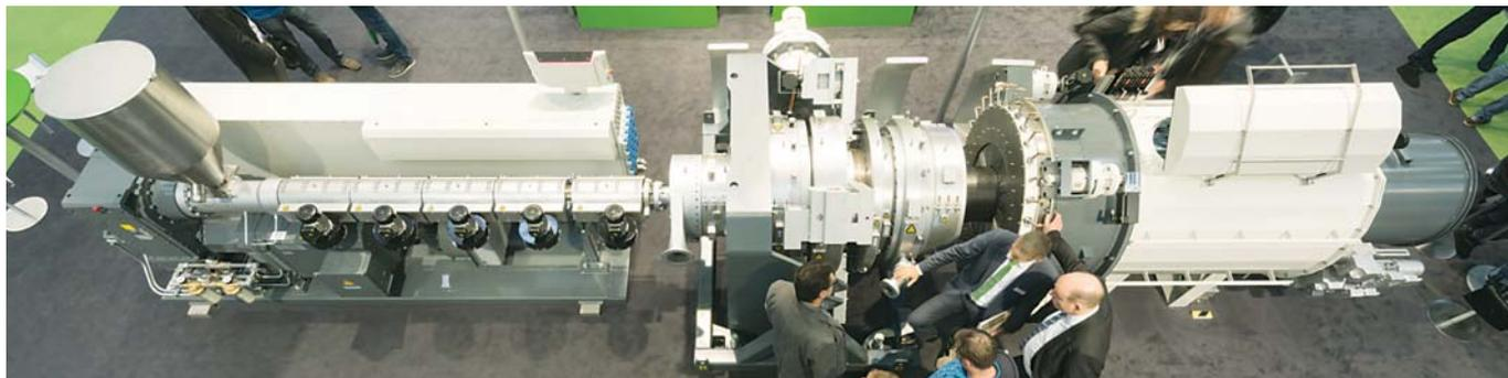
Экструдер conEX NG оснащен удлиненной зоной нагрева и оптимальной геометрией шнека, что обеспечивает более высокую производительность. Новая концепция геометрии минимизирует износ и позволяет перерабатывать множество материалов одним шнеком. Установка эксплуатируется при непрерывном технологическом давлении до 520 бар. В силу низкого энергозатрата и компактности экструдер conEX NG также отлично подходит и для соэкструзии.
