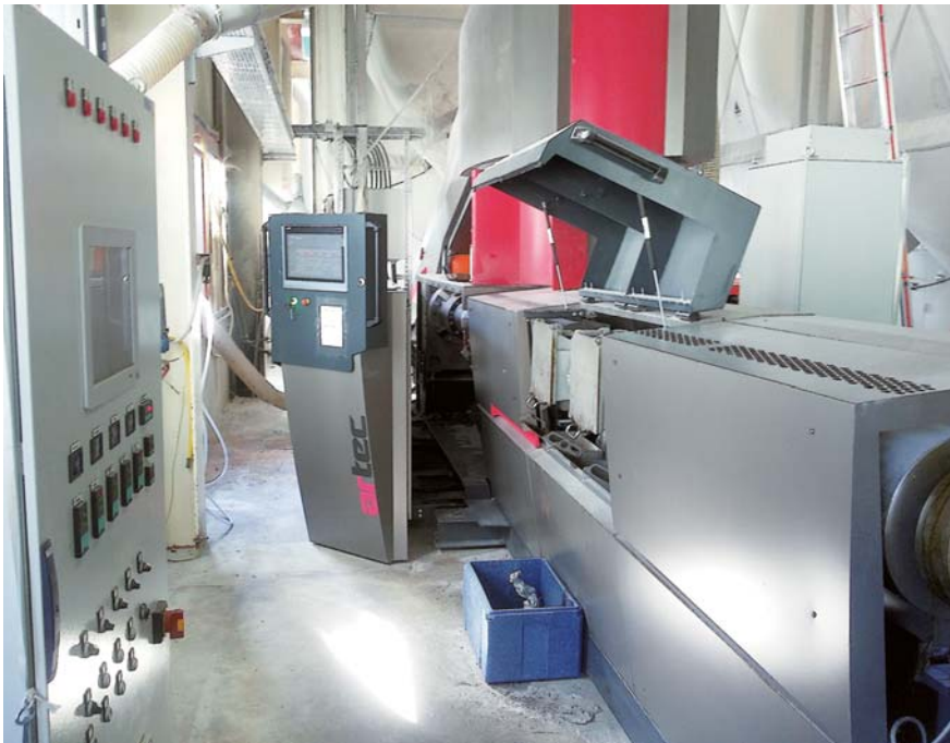
Рис. 4. Экструзионный модуль оснащен эффективным узлом двойной дегазации. Регулируемый по высоте дисплей системы управления предназначен для централизованной настройки и контроля всех функций линии. Также предусмотрена возможность дистанционного контроля и технического обслуживания через Интернет (фото: ARTEC)
