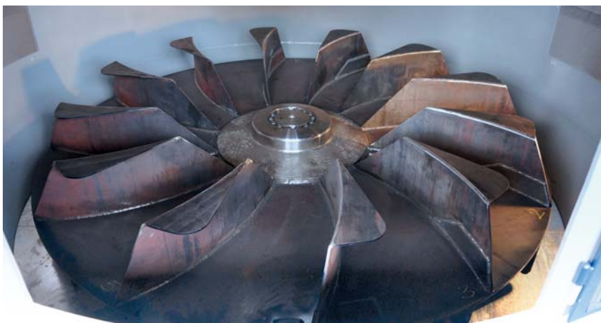
Рис. 2. Центральный компонент системы DRD – двойной ротор. Внизу находится сторона всасывания исходного материала (не видна на снимке) (фото: Р. Бауэр)
