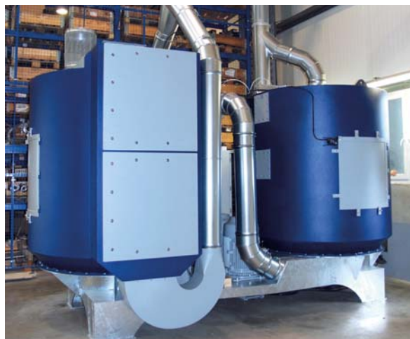
Рис. 7. Двухступенчатая установка DRD 21 DS. Слева – первая ступень очистки с нагревательной печью, справа – вторая ступень без средств подогрева воздуха (фото: MAS)
