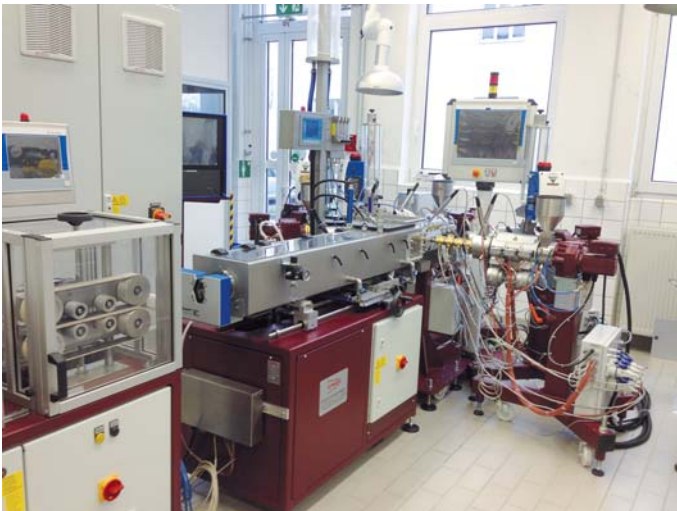
Узел съема и резки с устройством для транспортировки и сброса изделий
