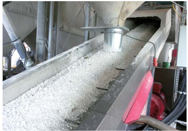
Рис. 3. Конвейер подает подготовленные хлопья вспенивающегося полистирола в компактор-измельчитель, где из них удаляется влага (фото: ARTEC)
