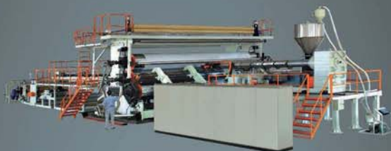
Extra-width Geomembrane/Waterproof Sheet Extrusion Line Широкие геомембраны/ Экструзионная линия по производству листов для гидроизоляции
