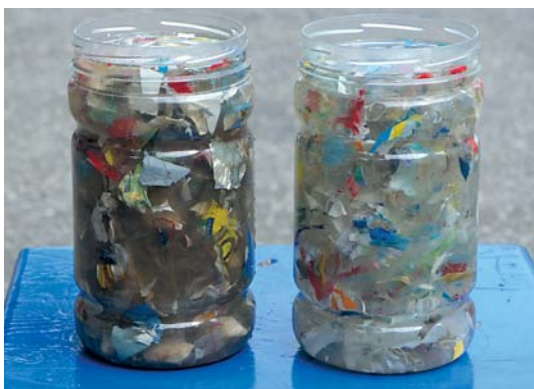
Рис. 6. Загрязненные (слева) и очищенные пленочные хлопья (для наглядности помещены в воду) (фото: Р. Бауэр)
