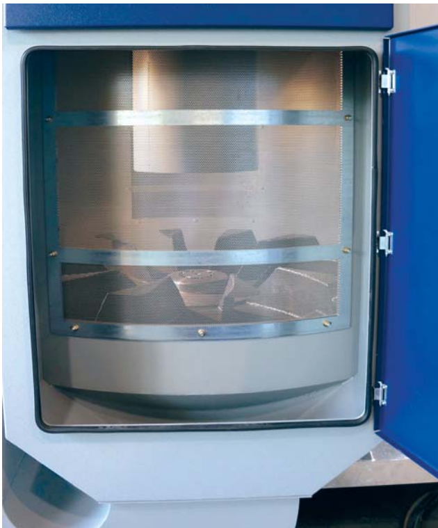
Рис. 4. Вид на камеру центрифуги системы DRD 26 через боковое сито. Внизу двойная роторная система с 12 лопатками, над ней корпус нагревательной печи (фото: Р. Бауэр)
