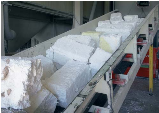
Рис. 2. Отходы из вспенивающегося полистирола прессуются в тюки и блоки, это упрощает транспортировку. Перед переработкой их измельчают до однородной фракции (фото: ARTEC)
