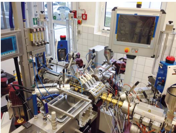
Расположение экструдеров и 6-слойной головки с системой управления EC 307/19"
