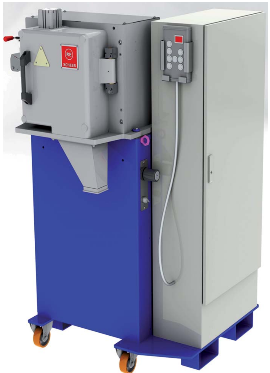
Рис. 1: Новые консольные грануляторы SGS 100- E6 (с производительностью макс. 20 стренг или 550 кг/ч) (фото: REDUCTION ENGINEERING-Scheer)
