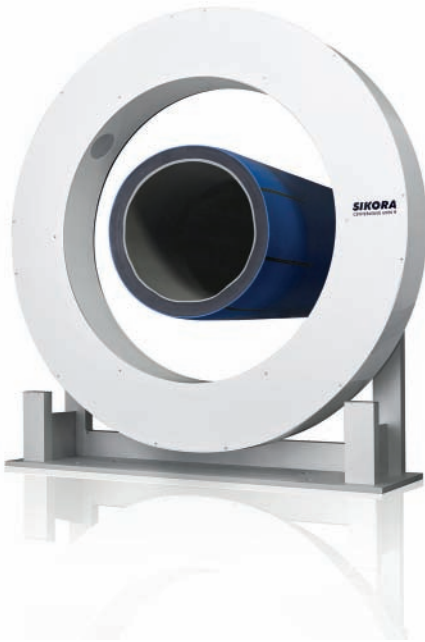
图 5：采用毫米波技术的测量系统，用于反射信号时间差测量物体外径、壁厚和下垂度的毫米波技术
